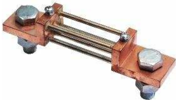
Рисунок 3.4 — Шунт В6 с номинальным током до 15кА и падением напряжения 100 мВ
