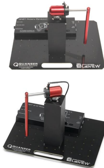
Геометрическая модель маятника Лабораторный стенд с маятником Фуруты Quanser QNET Rotary Inverted Pendulum 2.0
