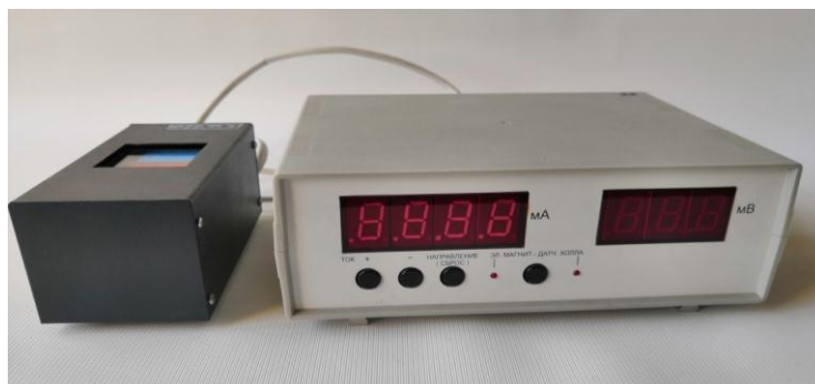
Рисунок 3 – Внешний вид установки для изучения эффекта Холла в полупроводниках ФПК-08 (слева - блок электромагнита с датчиком Холла, справа - устройство измерительное)
