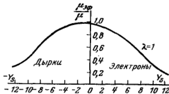
Рисунок 2 – График зависимости подвижности носителей заряда в слое пространственного заряда от поверхностного электростатического потенциала в случае полного диффузного рассеяния
