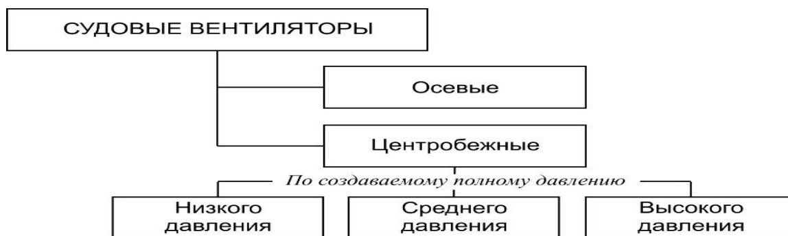
Рис. 13. Классификация судовых вентиляторов
