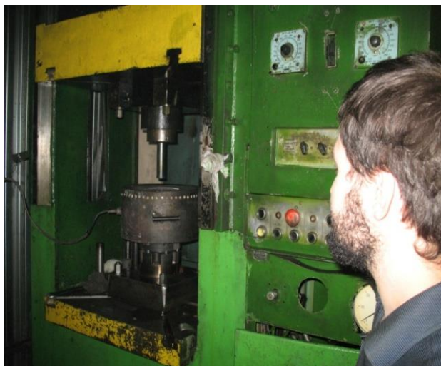
Рис. 2. Горячее прессование (экструзия) брикетов в ленту на прессе ДБ 2432 с установленной на нем пресс-оснасткой с кольцевой печью
