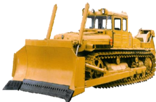
Рис. 1. Бульдозерно-рыхлительный агрегат ДЭТ-250М2 с двигателем типа 12Ч 15/18
