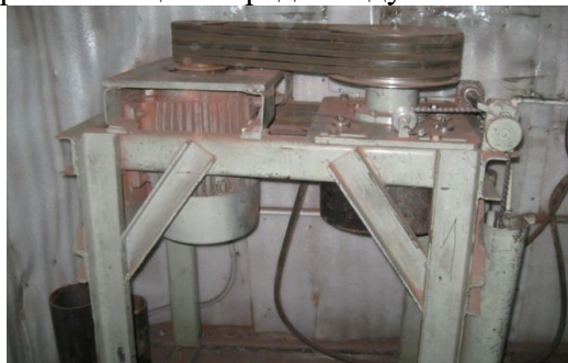
Рис.1. Промышленный аттритор с емкостью рабочей камеры 15 л, разработанный
