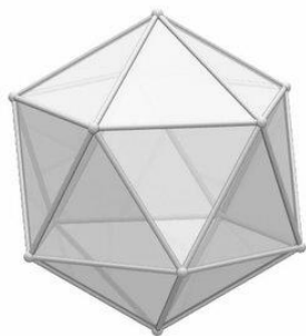
Рис.4. Структура элементарной ячейки квазикристалла (икосаэдр)
