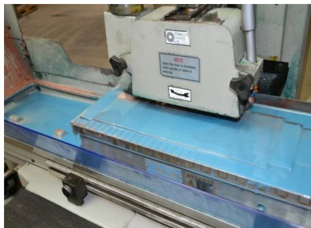
Рис. 3. Шлифование заготовок для контактодержателей из медных наноструктурных материалов на плоскошлифовальном станке с ЧПУ модели Seedtec 52 и с использованием СОЖ
