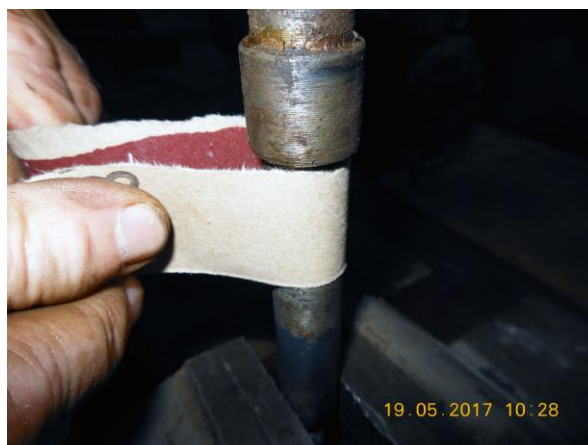
Рисунок В.5 – Шлифовка изношенного места приводного валика
