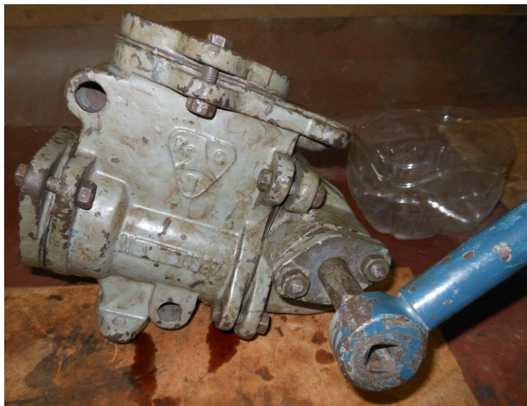
Рисунок Б.1 – Общий вид насоса типа БКФ-4
