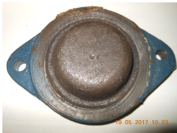
Рисунок В.10 – Осмотр уплотнительных поверхностей торца цилиндра и его крышки
