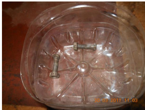
Рисунок Б.5 – Складывание крепежа при разборке насоса
