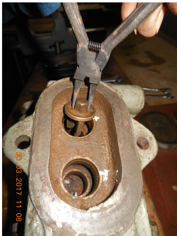
Рисунок Б.9 – Вынимание всасывающих клапанов
