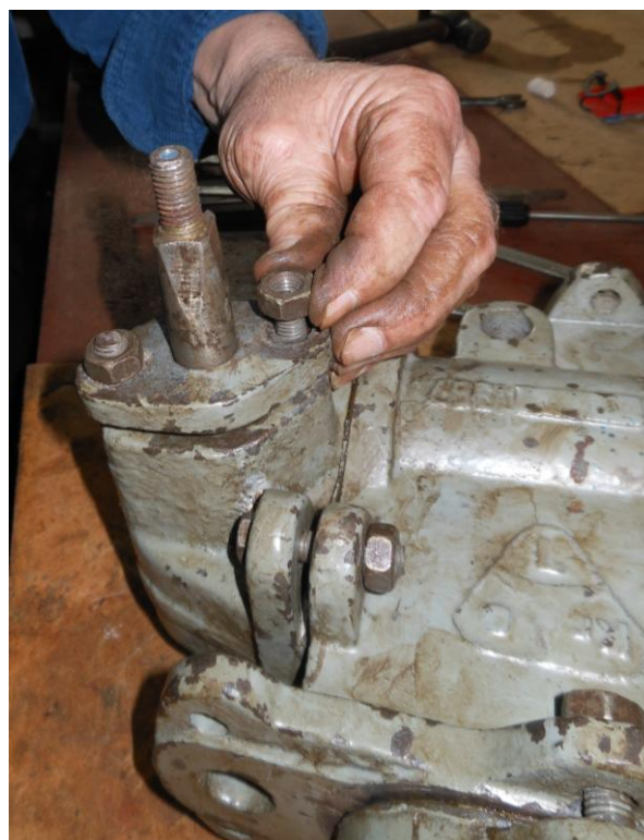
Рисунок Б.21 – Сборка сальникового уплотнения приводного валика
