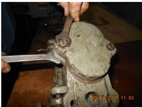
Рисунок Б.4 – Откручивание гаек крепления крышки клапанной коробки
