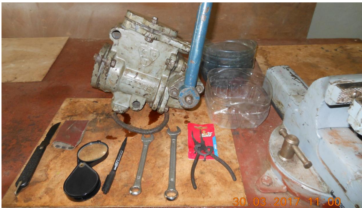
Рисунок 1 – Рабочие места для переборки ручного поршневого насоса типа БКФ-4 (окончание)
