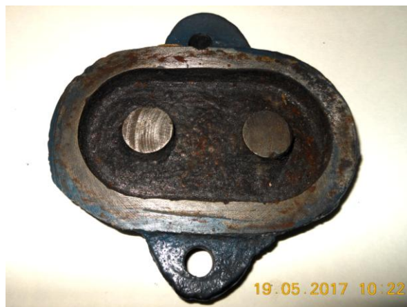
Рисунок В.8 – Осмотр уплотнительных поверхностей клапанной коробки и крышки
