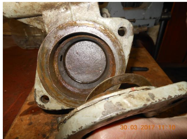
Рисунок Б.12 – Снятие крышки с прокладкой рабочего цилиндра
