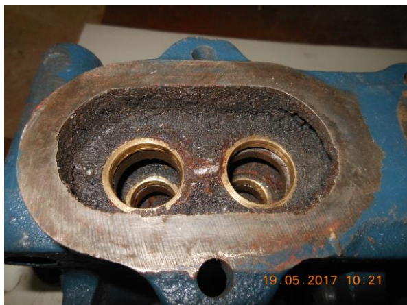
Рисунок В.8 – Осмотр уплотнительных поверхностей клапанной коробки и крышки
