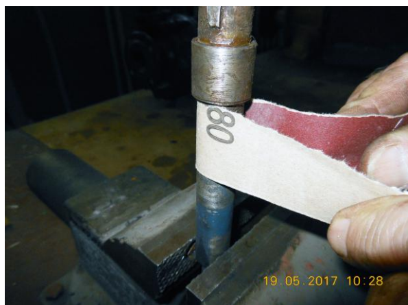
Рисунок В.5 – Шлифовка изношенного места приводного валика
