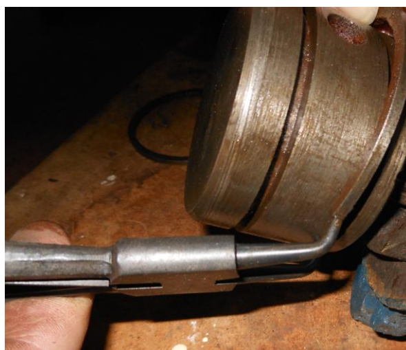
Рисунок Б.16 – Снятие колец с поршня
