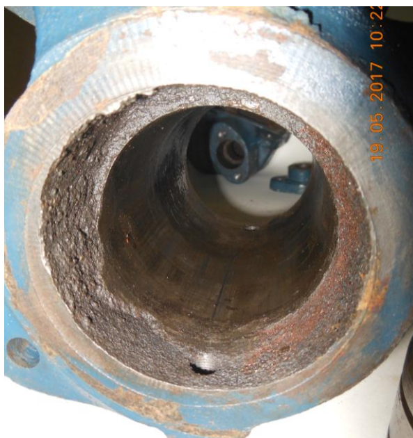
Рисунок В.10 – Осмотр уплотнительных поверхностей торца цилиндра и его крышки
