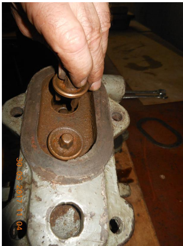
Рисунок Б.7 – Вынимание нагнетательных клапанов
