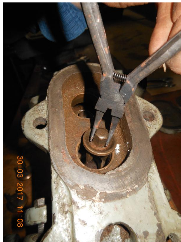
Рисунок Б.9 – Вынимание всасывающих клапанов
