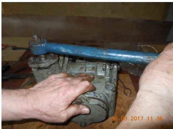
Рисунок Б.2 – Проверка легкости перемещения поршня в цилиндре
