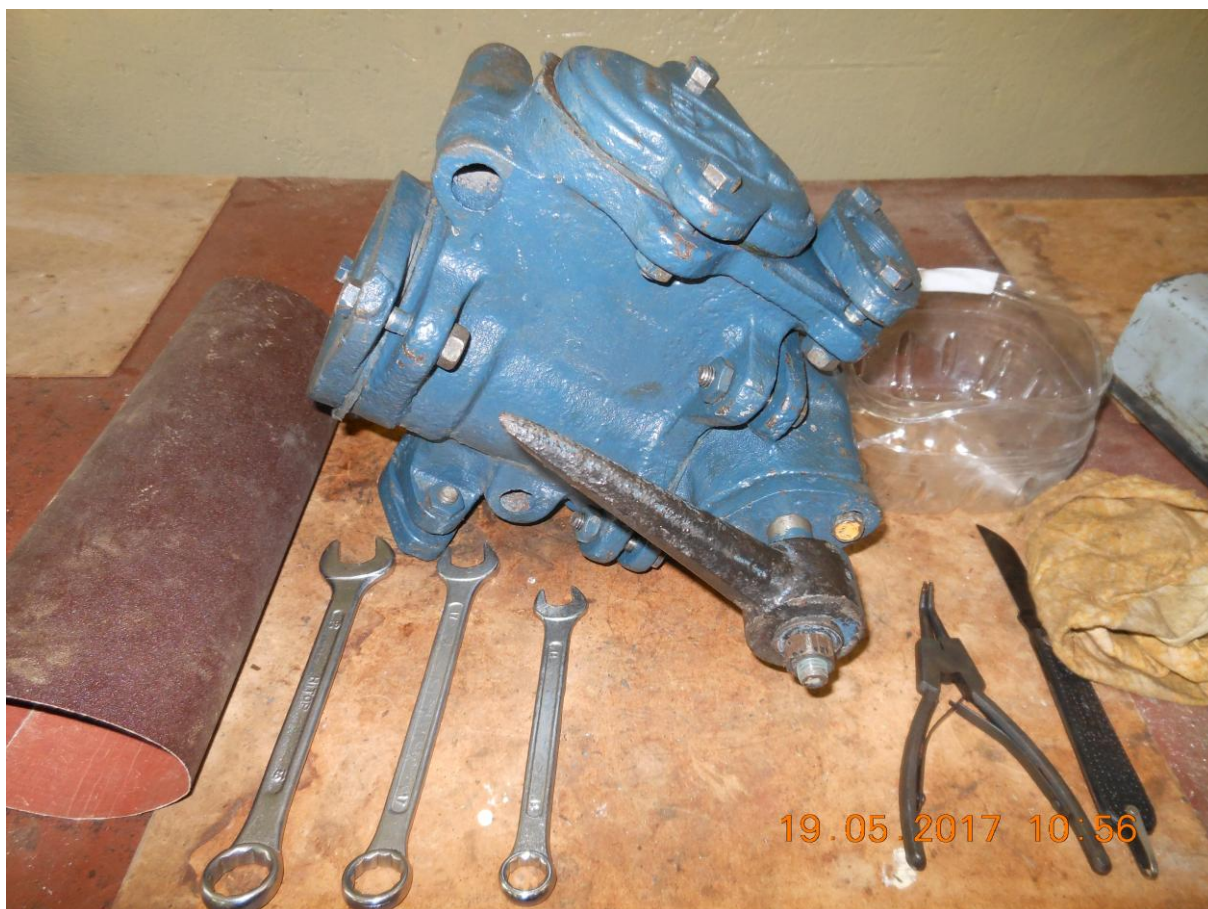
Рисунок 1 – Рабочие места для переборки ручного поршневого насоса типа БКФ-4 (продолжение на след. стр.)
