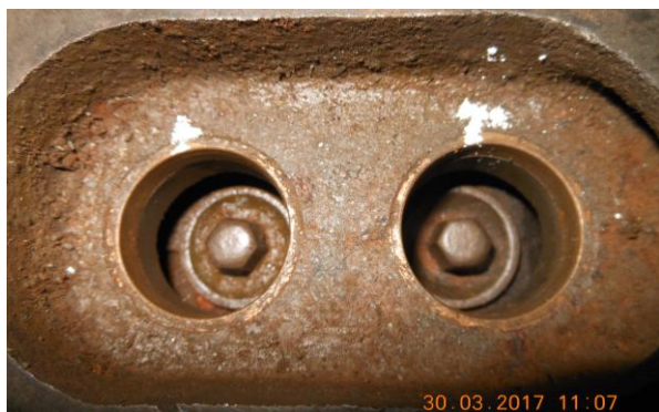
Рисунок Б.8 – Пример маркировки седел (а) и нагнетательных клапанов (б)
