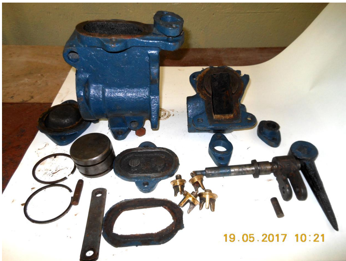
Рисунок Б.17 – Насос поршневой типа БКΦ-4 в разобранном виде
