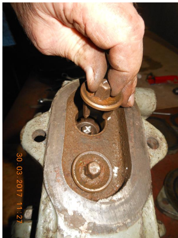
Установка нагнетательных клапанов
