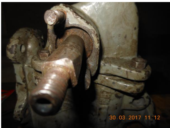
Рисунок Б.13 – Разборка сальникового уплотнения приводного валика
