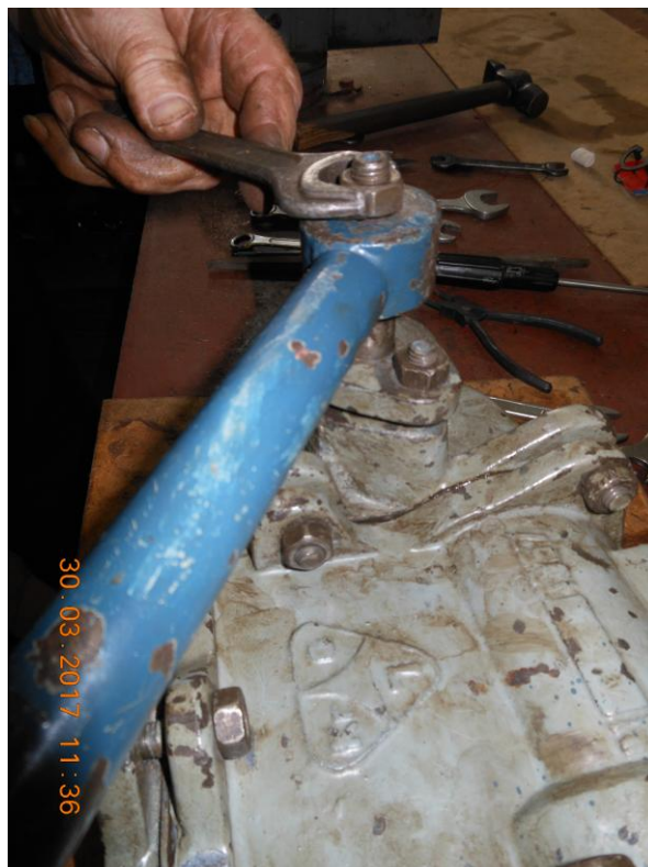
Рисунок Б.3 – Откручивание гайки крепления рукоятки насоса
