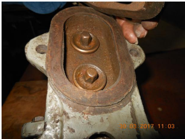
Рисунок Б.6 – Снятие крышки (а) и прокладки (б) клапанной коробки
