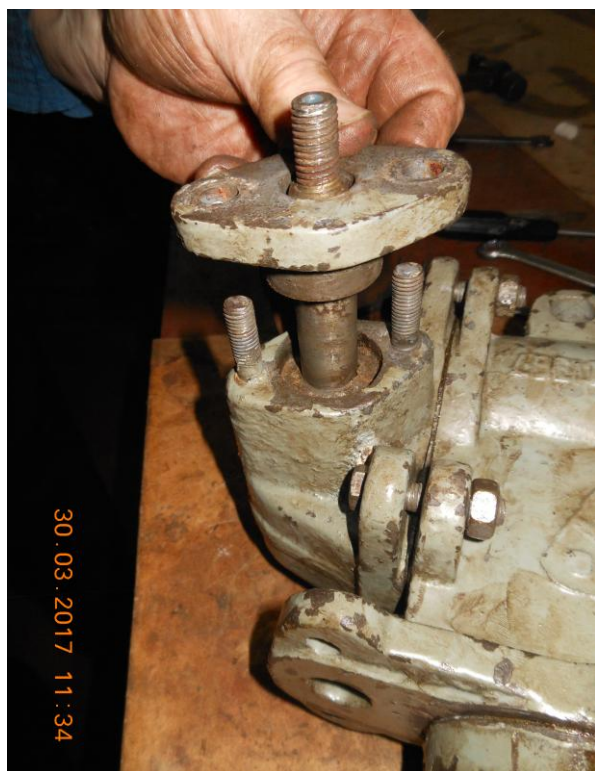
Рисунок Б.21 – Сборка сальникового уплотнения приводного валика
