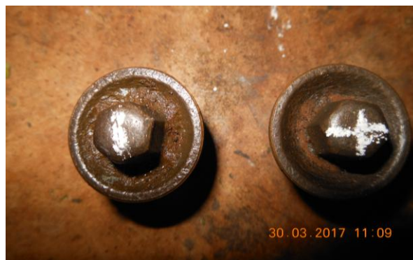
Рисунок Б.8 – Пример маркировки седел (а) и нагнетательных клапанов (б)
