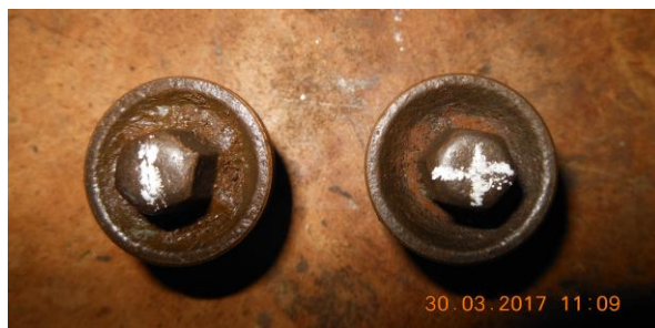
Рисунок Б.10 – Маркировка всасывающих клапанов
