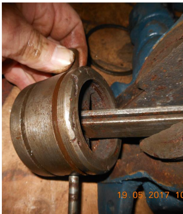
Разъединение поршня и стяжки
