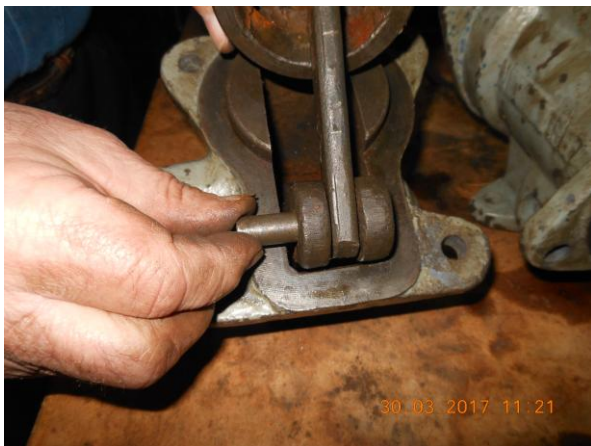
Соединение рычага со стяжкой
