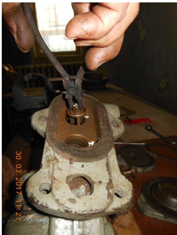
Установка всасывающих клапанов
