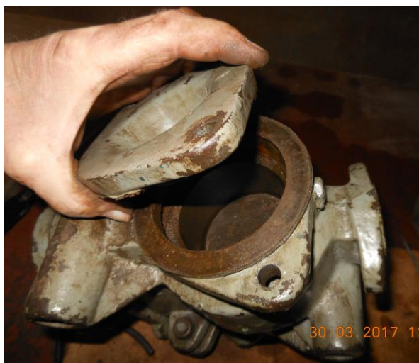
Рисунок Б.20 – Монтаж крышки рабочего цилиндра
