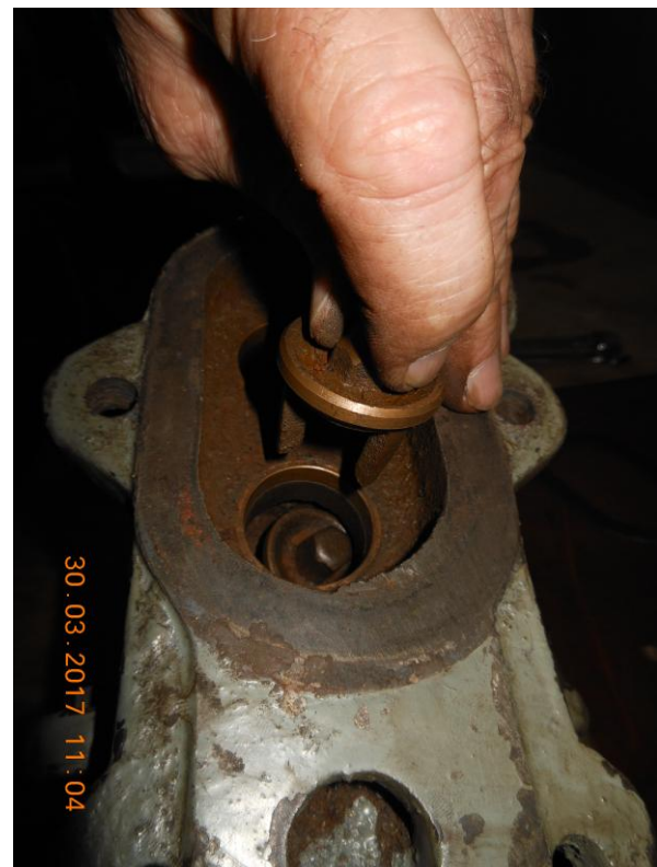
Рисунок Б.7 – Вынимание нагнетательных клапанов
