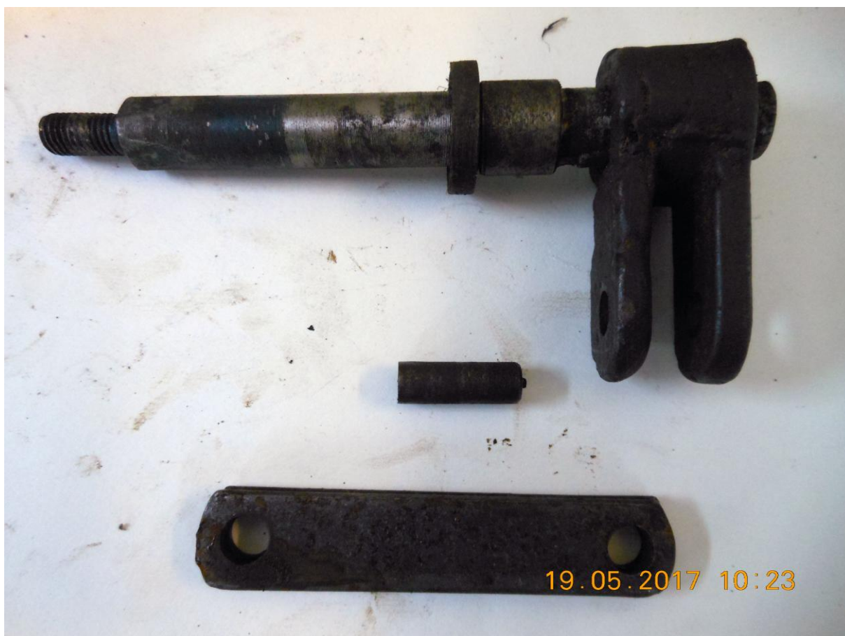
Рисунок В.4 – Осмотр деталей привода поршня (приводного валика, рычага, стяжки, пальца)
