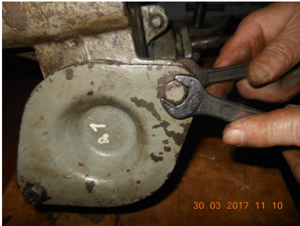
Рисунок Б.11 – Откручивание гаек крепления крышки рабочего цилиндра
