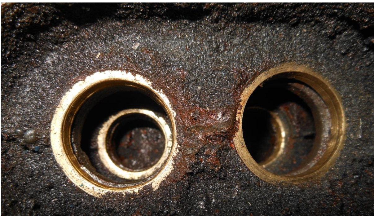
Рисунок В.2 – Осмотр седел нагнетательных и всасывающих клапанов
