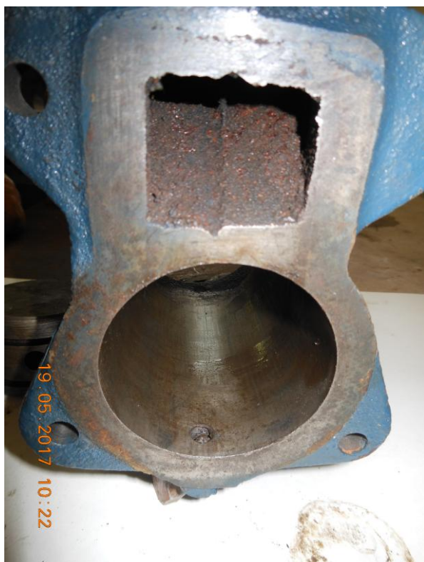
Рисунок В.11 – Осмотр сопрягаемых поверхностей корпуса насоса и корпуса привода поршня
