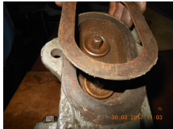
Рисунок Б.6 – Снятие крышки (а) и прокладки (б) клапанной коробки
