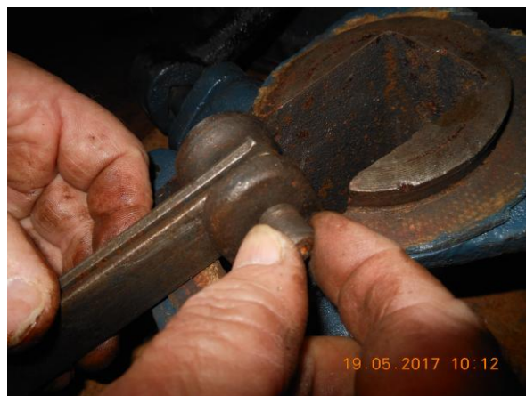
Разъединение стяжки и рычага
