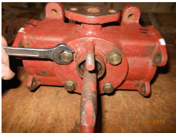
Рисунок Б.18 – Демонтаж фланца с приводным валиком
