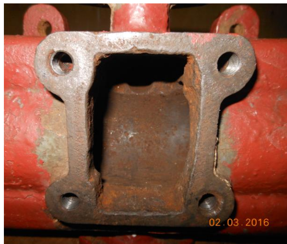
Рисунок В.21 – Осмотр уплотнительной поверхности корпуса, сопрягаемой с фланцем сальникового уплотнения
