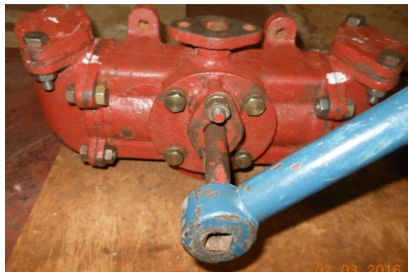
Рисунок Б.2 – Демонтаж рукоятки насоса
