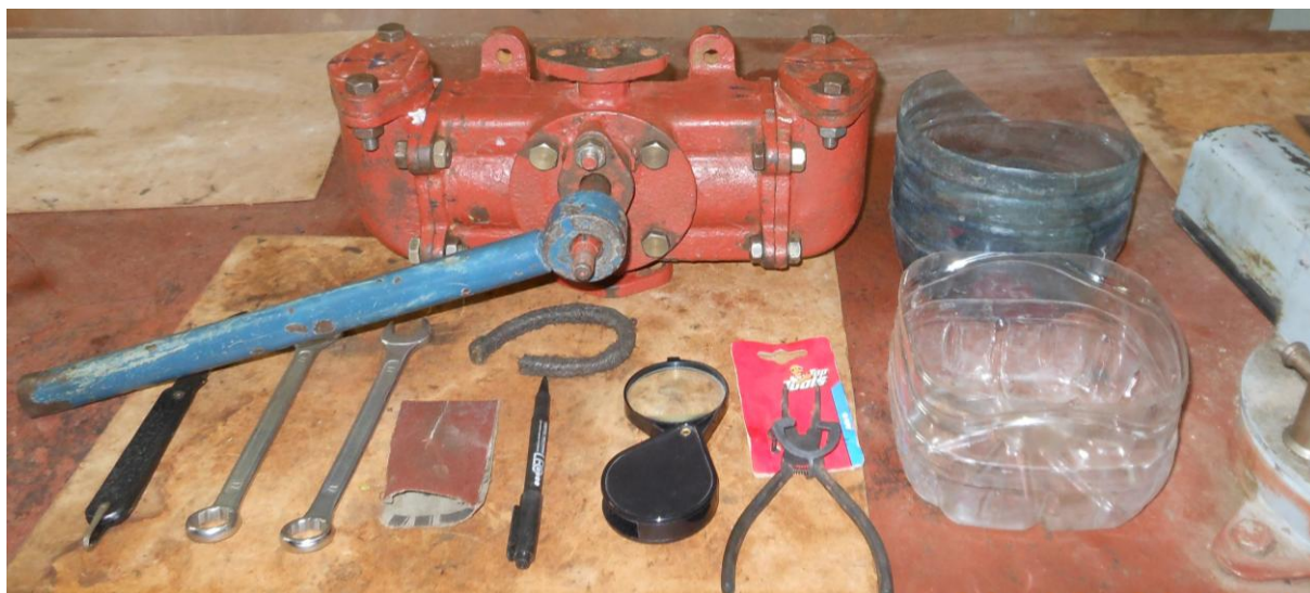
Рисунок 1 – Рабочее место для переборки ручного поршневого насоса типа НР 0,25/30
