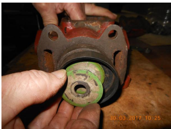
Рисунок Б.25 – Сборка на штоке поршня (правой стороны) насоса типа НР 0,25/30
