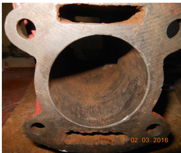
Рисунок В.20 – Осмотр уплотнительной поверхности корпуса, сопрягаемой с клапанной коробкой
