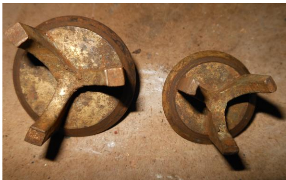
Рисунок В.1 – Осмотр тарелок всасывающего и нагнетательного клапанов (одной из клапанных коробок)
