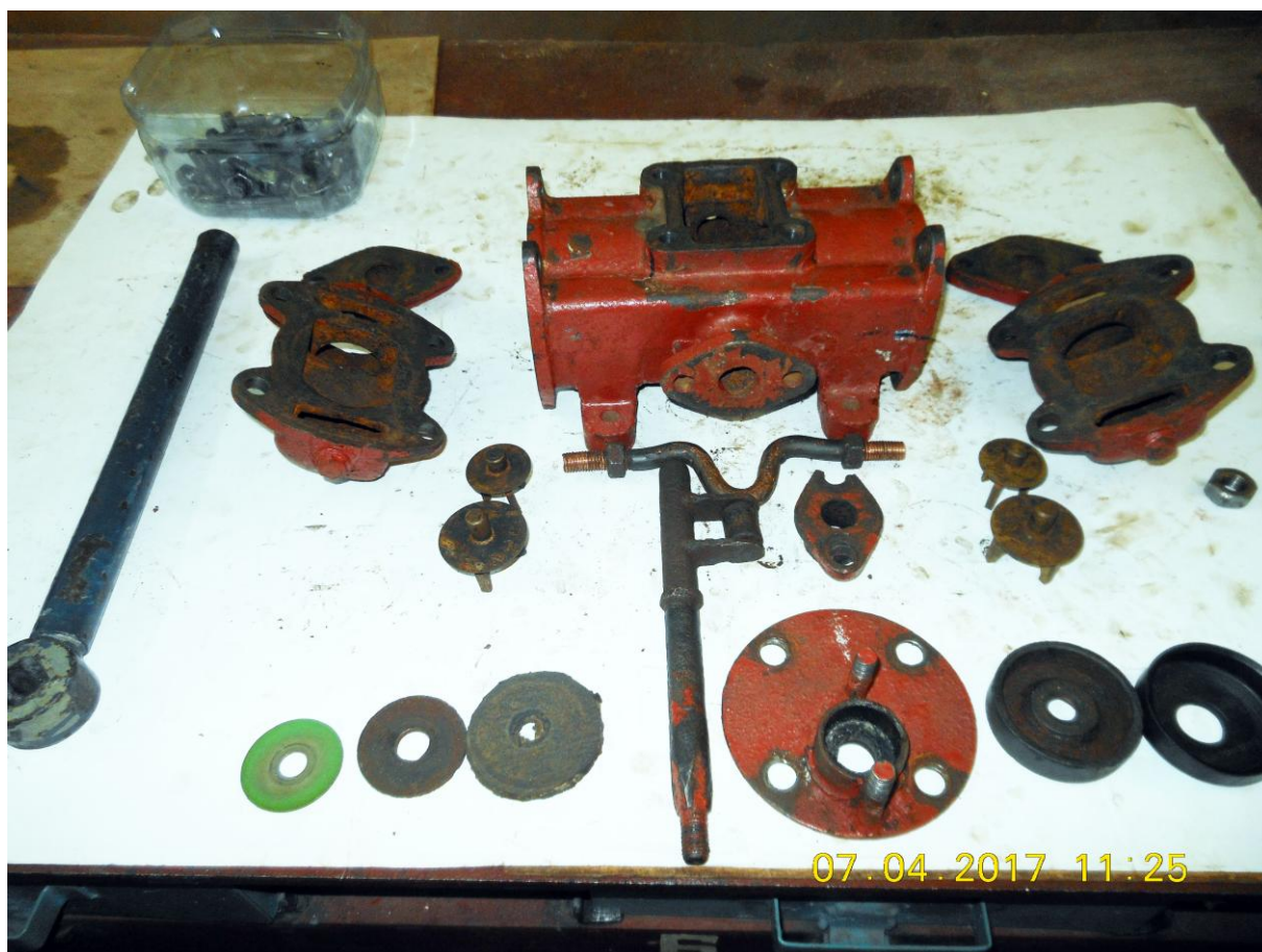
Рисунок Б.23 – Насос типа НР 0,25/30 в разобранном виде
