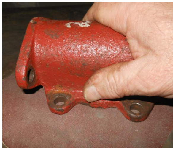
Рисунок В.9 – Шлифовка на плите уплотнительной поверхности клапанной коробки, сопрягаемой с корпусом насоса
