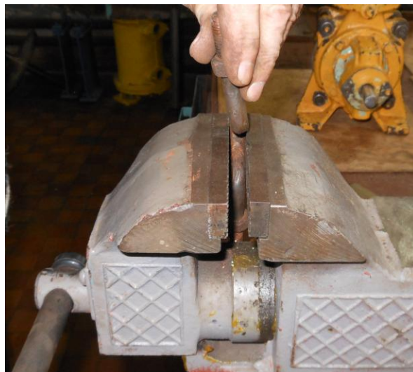
Рисунок В.13 – Правка поршневого штока в тисках
