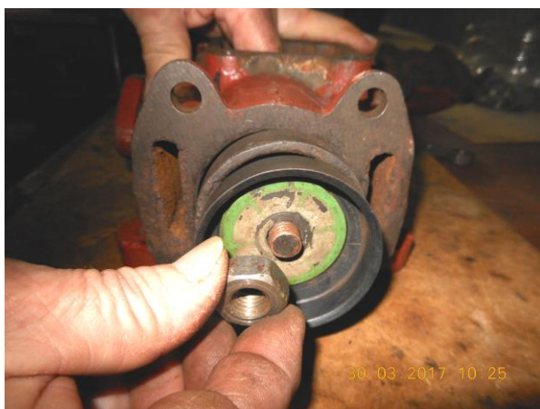
Откручивание и снятие гайки
