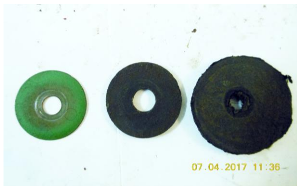
Рисунок В.10 – Осмотр деталей левой стороны поршня
