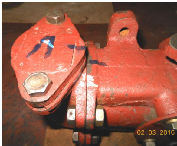
Рисунок Б.3 – Нанесение меток на корпусе и клапанных коробках насоса
