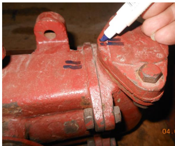
Рисунок Б.3 – Нанесение меток на корпусе и клапанных коробках насоса
