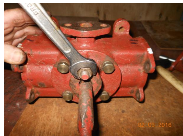
Установка и обжатие нажимной втулки сальника
