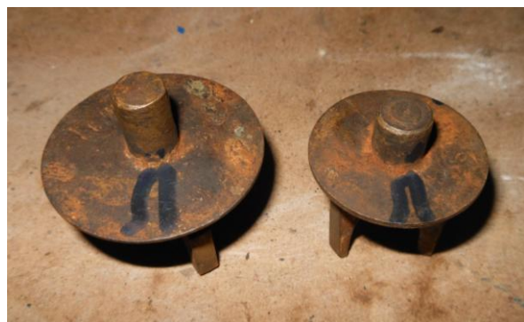
Рисунок Б.9 – Маркировка тарелок клапанов левой клапанной коробки
