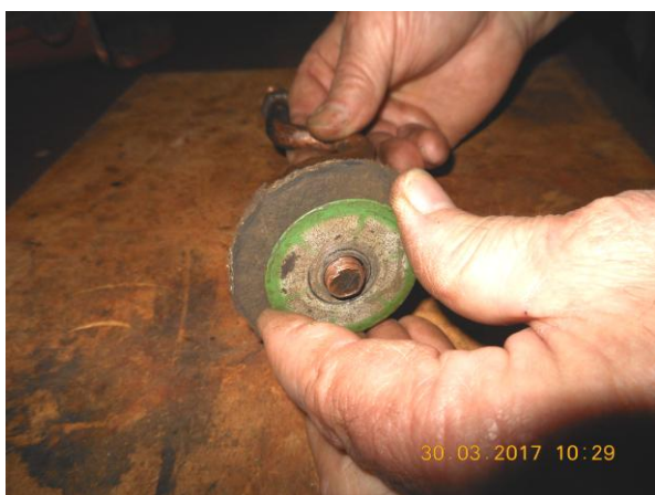
Рисунок Б.24 – Сборка на штоке поршня (левой стороны) насоса типа НР 0,25/30
