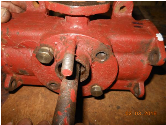
Рисунок Б.27 – Монтаж фланца приводного валика
