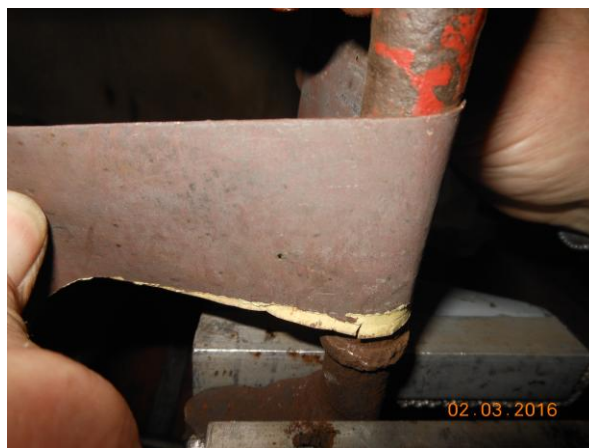
Рисунок В.15 – Шлифовка изношенного места приводного валика
