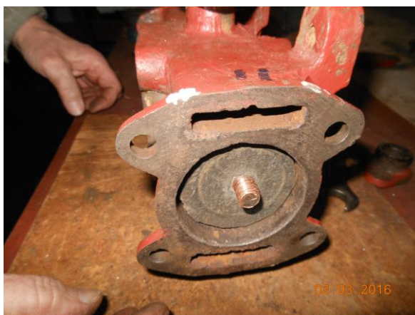
Рисунок Б.20 – Разборка составного поршня (левой стороны)
