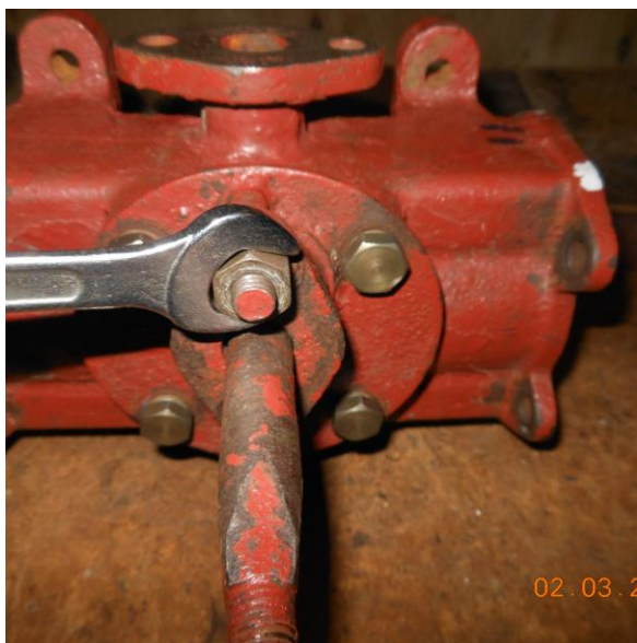
Рисунок Б.17 – Разборка сальникового уплотнения приводного валика
