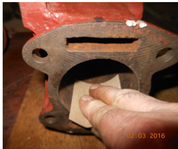
Рисунок В.19 – Шлифовка зеркала цилиндра наждачной бумагой
