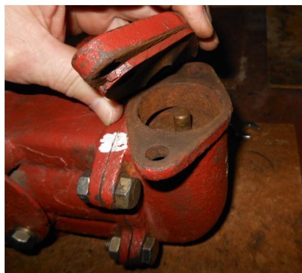
Рисунок Б.12 – Снятие крышки правой клапанной коробки
