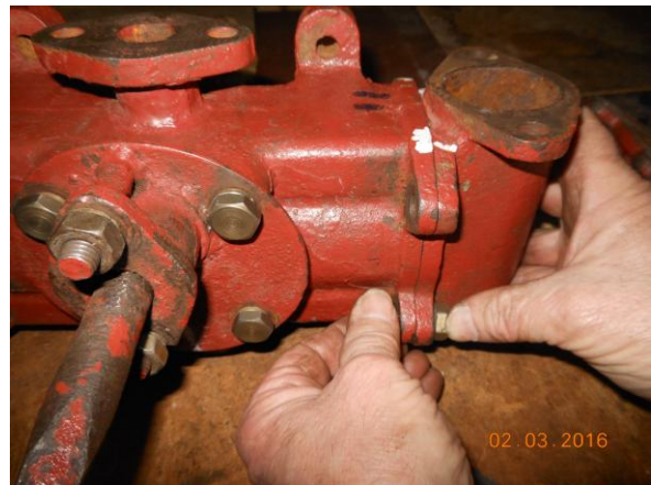
Рисунок Б.29 – Присоединение клапанной коробки к корпусу насоса
