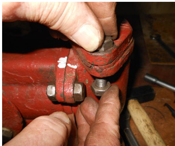
Рисунок Б.31 – Закреть клапанной коробки крышкой
