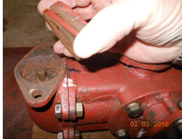
Рисунок Б.6 – Снятие крышки левой клапанной коробки
