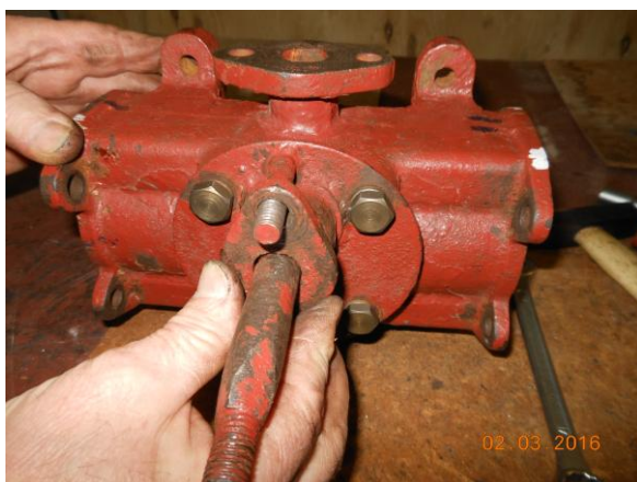
Установка и обжатие нажимной втулки сальника
