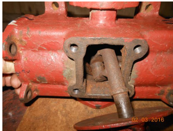
Рисунок Б.18 – Демонтаж фланца с приводным валиком
