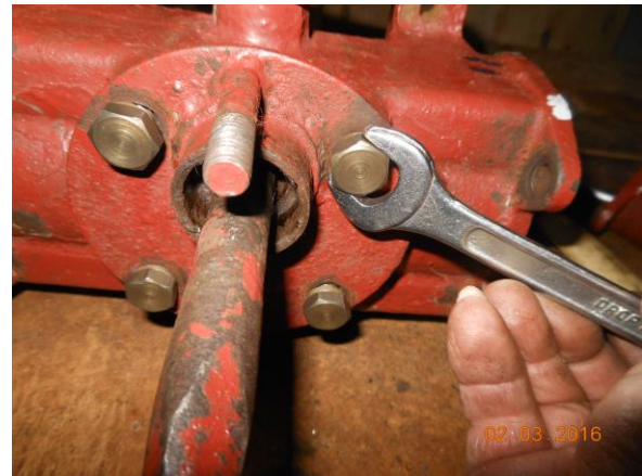
Рисунок Б.27 – Монтаж фланца приводного валика
