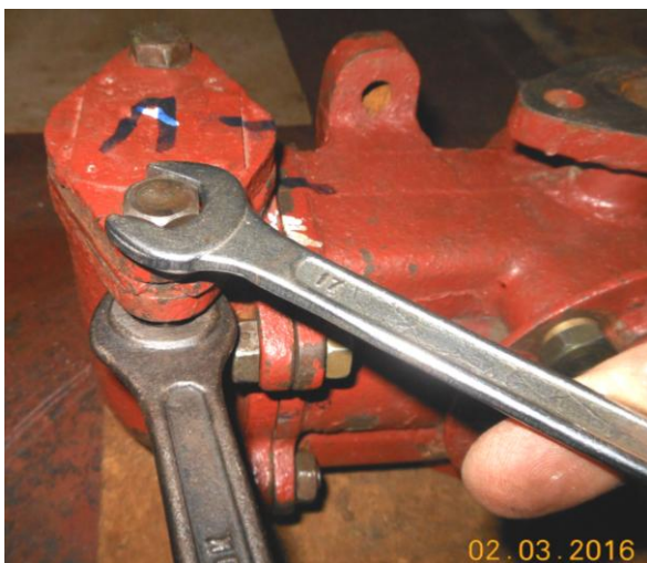
Рисунок Б.4 – Откручивание гаек крепления крышки левой клапанной коробки
