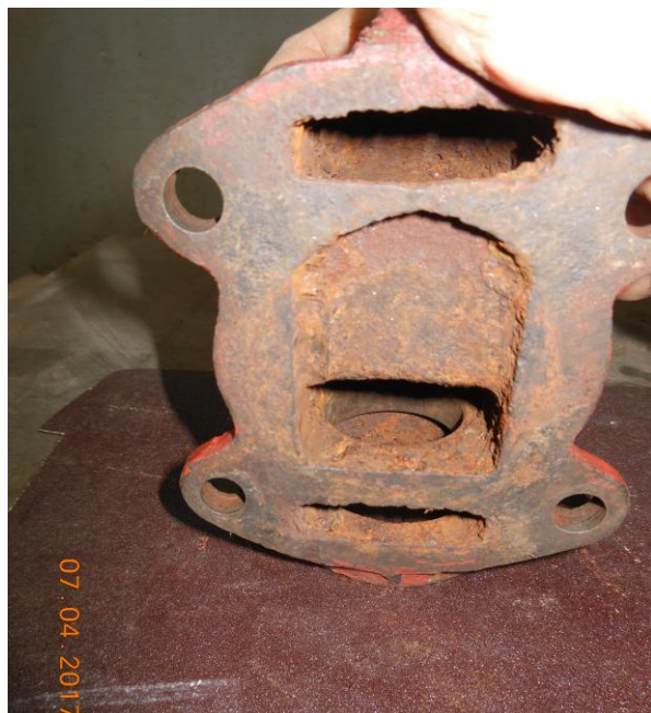
Рисунок В.8 – Шлифовка на плите уплотнительной поверхности клапанной коробки, сопрягаемой с крышкой
