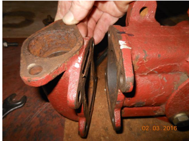
Рисунок Б.10 – Демонтаж левой клапанной коробки
