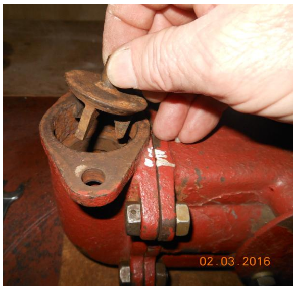
Рисунок Б.7 – Вынимание тарелки нагнетательного клапана левой клапанной коробки
