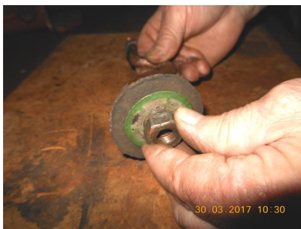
Рисунок Б.24 – Сборка на штоке поршня (левой стороны) насоса типа НР 0,25/30
