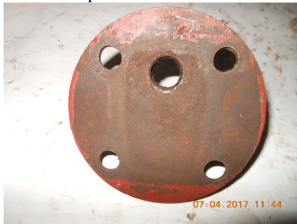
Рисунок В.16 – Осмотр поверхности фланца приводного валика
