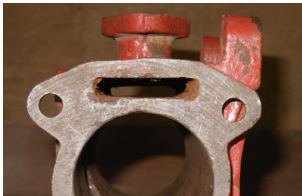
Рисунок В.17 – Осмотр всасывающей и нагнетательной камер насоса
