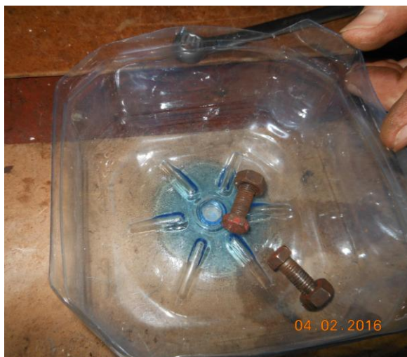
Рисунок Б.5 – Складывание крепежа при разборке насоса
