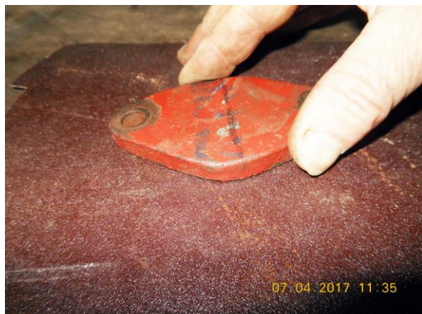
Рисунок В.7 – Шлифовка на плите уплотнительной поверхности крышки клапанной коробки
