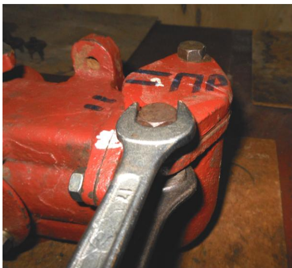
Рисунок Б.11 – Откручивание гаек крепления крышки правой клапанной коробки
