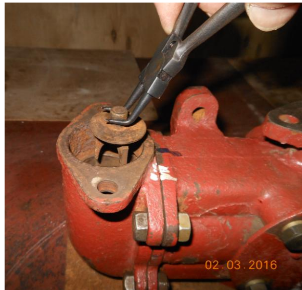
Рисунок Б.8 – Вынимание тарелки всасывающего клапана левой клапанной коробки
