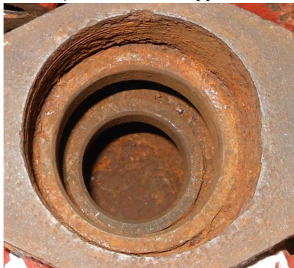
Рисунок В.2 – Осмотр седел всасывающего и нагнетательного клапанов (одной из клапанных коробок)
