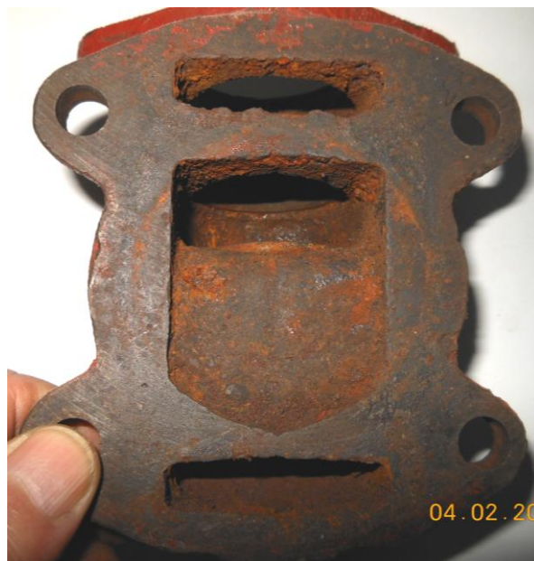
Рисунок В.6 – Осмотр поверхности клапанной коробки, сопрягаемой с корпусом насоса
