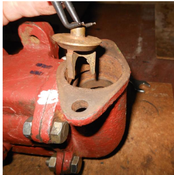
Рисунок Б.14 – Вынимание тарелки всасывающего клапана правой клапанной коробки
