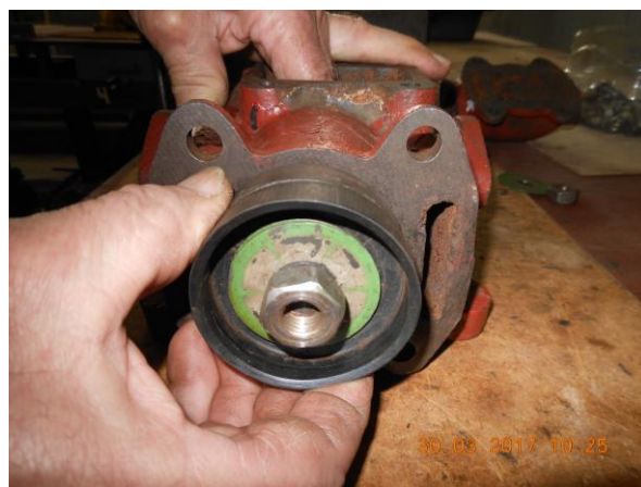
Рисунок Б.25 – Сборка на штоке поршня (правой стороны) насоса типа НР 0,25/30
