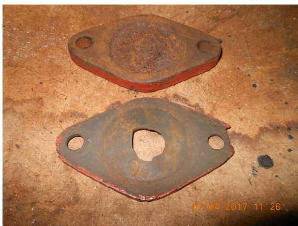
Рисунок В.4 – Осмотр уплотнительной поверхности крышки клапанной коробки
