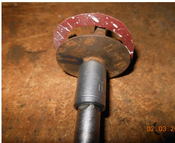
Положение наждачной бумаги для шлифовки тарелки и для шлифовки седла
