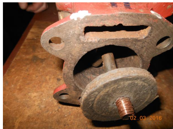
Рисунок Б.20 – Разборка составного поршня (левой стороны)
