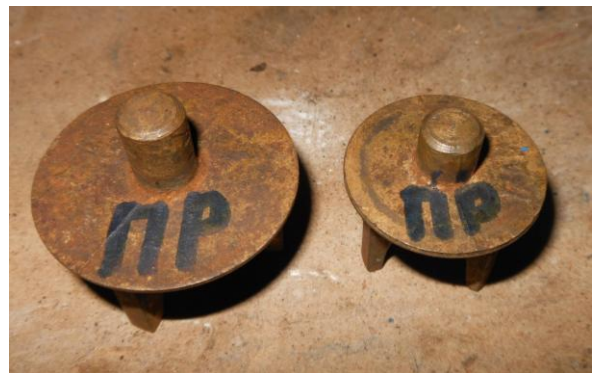
Рисунок Б.15 – Маркировка тарелок клапанов правой клапанной коробки
