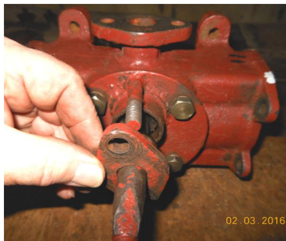
Рисунок Б.17 – Разборка сальникового уплотнения приводного валика
