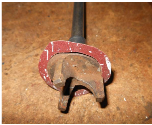
Положение наждачной бумаги для шлифовки тарелки и для шлифовки седла
