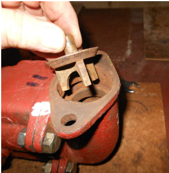
Рисунок Б.13 – Вынимание тарелки нагнетательного клапана правой клапанной коробки
