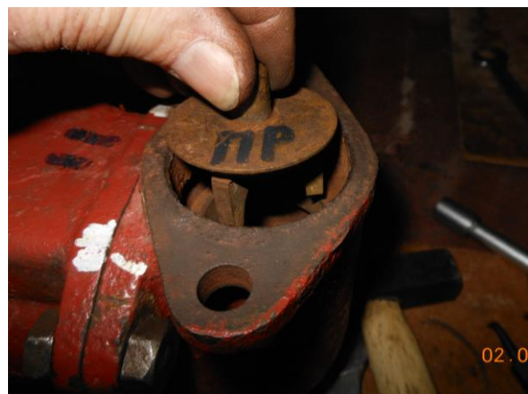
Рисунок Б.30 – Установка в клапанные коробки тарелок всасывающих и нагнетательных клапанов
