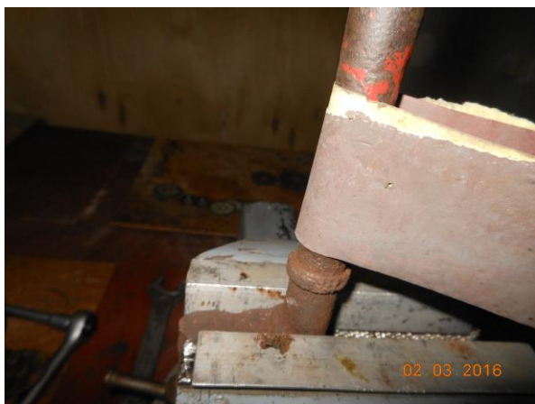
Рисунок В.15 – Шлифовка изношенного места приводного валика
