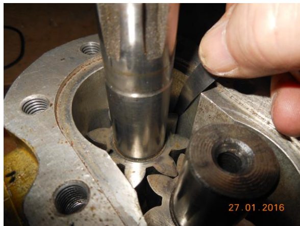
Рисунок Б.13 – Замер радиального зазора между вершинами зубьев шестерни и расточкой корпуса
