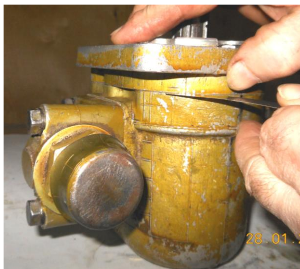
Рисунок Б.26 – Проверка отсутствия зазора между крышкой и корпусом насоса
