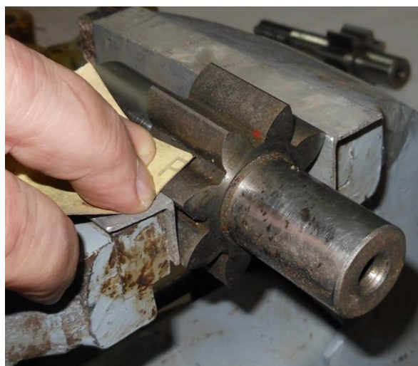
Рисунок В.3 – Зачистка зубьев вал-шестерни наждачной бумагой
