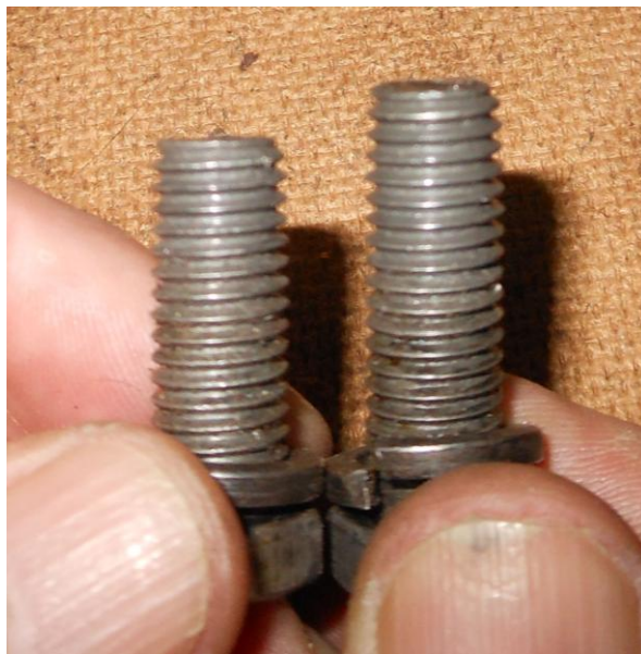
Рисунок Б.6 – Пример разной длины болтов, крепящих крышку к корпусу
