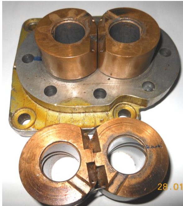
Рисунок В.4 – Осмотр втулок подшипников
