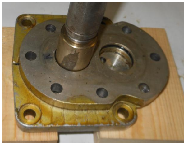
Рисунок Б.11 – Выпрессовка манжеты из крышки насоса
