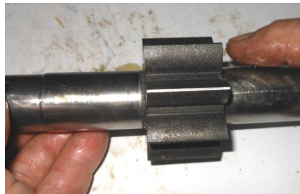
Рисунок Б.21 – Смазывание шеек валов и зубьев шестерен
