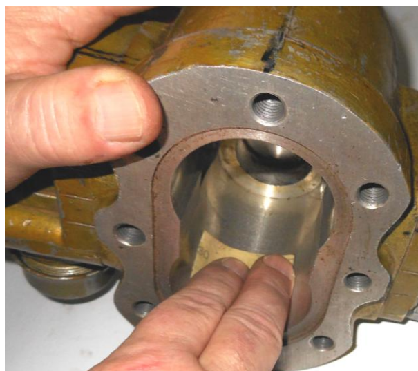
Рисунок В.9 – Зачистка расточек корпуса под шестерни
