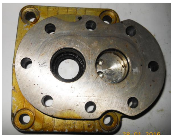
Рисунок В.8 – Осмотр крышки насоса
