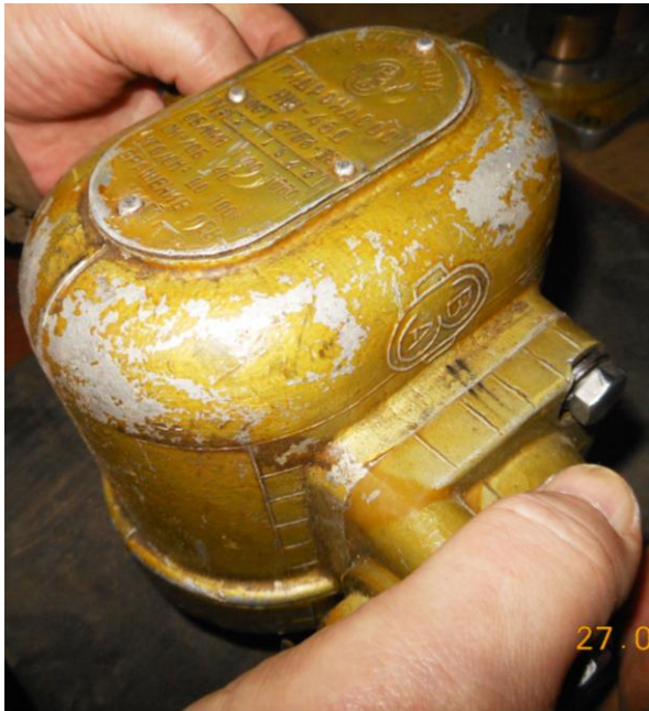
Рисунок Б.17 – Вытряхивание втулок подшипников из корпуса насоса
