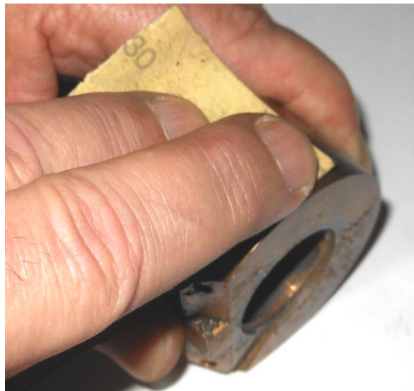
Рисунок В.6 – Зачистка посадочной поверхности втулки подшипника
