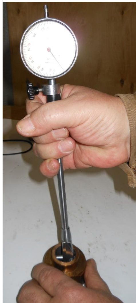
Рисунок В.13 – Замер внутреннего диаметра втулки подшипника
