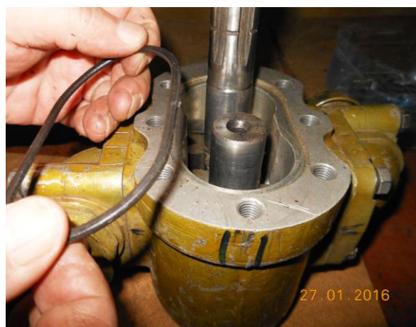
Рисунок Б.12 – Снятие резиновой прокладки с корпуса насоса
