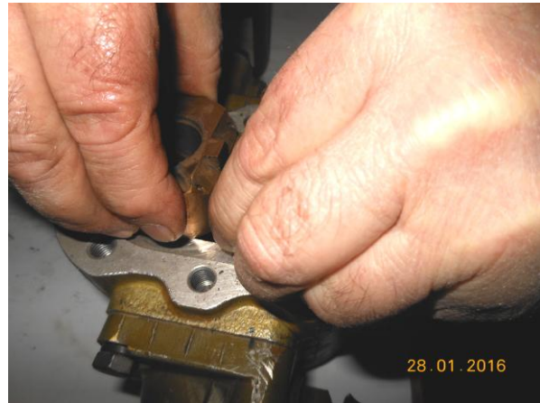
Рисунок Б.20 – Заведение втулок подшипников в корпус насоса
