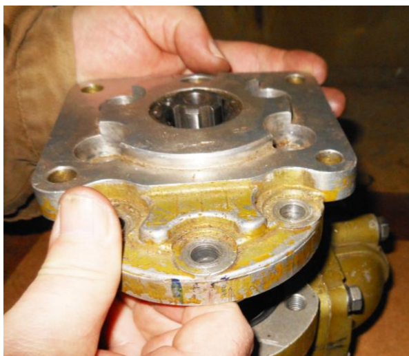
Рисунок Б.7 – Снятие крышки с корпуса насоса
