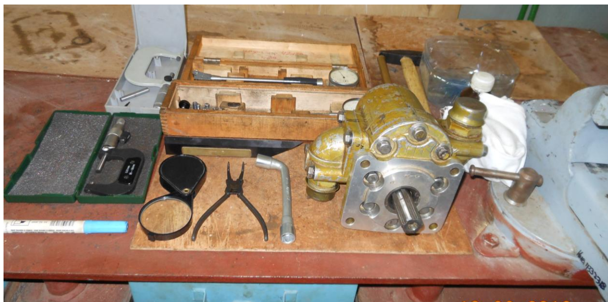
Рисунок 2 – Рабочее место для переборки шестеренного насоса типа НШ-46Д
