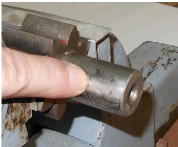
Рисунок В.2 – Полировка шейки вала-шестерни наждачной бумагой
