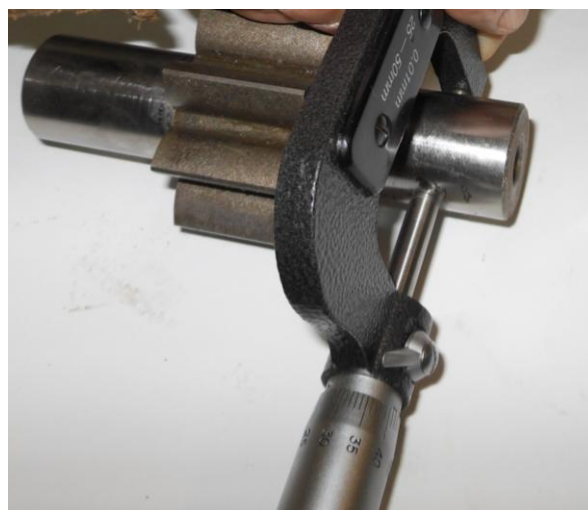
Рисунок В.11 – Замер диаметра шейки вала-шестерни
