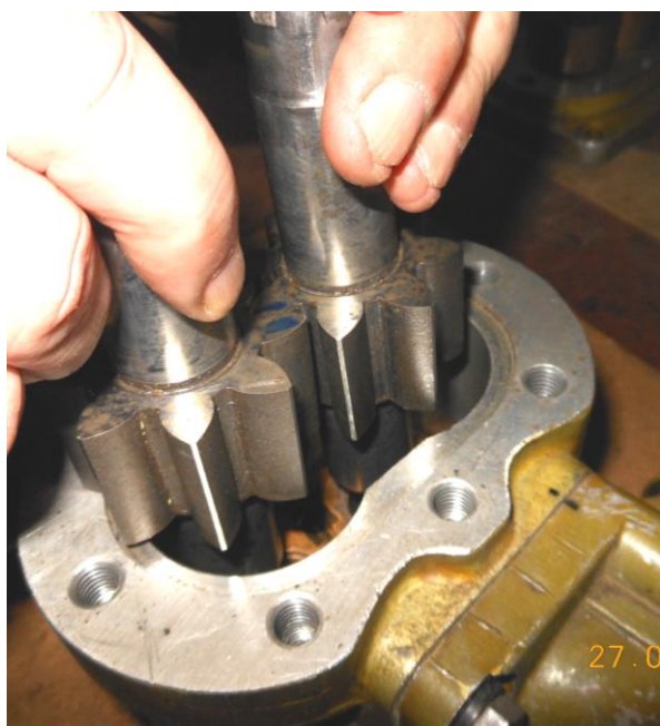
Рисунок Б.15 – Вынимание шестерен из корпуса насоса
