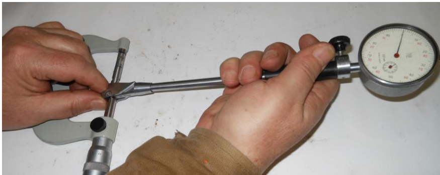
Рисунок В.15 – Выставление установочного раз- мера индикаторного нутромера для заме- ра диаметра расточ- ки корпуса
