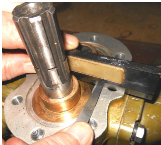
Рисунок В.17 – Замер торцового зазора между шестернями и втулками подшипников
