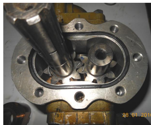
Рисунок Б.22 – Установка валов-шестерен в корпус насоса
