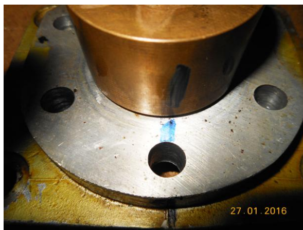
Рисунок Б.8 – Маркировка положения втулок подшипников в крышке насоса
