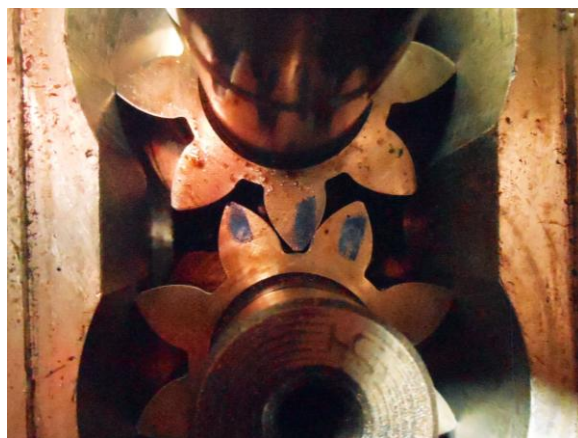
Рисунок Б.14 – Маркировка взаимного положения шестерен насоса
