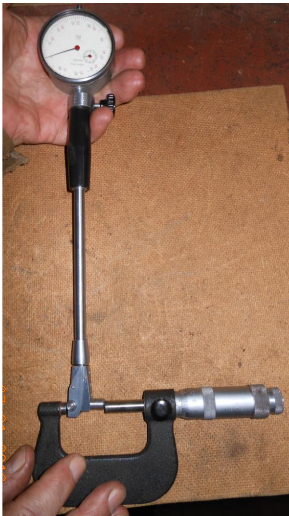
Рисунок В.12 – Выставление установочного размера индикаторного нутромера для замера внутреннего диаметра втулки подшипника
