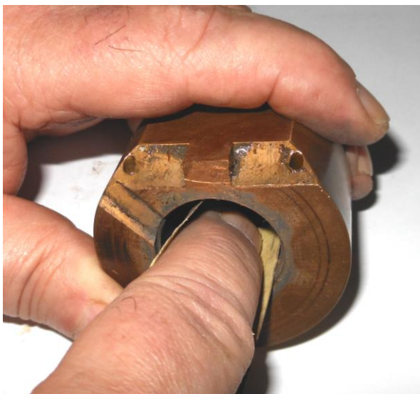
Рисунок В.5 – Зачистка рабочей поверхности втулки подшипника
