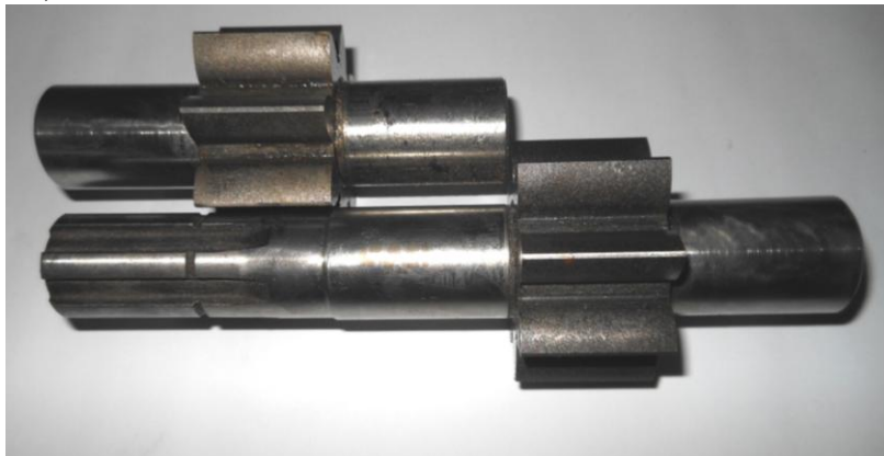
Рисунок В.1 – Осмотр валов-шестерен
