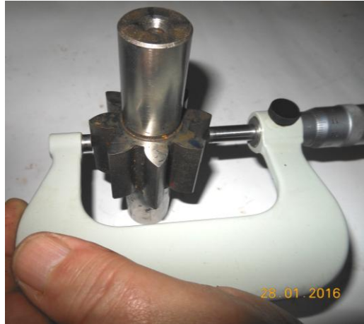
Рисунок В.14 – Замер диаметра шестерни
