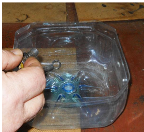
Рисунок Б.5 – Складывание в емкость крепежа при разборке насоса
