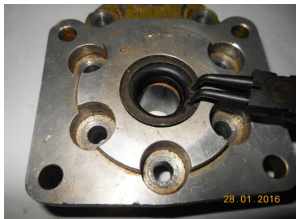
Рисунок Б.10 – Снятие кольца Зегера с помощью щипцов для стопорных колец
