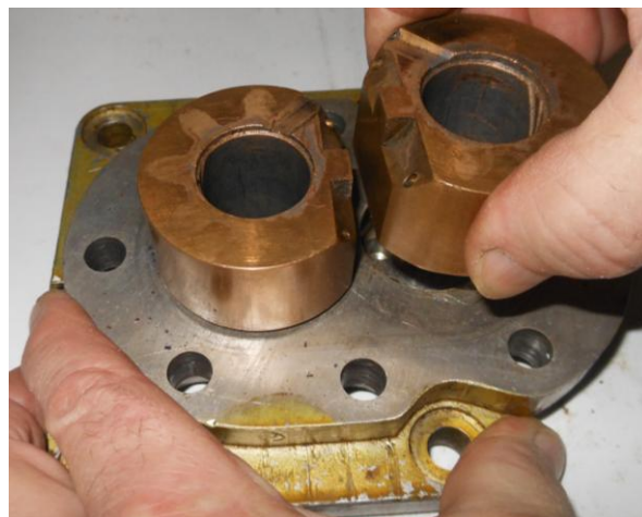
Рисунок Б.9 – Вынимание втулок подшипников из крышки насоса
