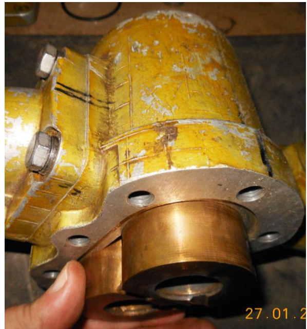
Рисунок Б.18 – Вынимание втулок подшипников из корпуса насоса
