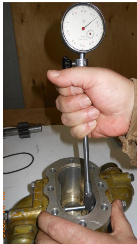
Рисунок В.16 – Замер диаметра расточки корпуса насоса
