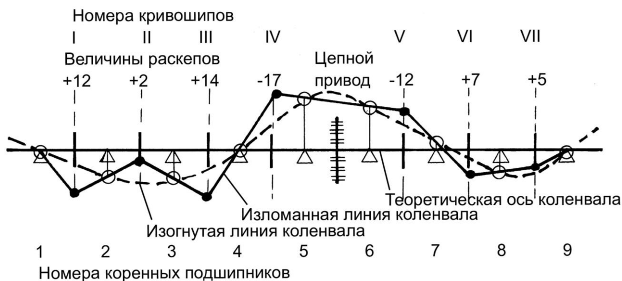
Рисунок А.11 – Схема построения изогнутой линии коленчатого вала по величинам раскёпов
