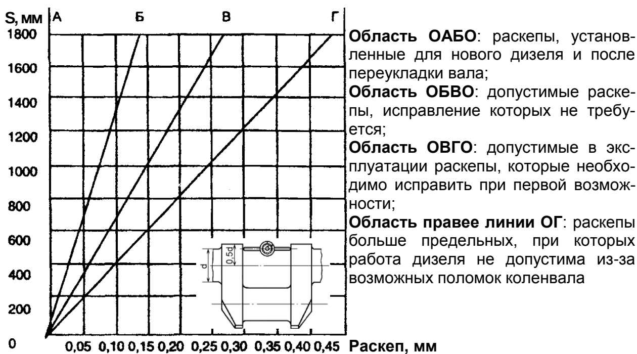
Рисунок А.10 – Номограмма норм раскёпов коленчатых валов
