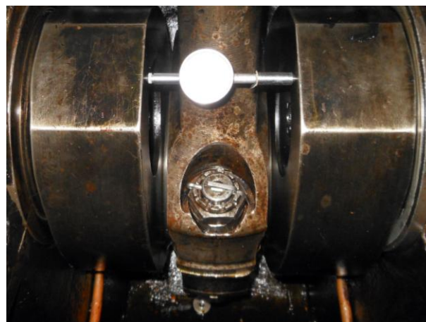
Рисунок Б.14 – Исходное положение раскепницы при положении кривошипа в нижней мертвой точке (НМТ 1 )
