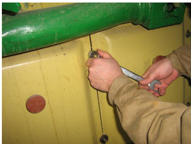
Рисунок Б.5 – Вскрытие лючков картера
