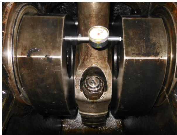
← корма нос → Рисунок Б.19 – Снятие показаний индикатора при положении кривошипа в нижней мертвой точке (НМТ 2 )
