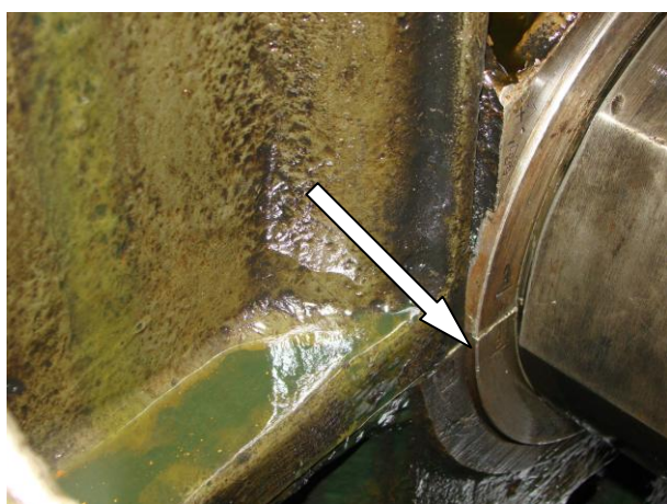
Рисунок Б.16 – Контроль положения стыков вкладышей коренных подшипников
