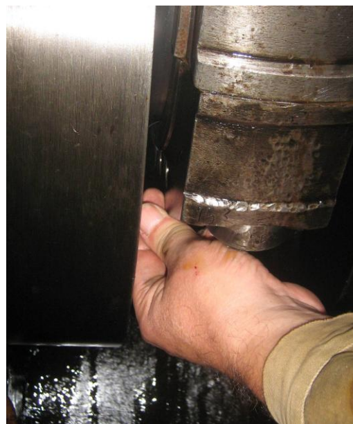
Рисунок Б.22 – Замер масляного зазора в шатунном подшипнике щупом
