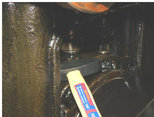
Рисунок Б.42 – Контроль затяжки анкерных связей обстукиванием
