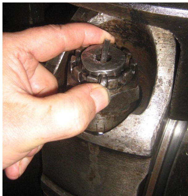
Рисунок Б.13 – Проверка целостности (а) и плотности посадки (б) шплинтов на шатунных болтах
