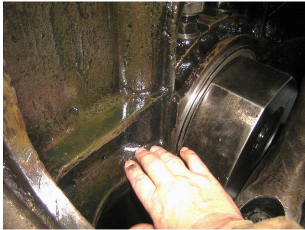
Рисунок Б.8 – Контроль следов износа деталей, посторонних частиц
