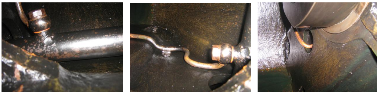
Рисунок Б.10 – Контроль герметичности и плотности соединений масляного трубопровода
