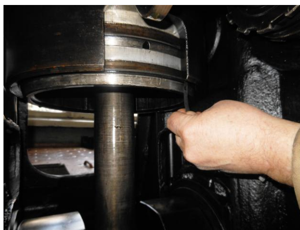
Рисунок Б.40 – Замер зазора "втулка цилиндра – поршень"
