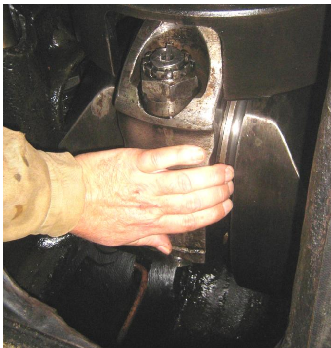
Рисунок Б.11 – Проверка на ощупь температуры крышек коренных и шатунных подшипников
