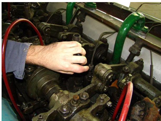
Рисунок Б.4 – Открытие индикаторных кранов
