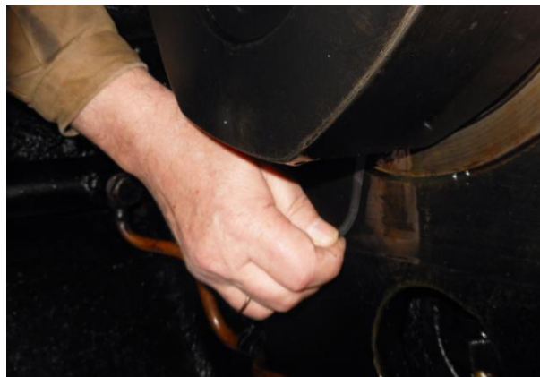
Рисунок Б.20 – Контроль прилегания нижнего вкладыша к коренной шейке
