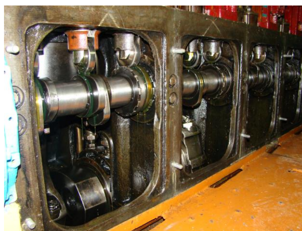
Рисунок Б.5 – Вскрытие люков картера
