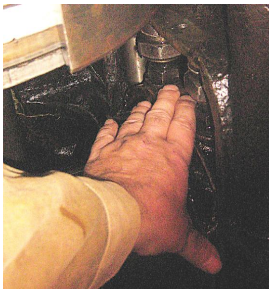
Рисунок Б.11 – Проверка на ощупь температуры крышек коренных и шатунных подшипников
