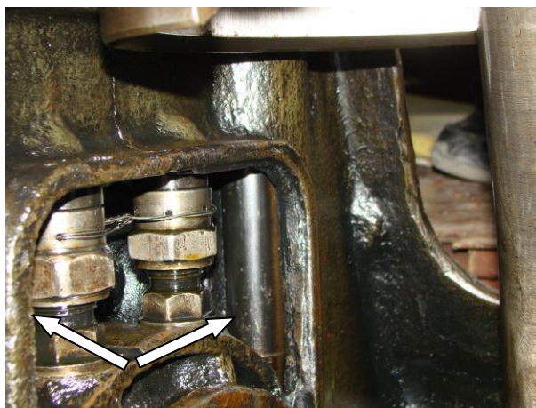
Рисунок Б.42 – Контроль затяжки анкерных связей обстукиванием
