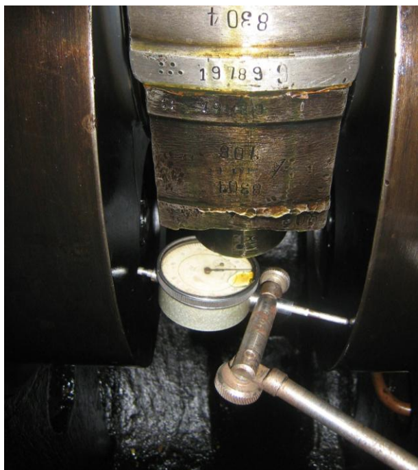
Рисунок Б.28 – Установка индикатора для замера осевого разбега коленвала
