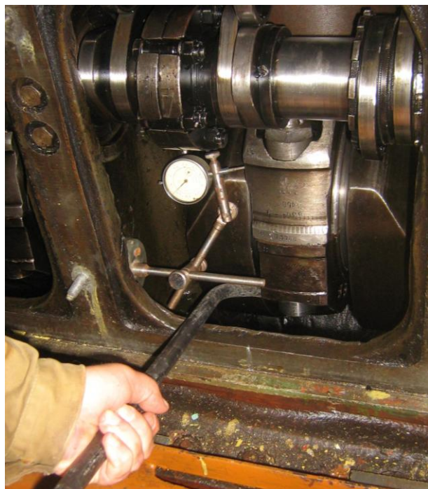
Рисунок Б.25 – Сдвигание ШПГ для замера ее разбега
