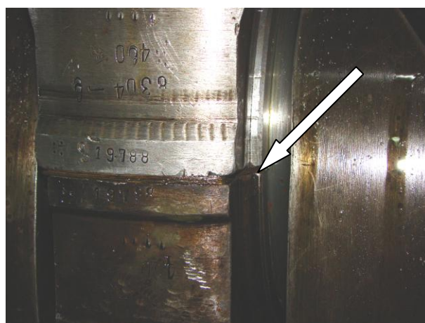
Рисунок Б.17 – Контроль положения стыков вкладышей шатунных подшипников
