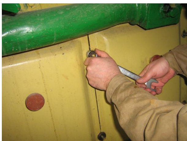
Рисунок Б.5 – Вскрытие люков картера
