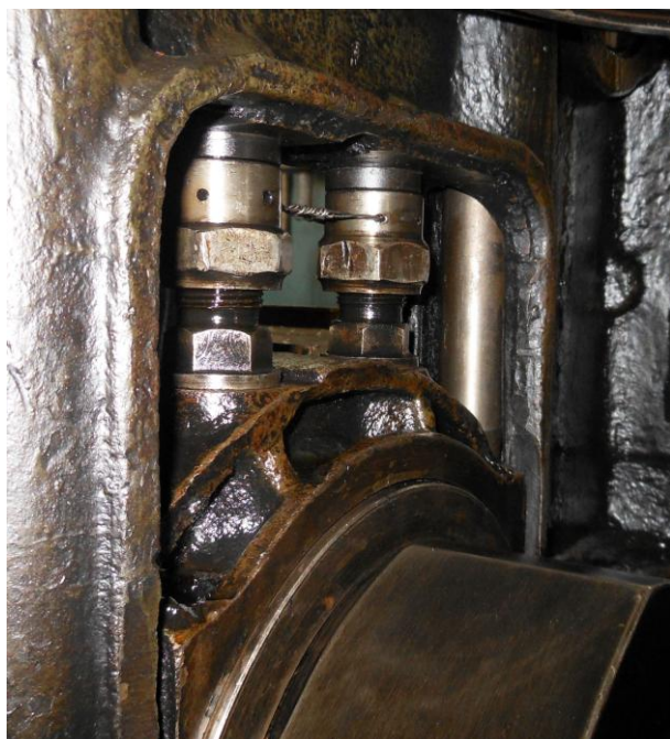
Рисунок Б.12 – Проверка целостности (а) и натяжения стопорной проволоки (б) на домкратах крышек коренных подшипников
