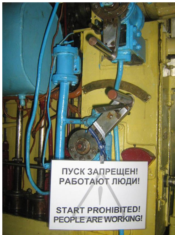
Рисунок Б.3 – Вывешивание предупредительной таблички
