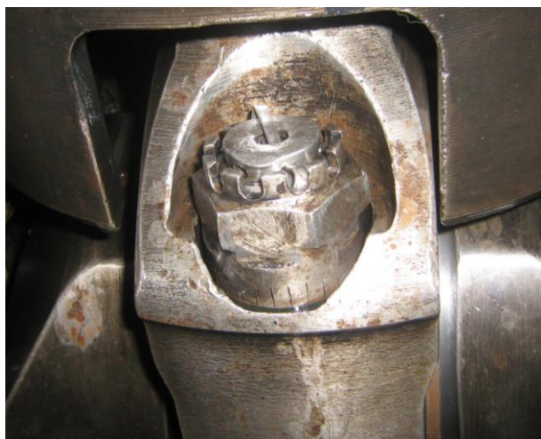
Рисунок Б.14 – Неправильное положение шплинта шатунного болта
