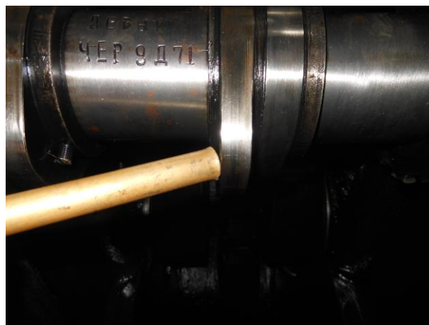
Рисунок Б.31 – Проверка обстукиванием посадки кулачных шайб на распредвале
