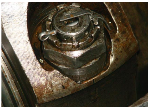
Рисунок Б.13 – Проверка целостности (а) и плотности посадки (б) шплинтов на шатунных болтах
