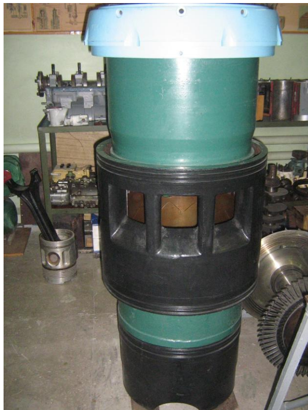
Рисунок 5 – Внешний вид рабочего места для осмотра и обмеров втулки цилиндра дизеля типа ZD72/48
