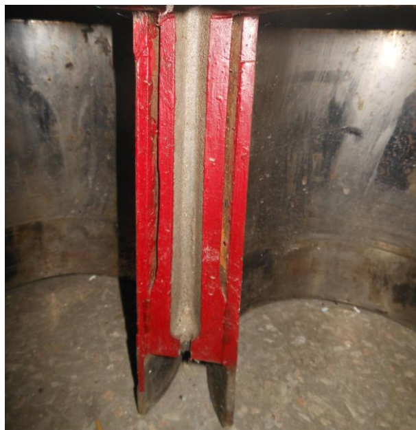
Рисунок А.23 – Осмотр поверхностей верхних посадочных поясов, охлаждения и нижних уплотнительных поясов втулок цилиндров дизеля типа М-50
