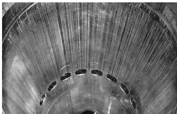
Рисунок А.7 – Пример вертикальных рисков на рабочей поверхности втулки цилиндра двухтактного дизеля
