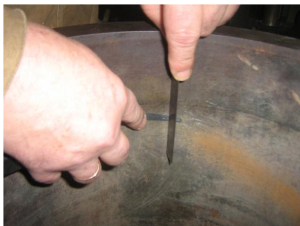
Рисунок А.26 – Замер наработка на втулке цилиндра дизеля типа 8NVD48.AU
