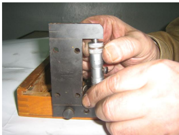
Рисунок Б.20 – Проверка нулевого положения микрометрического нутромера
