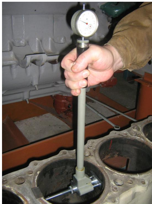
Рисунок Б.23 – Обмер втулки цилиндра дизеля типа М-50 индикаторным нутромером
