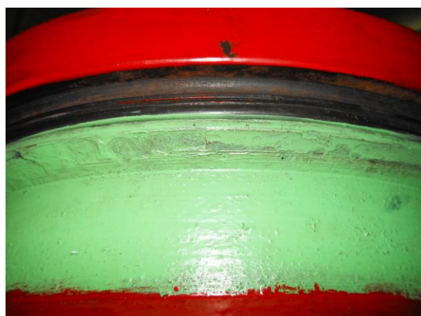
Рисунок А.28 – Осмотр поверхностей верхнего посадочного пояса втулки цилиндра дизеля типа 8NVD48.2AU
