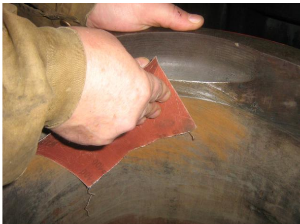
Рисунок А.25 – Зачистка рабочей поверхности втулки цилиндра дизеля типа 8NVD48.2AU
