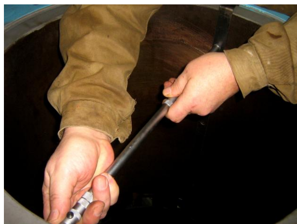
Рисунок Б.31 – Обмер втулки цилиндра дизеля типа 8ZD72/48 микрометрическим нутромером
