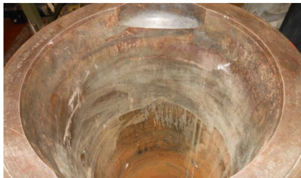
Рисунок А.24 – Осмотр рабочей поверхности втулки цилиндра дизеля типа 8NVD48.2AU
