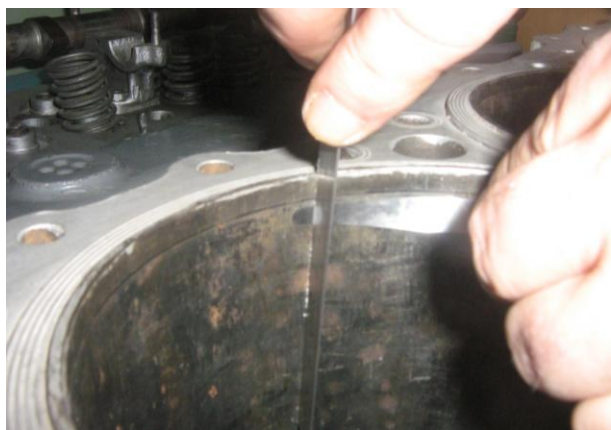
Рисунок А.17 – Замер наработки на втулке цилиндра дизеля типа 3Д6
