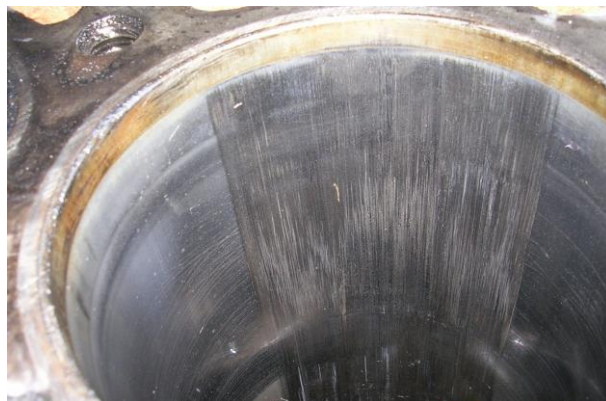
Рисунок А.6 – Пример задира рабочей поверхности втулки цилиндра четырехтактного дизеля
