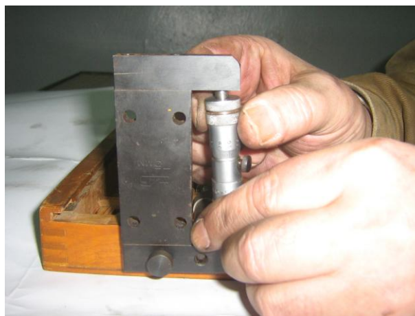
Рисунок Б.14 – Проверка нулевого положения микрометрического нутромера
