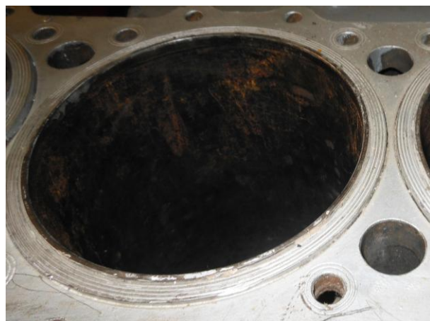
Рисунок А.18 – Осмотр уплотнительной поверхности втулки, сопрягаемой с крышкой цилиндра дизеля типа 3Д6
