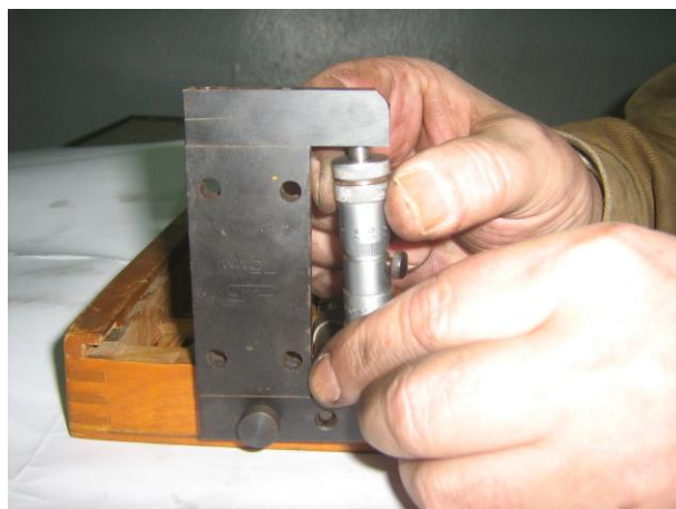
Рисунок Б.30 – Проверка нулевого положения микрометрического нутромера
