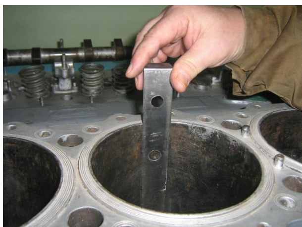
Рисунок Б.13 – Установка шаблона для обмера втулки цилиндра дизеля типа 3Д6
