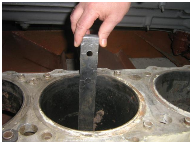
Рисунок Б.19 – Установка шаблона для обмера втулки цилиндра дизеля типа М-50
