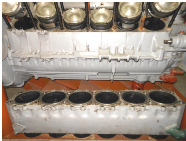
Рисунок 2 – Внешний вид рабочего места для осмотра и обмеров втулок цилиндров дизеля типа 7Д12
