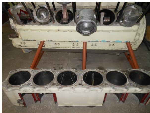
Рисунок 3 – Внешний вид рабочего места для осмотра и обмеров втулок цилиндров дизеля типа М-50
