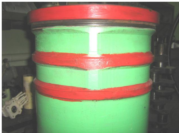
Рисунок А.29 – Осмотр поверхности охлаждения втулки цилиндра дизеля типа 8NVD48.2AU
