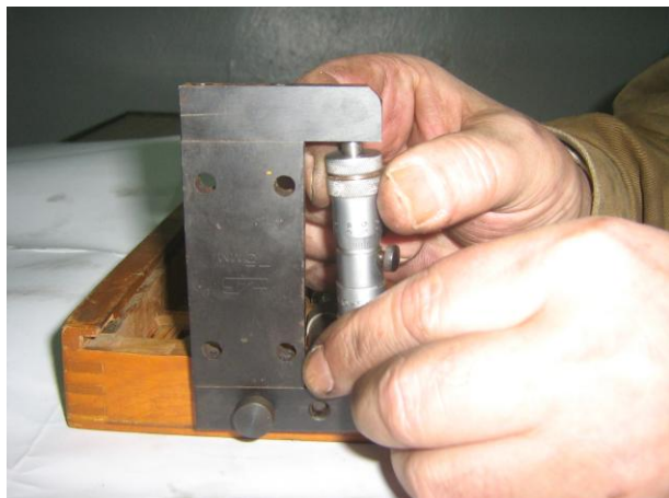
Рисунок Б.26 – Проверка нулевого положения микрометрического нутромера
