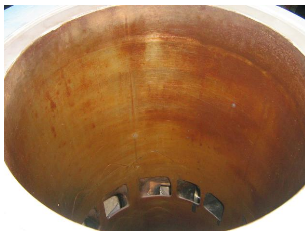
Рисунок А.31 – Осмотр рабочей поверхности втулки цилиндра дизеля типа 8ZD72/48
