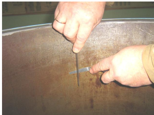
Рисунок А.33 – Замер наработки на втулке цилиндра дизеля типа 8ZD72/48
