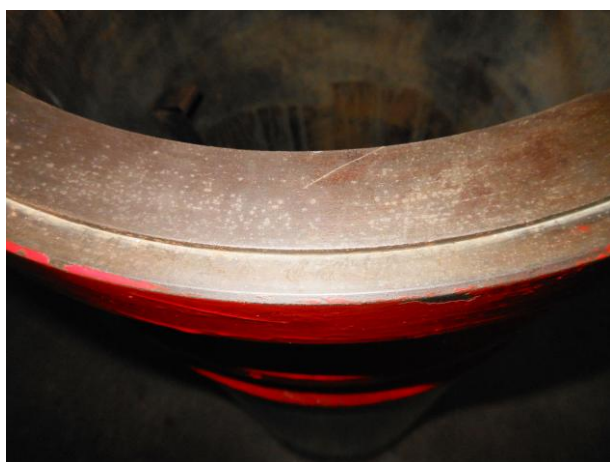
Рисунок А.27 – Осмотр уплотнительной поверхности втулки, сопрягаемой с крышкой цилиндра дизеля типа 8NVD48.2AU
