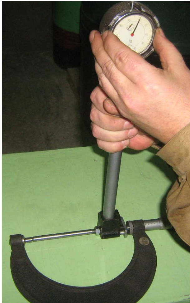
Рисунок Б.16 – Выставление установочного размера индикаторного нутромера
