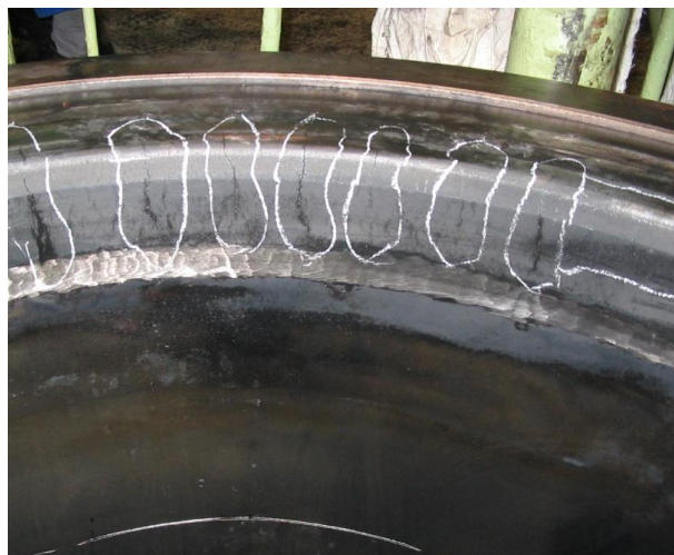
Рисунок А.3 – Пример трещин на втулке цилиндра двухтактного дизеля
