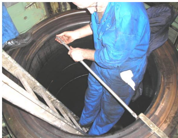
Рисунок Б.7 – Схема установки микрометрического нутромера в плоскости оси втулки цилиндра и перпендикулярно к ней
