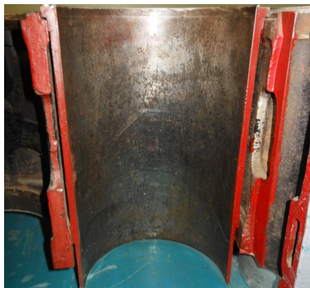
Рисунок А.19 – Осмотр поверхностей верхних посадочных поясов, охлаждения и нижних уплотнительных поясов втулок цилиндров дизеля типа 3Д6
