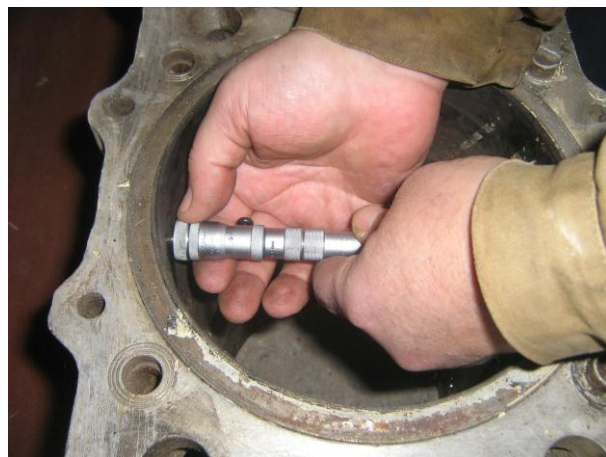
Рисунок Б.21 – Обмер втулки цилиндра дизеля типа М-50 микрометрическим нутромером
