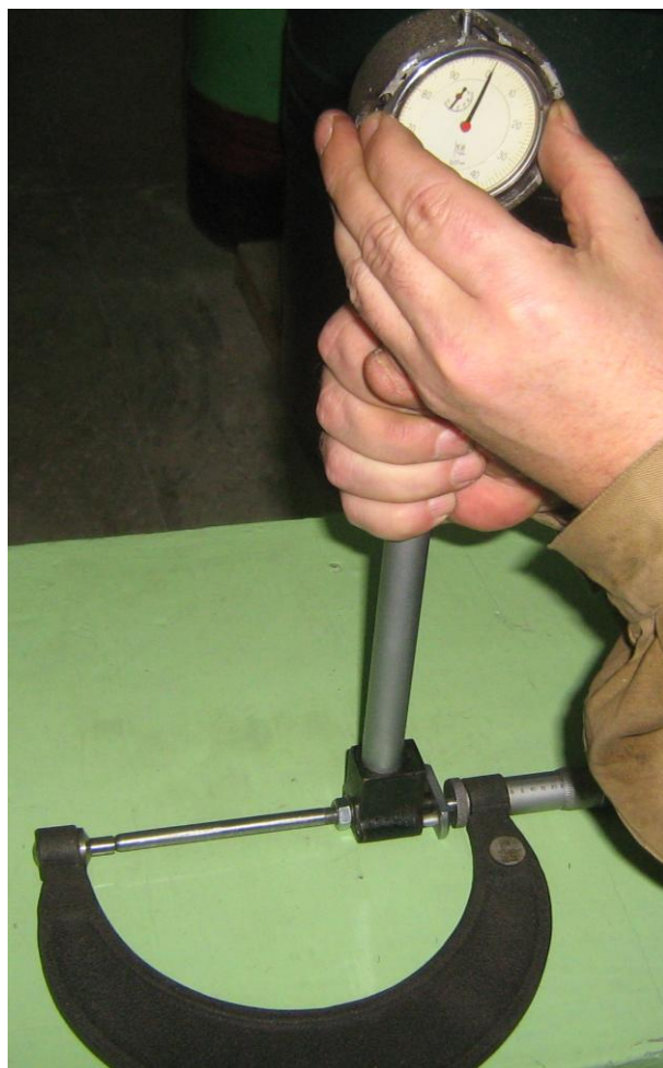
Рисунок Б.22 – Выставление установочного размера индикаторного нутромера
