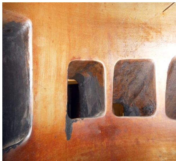
Рисунок А.35 – Осмотр кромок продувочных и выпускных окон дизеля типа 8ZD72/48
