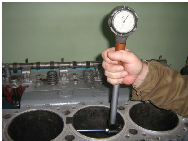
Рисунок Б.17 – Обмер втулки цилиндра дизеля типа 3Д6 индикаторным нутромером
