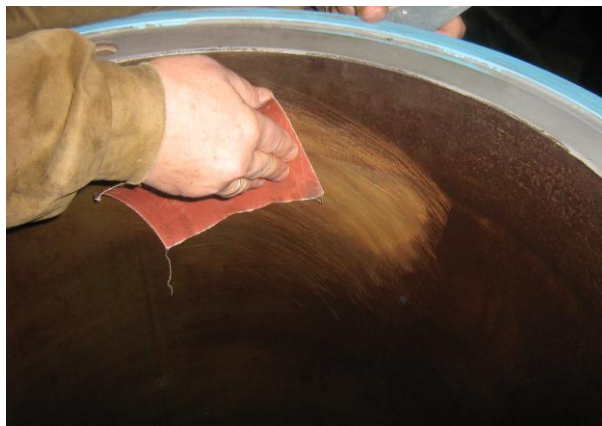
Рисунок А.32 – Зачистка рабочей поверхности втулки цилиндра дизеля типа 8ZD72/48
