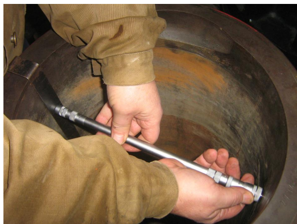
Рисунок Б.27 – Обмер втулки цилиндра дизеля типа 8NVD48.AU микрометрическим нутромером
