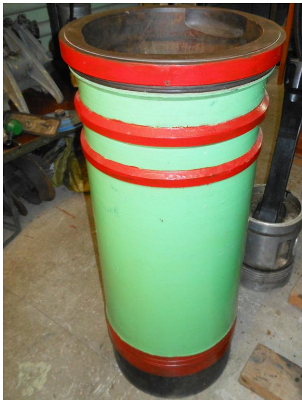
Рисунок 4 – Внешний вид рабочего места для осмотра и обмеров втулки цилиндра дизеля типа NVD48.2AU
