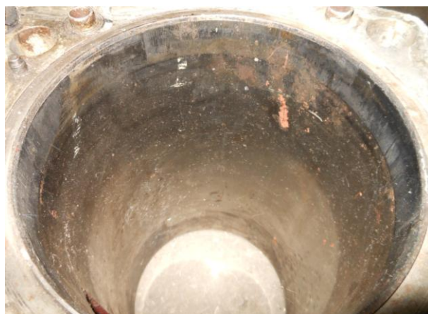
Рисунок А.20 – Осмотр рабочей поверхности втулки цилиндра дизеля типа М-50
