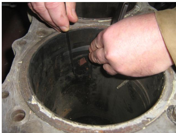
Рисунок А.21 – Замер наработки на втулке цилиндра дизеля типа М-50
