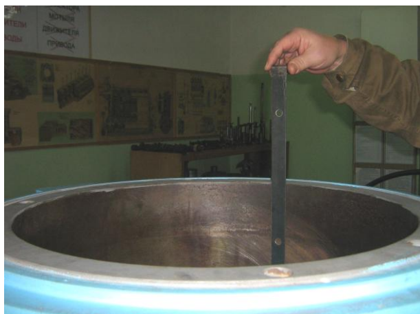
Рисунок Б.29 – Установка шаблона для обмера втулки цилиндра дизеля типа 8ZD72/48
