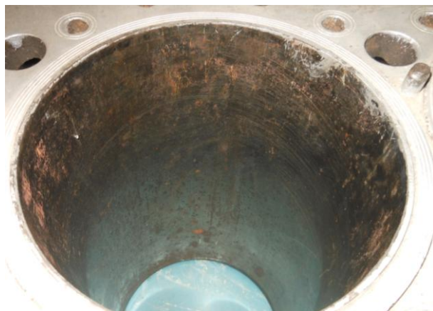
Рисунок А.16 – Осмотр рабочей поверхности втулки цилиндра дизеля типа 3Д6
