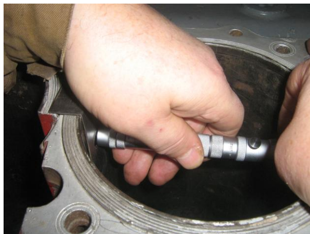
Рисунок Б.15 – Обмер втулки цилиндра дизеля типа 3Д6 микрометрическим нутромером
