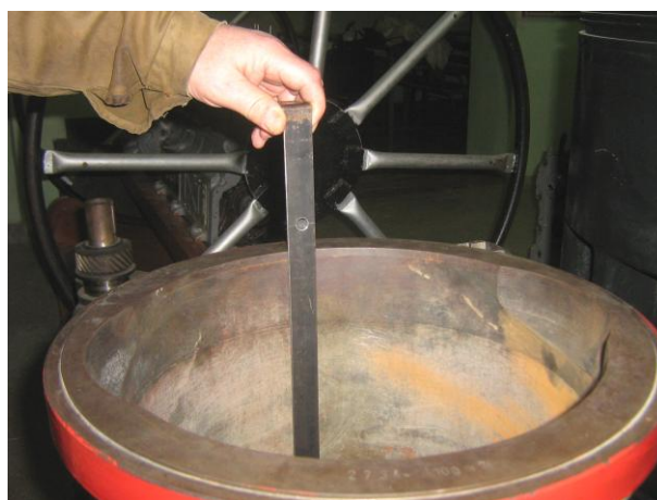
Рисунок Б.25 – Установка шаблона для обмера втулки цилиндра дизеля типа 8NVD48.2AU
