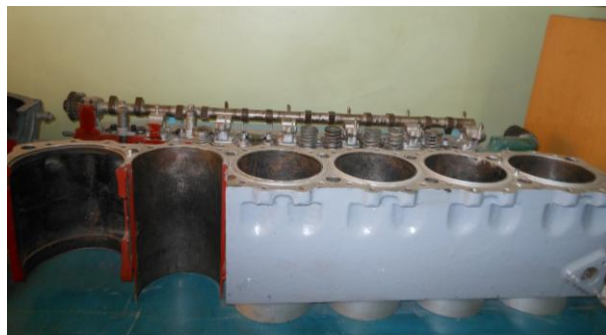
Рисунок 1 – Внешний вид рабочего места для осмотра и обмеров втулок цилиндров дизеля типа 3Д6
