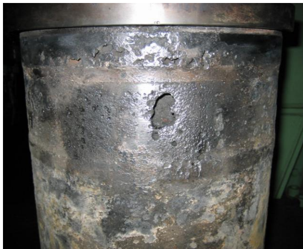
Рисунок А.14 – Пример разрушений поверхности охлаждения втулки цилиндра
