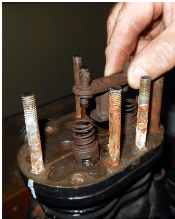
Рисунок Б.10 – Снятие траверсы крепления нагнетательных клапанов к клапанной доске
