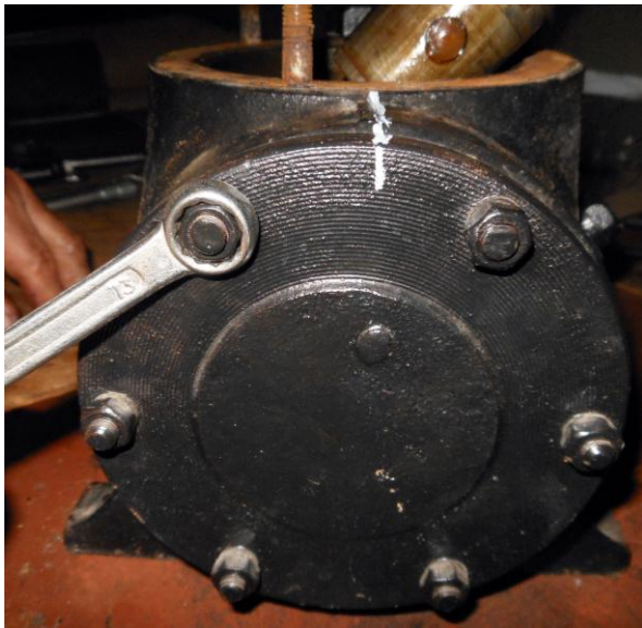
Рисунок Б.63 – Ослабление затяжки гаек крепления задней опоры
