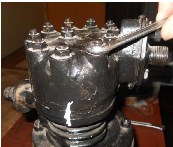
Рисунок Б.3 – Ослабление затяжки и скручивание гаек шпилек крепления крышки цилиндров
