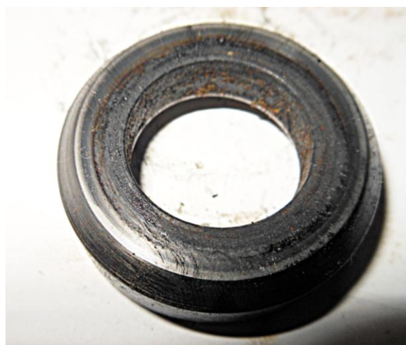
Рисунок Б.57 – Осмотр торцевой рабочей поверхности обоймы
