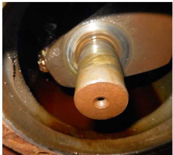
Рисунок Б.66 – Осмотр рабочей поверхности коренной шейки и торца щеки коленчатого вала
