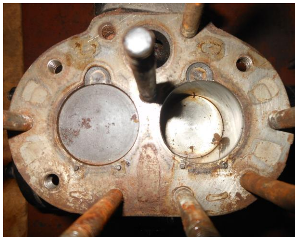
Рисунок Б.28 – Осмотр уплотнительной поверхности блока цилиндров со стороны клапанной доски
