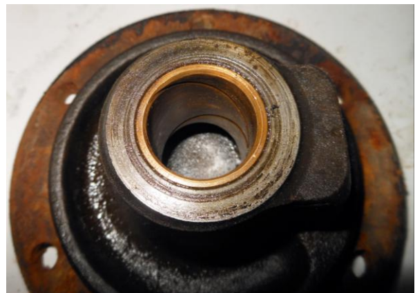
Рисунок Б.65 – Осмотр рабочей поверхности втулки коренного подшипника
