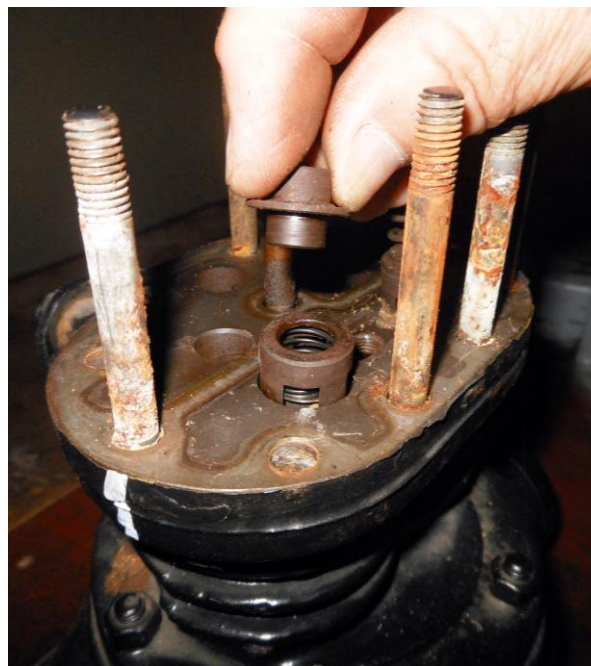
Рисунок Б.12 – Снятие буфера нагнетательного клапана
