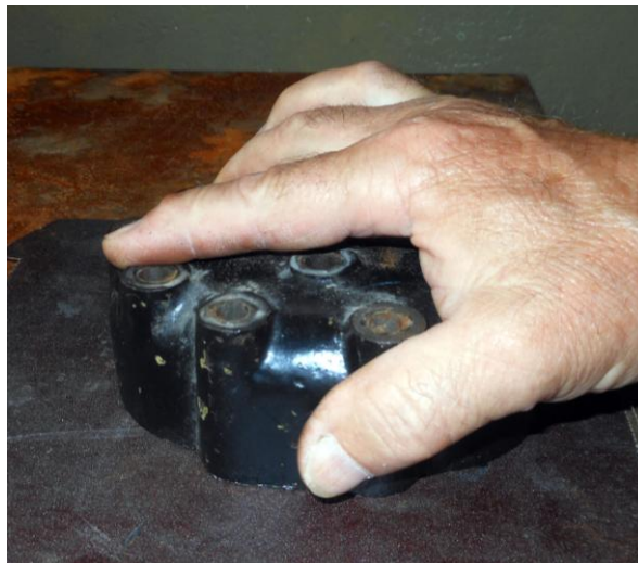
Рисунок Б.8 – Шлифовка уплотнительной поверхности крышки цилиндров
