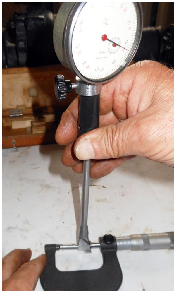
Рисунок Б.38 – Выставление установочного размера индикаторного нутромера
