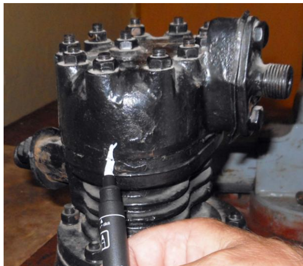
Рисунок Б.2 – Маркировка взаимного положения крышки цилиндров и клапанной плиты относительно блока цилиндров
