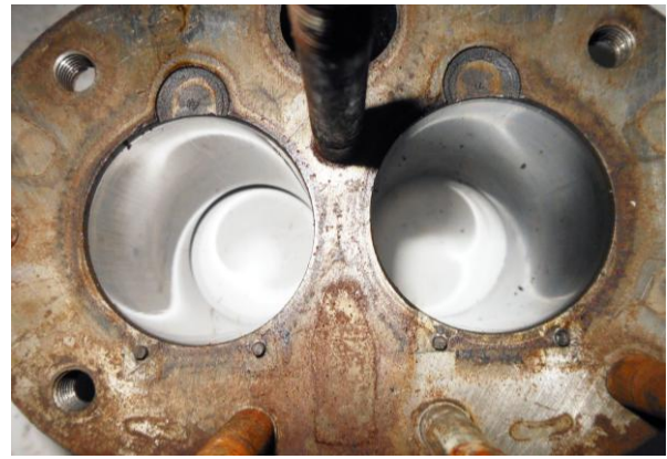
Рисунок Б.36 – Осмотр рабочих поверхностей цилиндров
