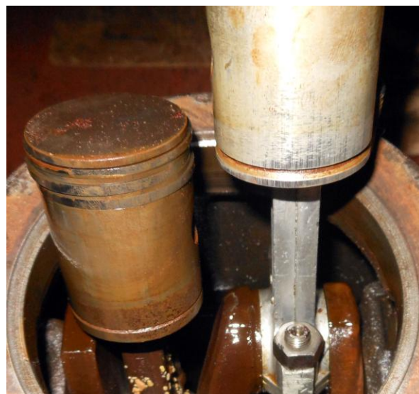
Рисунок Б.40 – Осмотр рабочих поверхностей поршня
