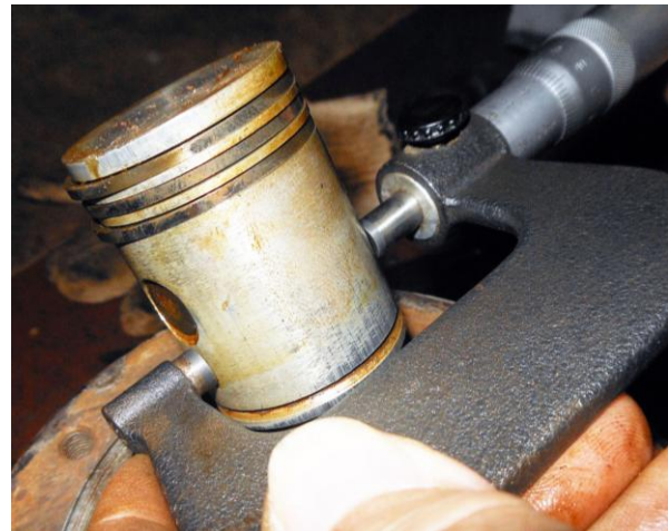
Рисунок Б.42 – Обмер тронка поршня
