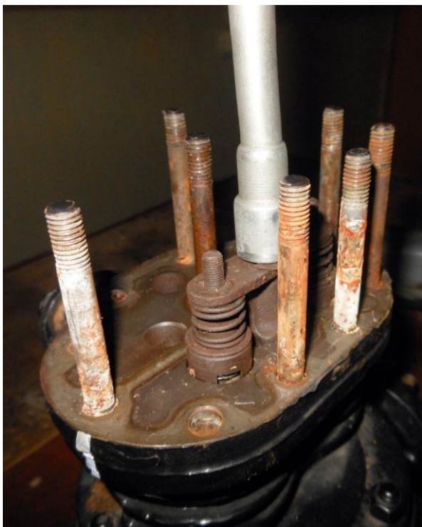
Рисунок Б.9 – Откручивание болта крепления траверсы нагнетательных клапанов к клапанной доске
