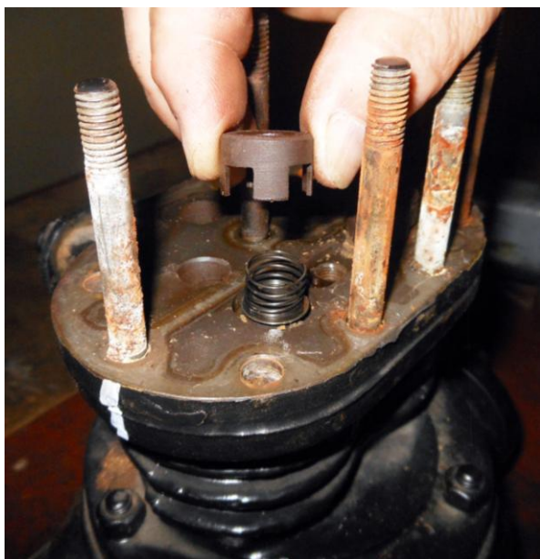
Рисунок Б.13 – Снятие розетки нагнетательного клапана
