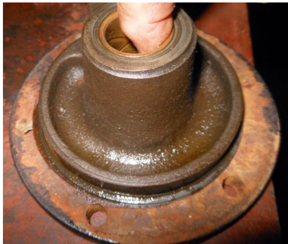
Рисунок Б.67 – Смазывание рабочей поверхности втулки коренного подшипника
