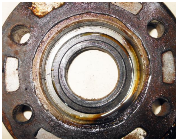
Рисунок Б.53 – Осмотр неподвижного графитового кольца в крышке
