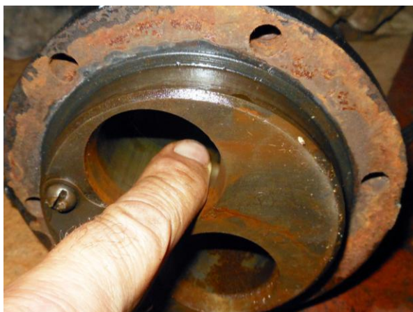
Рисунок Б.45 – Смазывание маслом рабочей поверхности втулки цилиндра (по всей высоте)
