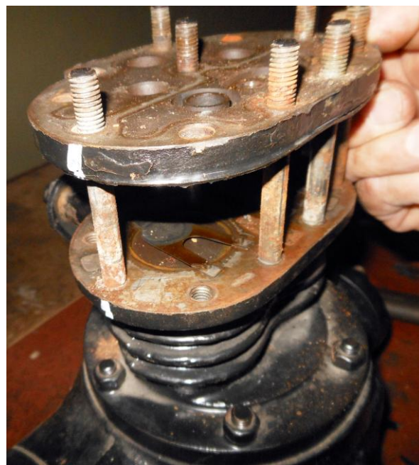
Рисунок Б.20 – Снятие клапанной доски с блока цилиндров
