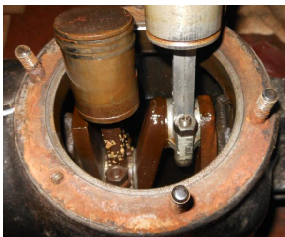
Рисунок Б.35 – Осмотр уплотнительной поверхности картера, сопрягаемой с блоком цилиндров
