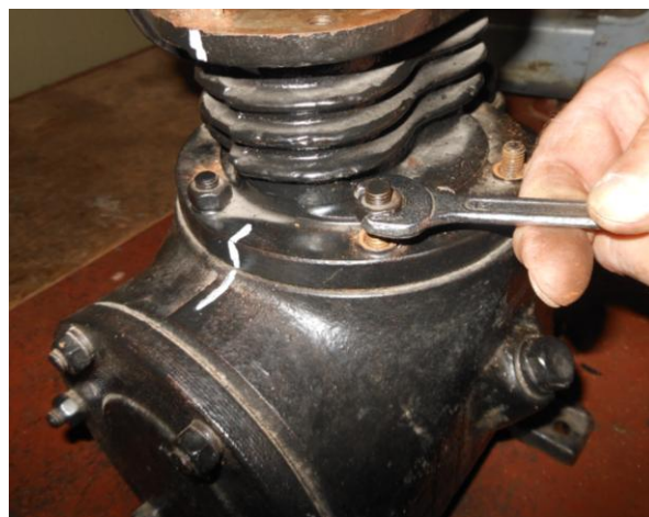
Рисунок Б.32 – Ослабление затяжки гаек крепления блока цилиндров к картеру
