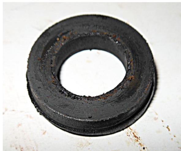
Рисунок Б.59 – Осмотр уплотнительного вращающегося кольца
