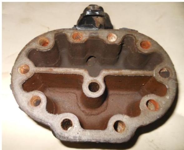
Рисунок Б.7 – Осмотр уплотнительной поверхности крышки цилиндров
