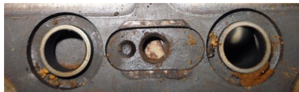
Рисунок Б.18 – Осмотр седел нагнетательных клапанов
