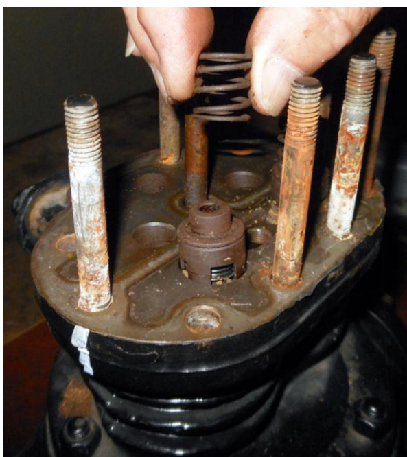
Рисунок Б.11 – Снятие буферной пружины нагнетательного клапана
