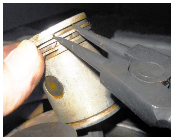
Рисунок Б.44 – Снятие верхнего поршневого кольца с помощью клещей
