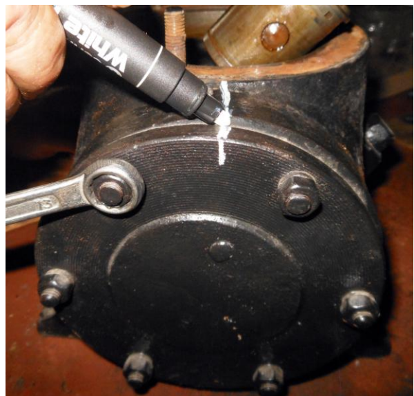
Рисунок Б.62 – Маркировка положения задней опоры относительно картера
