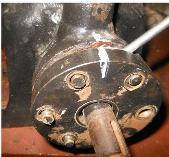
Рисунок Б.50 – Снятие крышки уплотнения коленчатого вала
