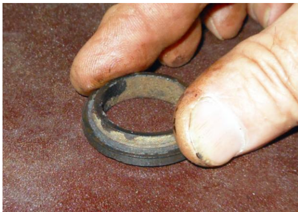
Рисунок Б.55 – Шлифовка неподвижного графитового кольца
