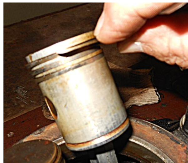
Рисунок Б.43 – Замер зазора "кольцо-канавка"
