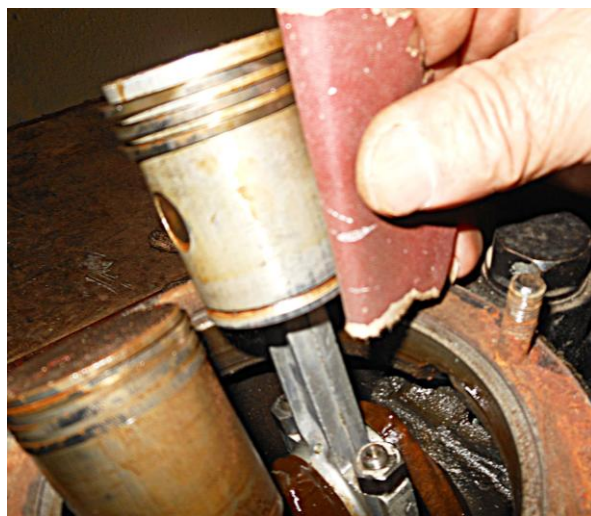
Рисунок Б.41 – Шлифовка рабочей поверхности поршня
