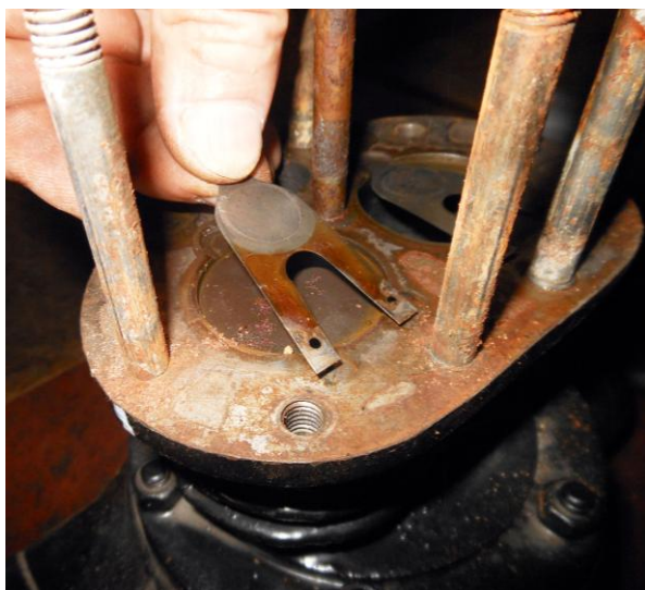
Рисунок Б.24 – Снятие пластин всасывающих клапанов с клапанной доски
