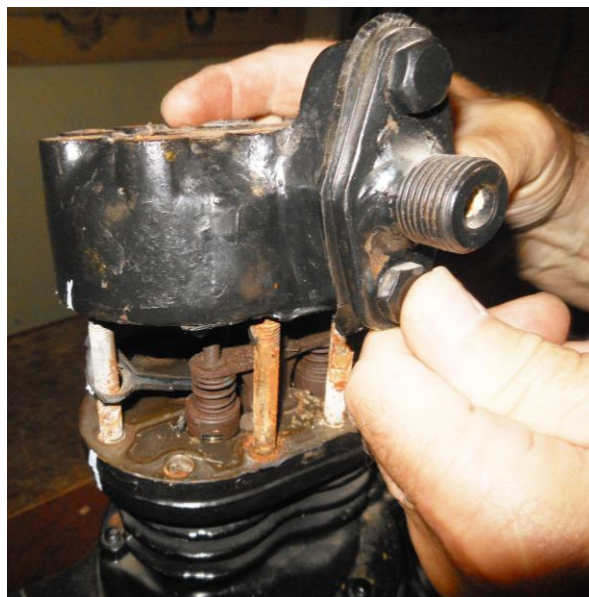
Рисунок Б.5 – Снятие крышки цилиндров с клапанной доски
