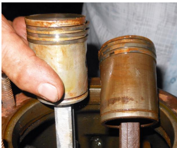
Рисунок Б.46 – Смазывание маслом рабочей поверхности поршня
