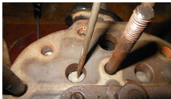
Рисунок Б.30 – Проверка подвижности пластин всасывающего клапана
