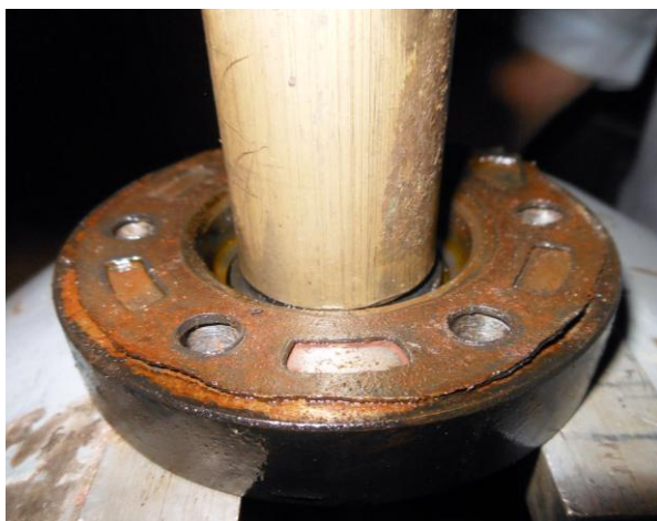
Рисунок Б.56 – Запрессовка неподвижного графитового кольца в крышку
