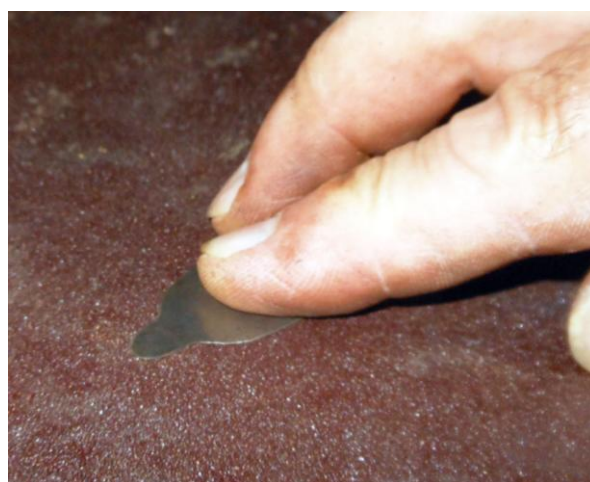
Рисунок Б.26 – Шлифовка пластины всасывающего клапана
