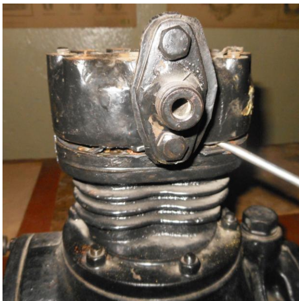
Рисунок Б.5 – Снятие крышки цилиндров с клапанной доски
