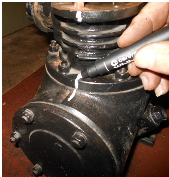
Рисунок Б.31 – Маркировка положения блока цилиндров относительно картера
