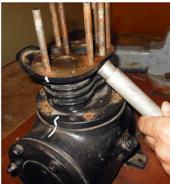
Рисунок Б.33 – Снятие блока цилиндров с картера
