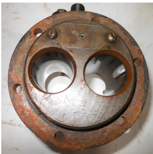
Рисунок Б.34 – Осмотр уплотнительной поверхности блока цилиндров, сопрягаемой с картером
