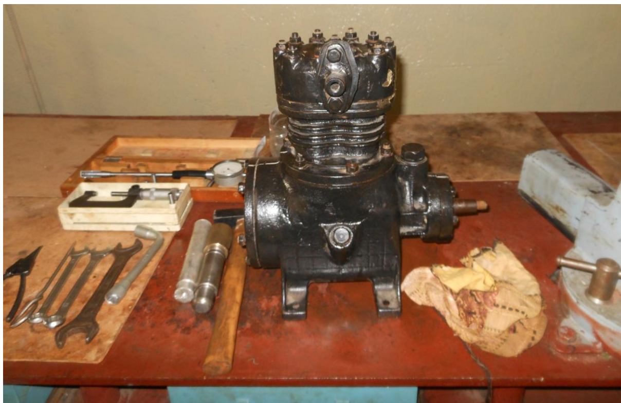
Рисунок 1 – Рабочее место для переборки поршневого компрессора типа ФВ-4
