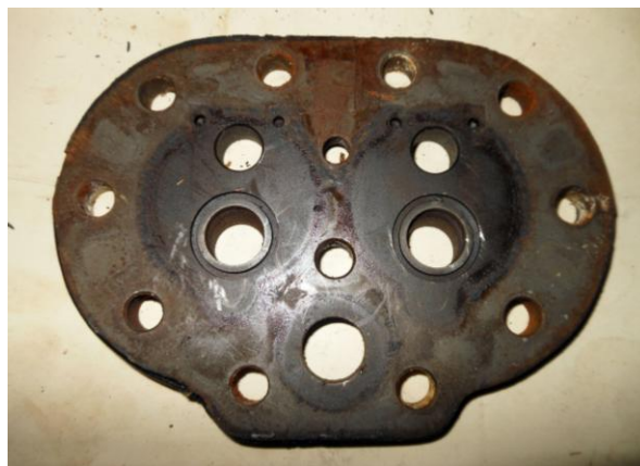
Рисунок Б.22 – Осмотр уплотнительной поверхности клапанной доски со стороны блока цилиндров
