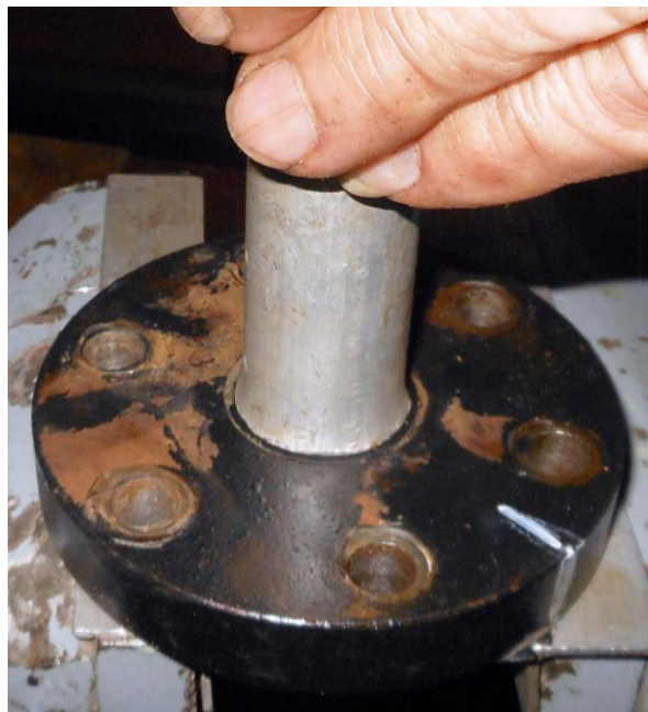
Рисунок Б.54 – Выпрессовка неподвижного графитового кольца из крышки
