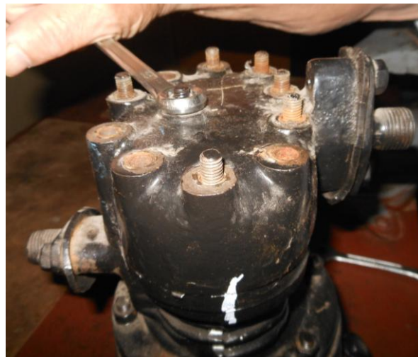
Рисунок Б.3 – Ослабление затяжки и скручивание гаек шпилек крепления крышки цилиндров
