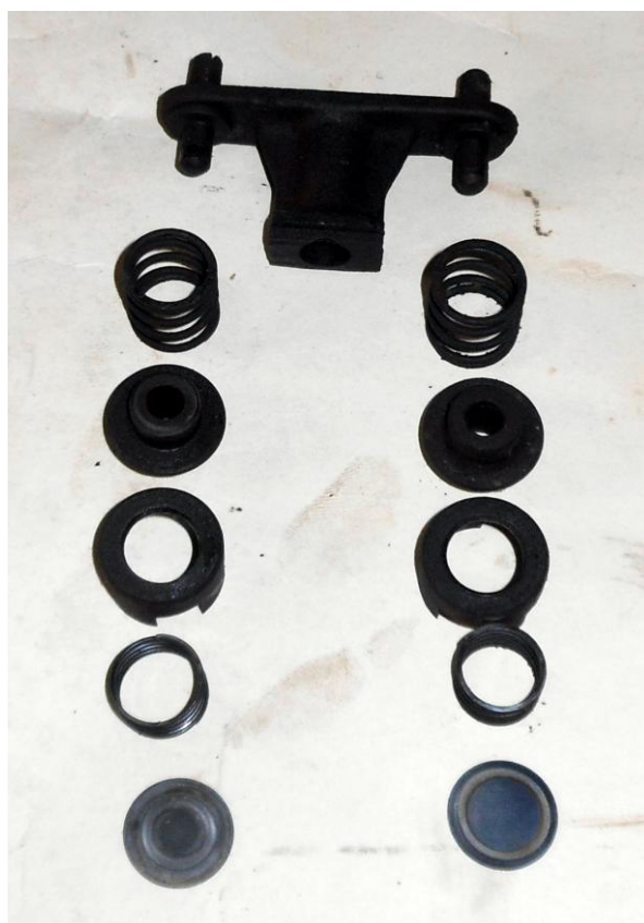
Рисунок Б.16 – Нагнетательные клапаны в разобранном виде
