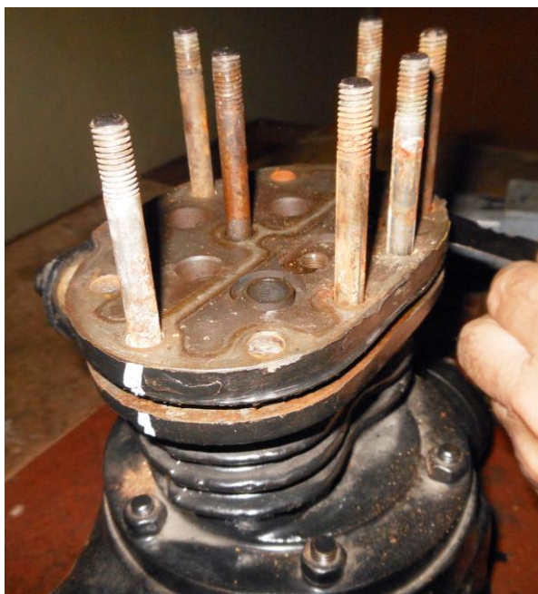
Рисунок Б.20 – Снятие клапанной доски с блока цилиндров
