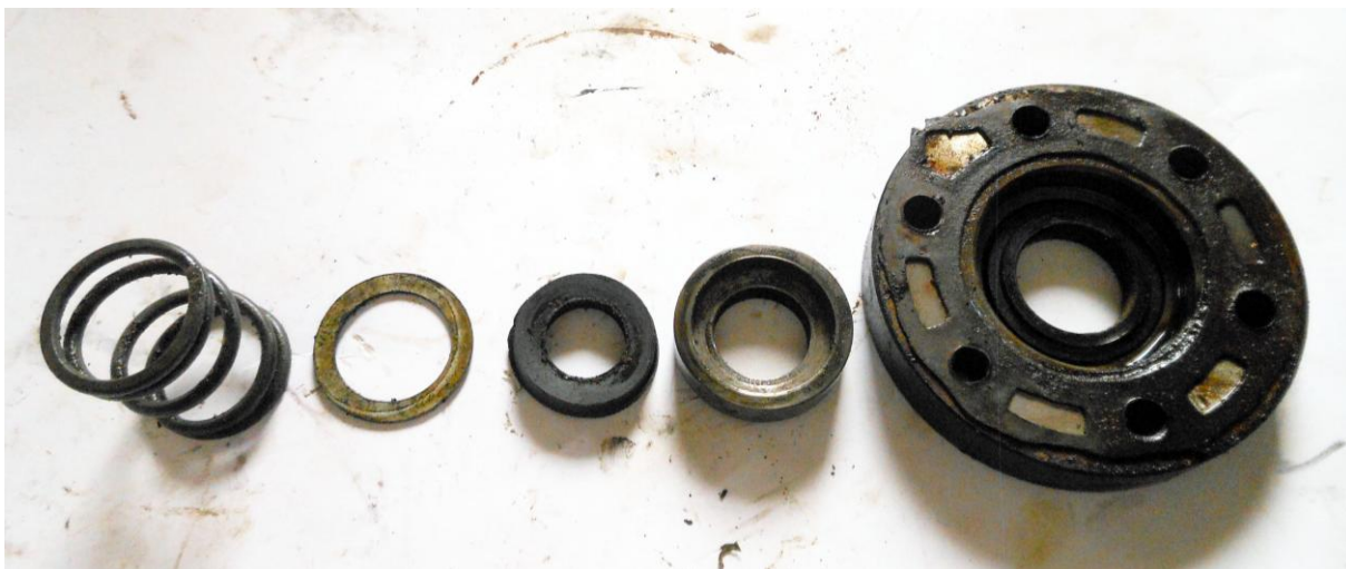
Рисунок Б.52 – Механическое торцовое уплотнение коленчатого вала в разобранном виде
