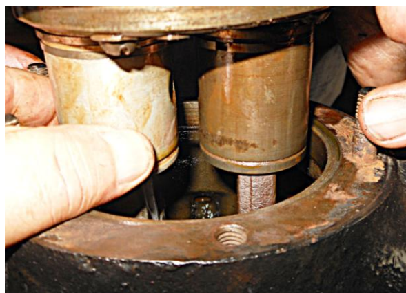
Рисунок Б.47 – Заведение блока цилиндров на поршни
