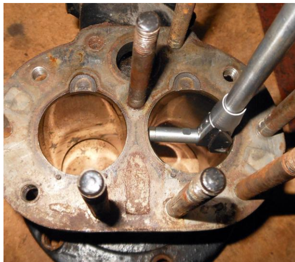
Рисунок Б.39 – Обмер цилиндра индикаторным нутромером
