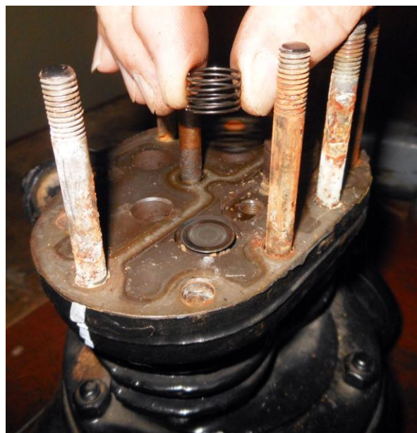
Рисунок Б.14 – Снятие пружины нагнетательного клапана
