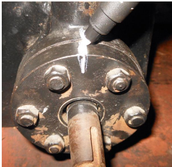
Рисунок Б.48 – Маркировка положения крышки уплотнения относительно корпуса подшипника и картера
