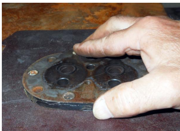
Рисунок Б.23 – Шлифовка уплотнительной поверхности клапанной доски со стороны блока цилиндров
