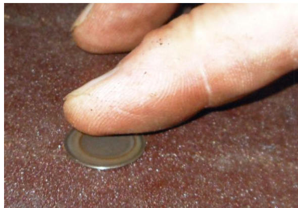
Рисунок Б.19 – Шлифовка пластины нагнетательного клапана
