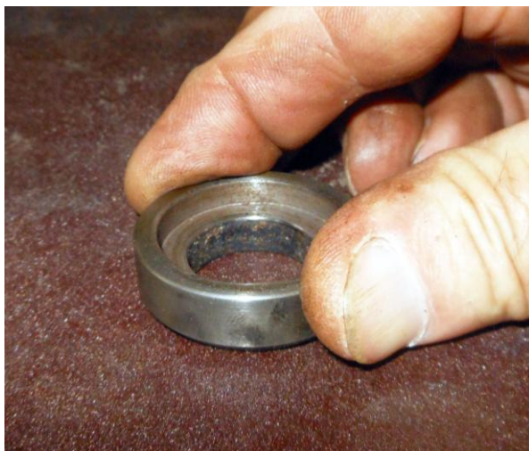
Рисунок Б.58 – Шлифовка торцевой рабочей поверхности обоймы
