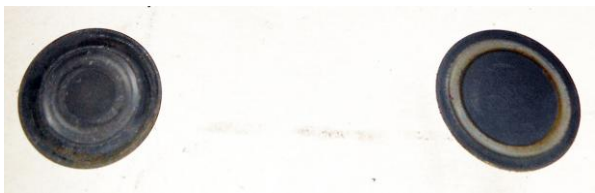
Рисунок Б.17 – Осмотр пластин нагнетательных клапанов
