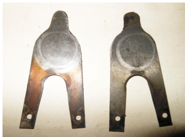
Рисунок Б.25 – Осмотр пластин всасывающих клапанов
