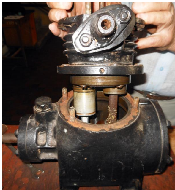
Рисунок Б.33 – Снятие блока цилиндров с картера
