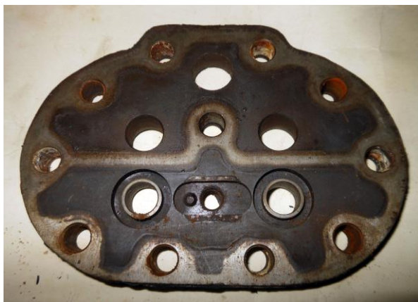
Рисунок Б.21 – Осмотр уплотнительной поверхности клапанной доски со стороны крышки цилиндров
