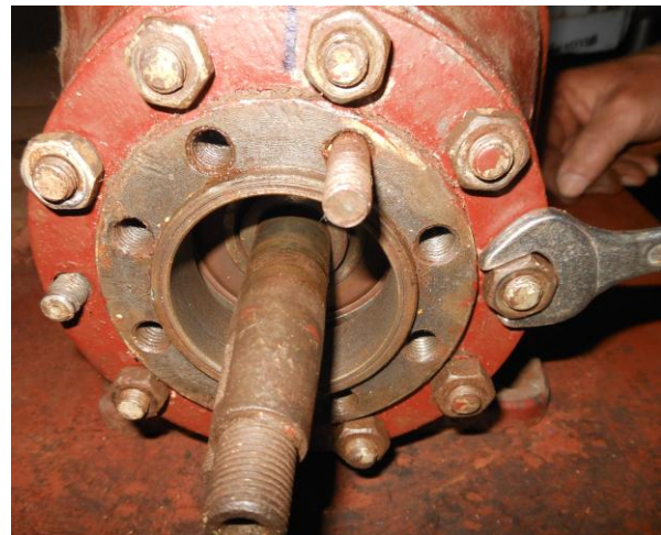
Рисунок Б.69 – Ослабление затяжки гаек крепления корпуса шарикоподшипника к картеру
