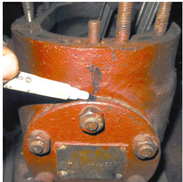
Рисунок Б.63 – Маркировка положения крышки роликоподшипника относительно картера
