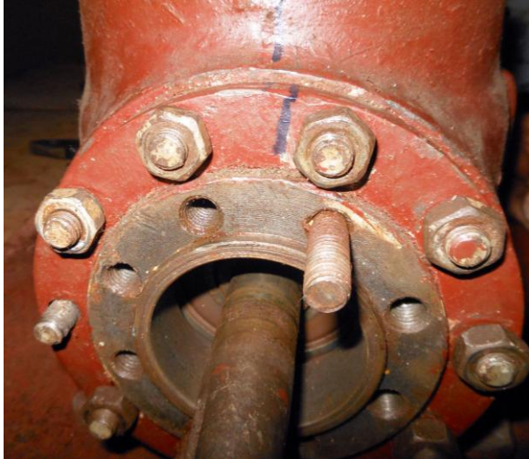
Рисунок Б.68 – Маркировка положения корпуса шарикоподшипника относительно картера
