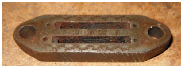
Рисунок Б.15 – Осмотр уплотнительной поверхности седла всасывающего клапана
