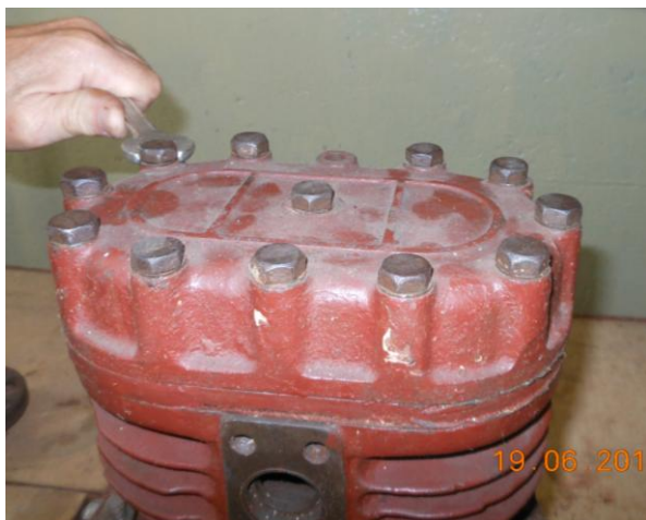
Рисунок Б.3 – Ослабление затяжки болтов крепления крышки цилиндров
