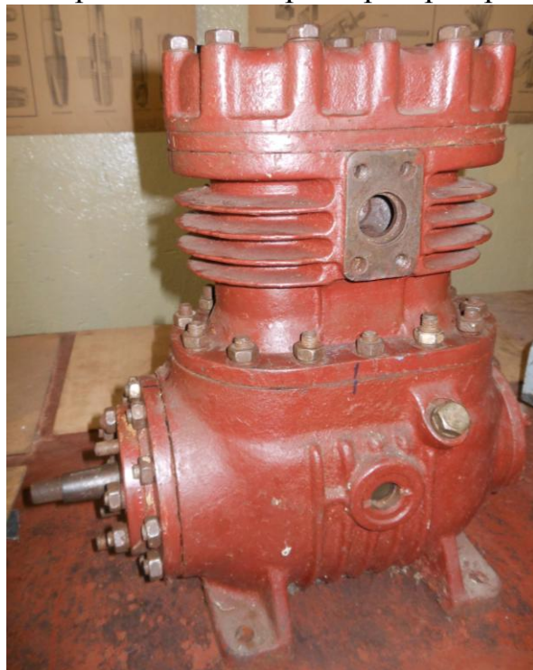
Рисунок Б.1 – Общий вид компрессора типа ФВ-6
