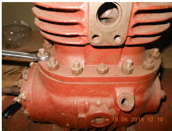
Рисунок Б.35 – Ослабление затяжки гаек крепления блока цилиндров к картеру
