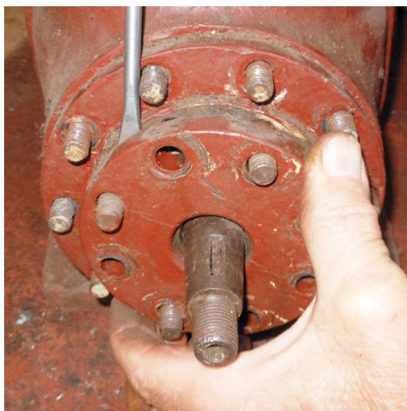
Рисунок Б.51 – Снятие крышки уплотнения коленчатого вала
