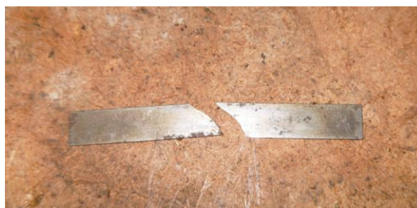
Рисунок Б.14 – Пример треснувшей пластины всасывающего клапана
