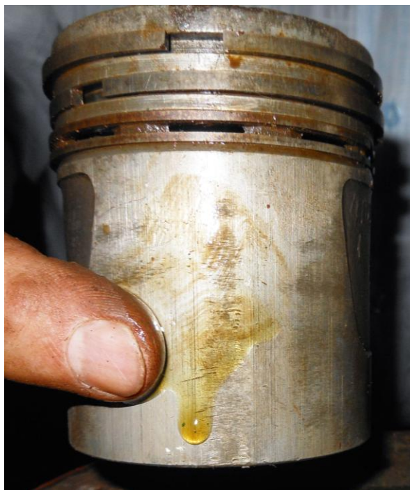
Рисунок Б.47 – Смазывание маслом рабочей поверхности втулки цилиндра и поршня
