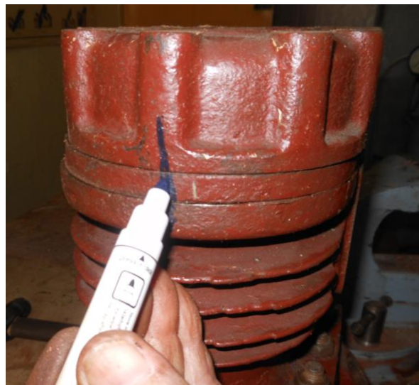
Рисунок Б.2 – Маркировка взаимного положения крышки цилиндров и клапанной плиты относительно блока цилиндров
