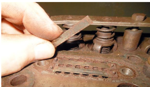
Рисунок Б.12 – Снятие пластин всасывающих клапанов с клапанной доски
