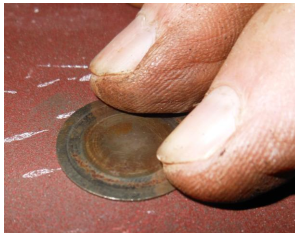
Рисунок Б.26 – Шлифовка пластины нагнетательного клапана
