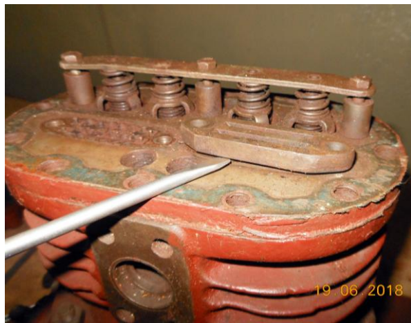
Рисунок Б.11 – Снятие седел всасывающих клапанов с клапанной доски
