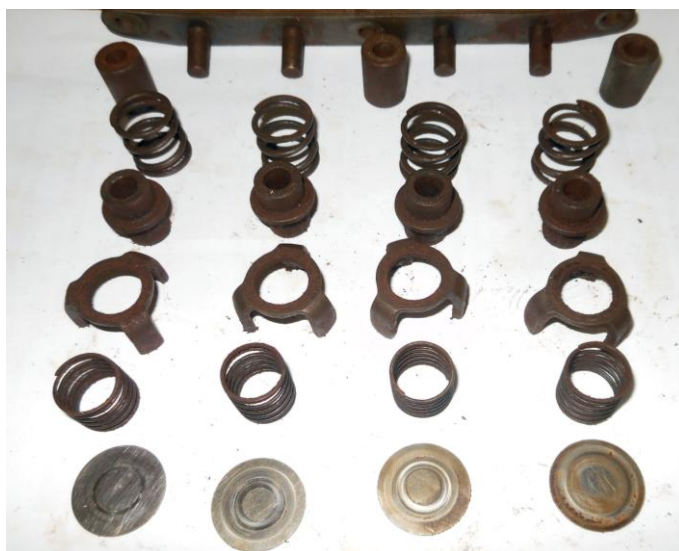
Рисунок Б.23 – Нагнетательные клапаны в разобранном виде
