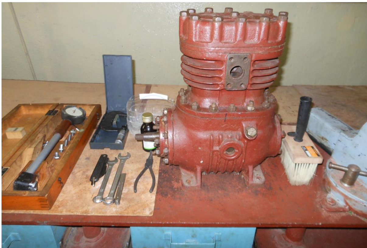
Рисунок 1 – Рабочее место для переборки поршневого компрессора типа ФВ-6
