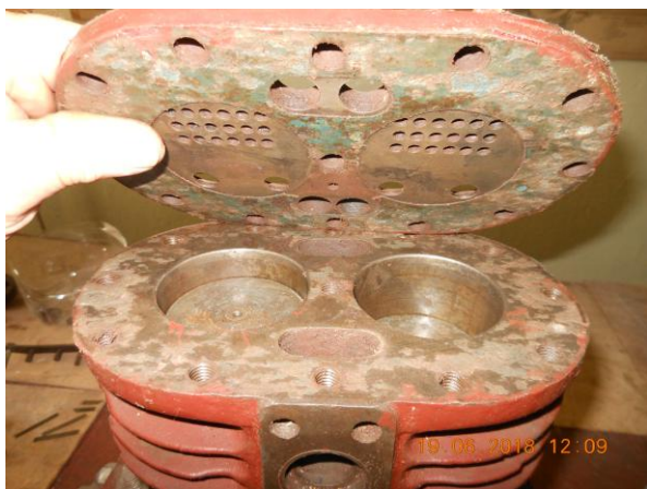
Рисунок Б.27 – Снятие клапанной доски с блока цилиндров
