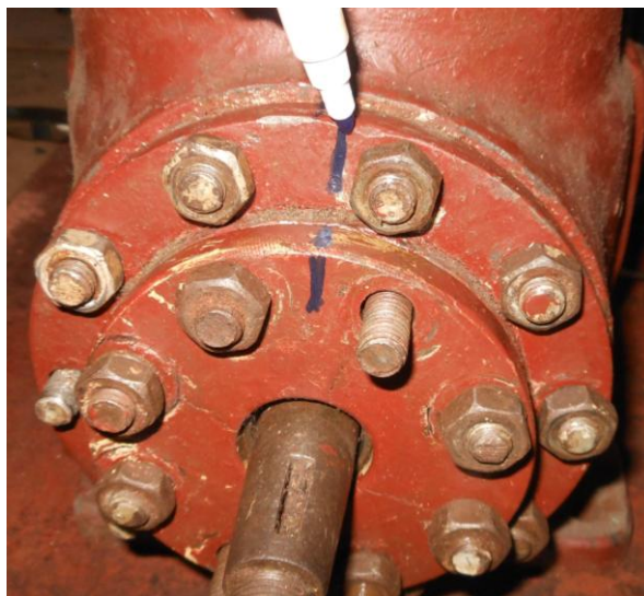
Рисунок Б.49 – Маркировка положения крышки уплотнения относительно корпуса подшипника и картера
