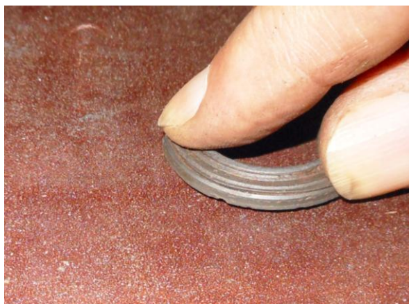
Рисунок Б.56 – Шлифовка неподвижного графитового кольца
