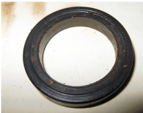
Рисунок Б.60 – Осмотр уплотнительного вращающегося кольца
