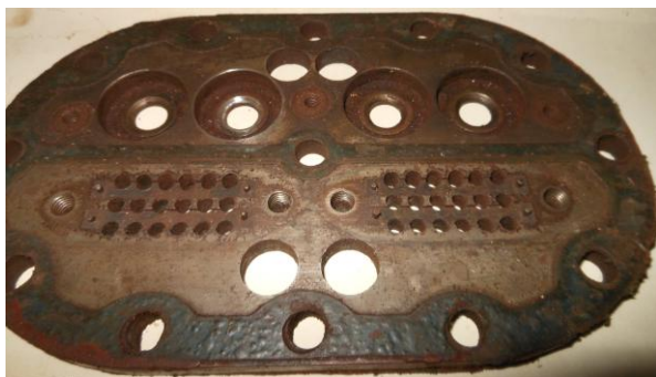
Рисунок Б.28 – Осмотр уплотнительной поверхности клапанной доски со стороны крышки цилиндров
