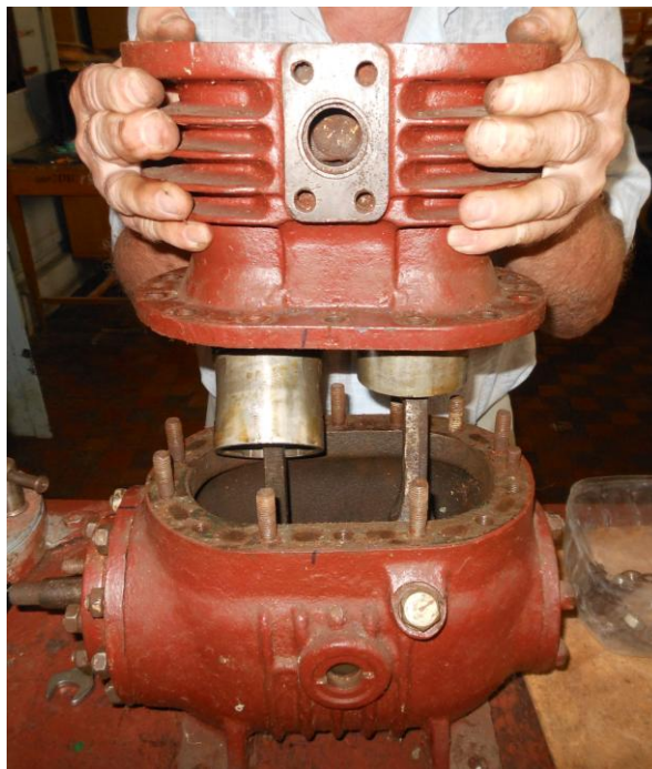
Рисунок Б.36 – Снятие блока цилиндров с картера
