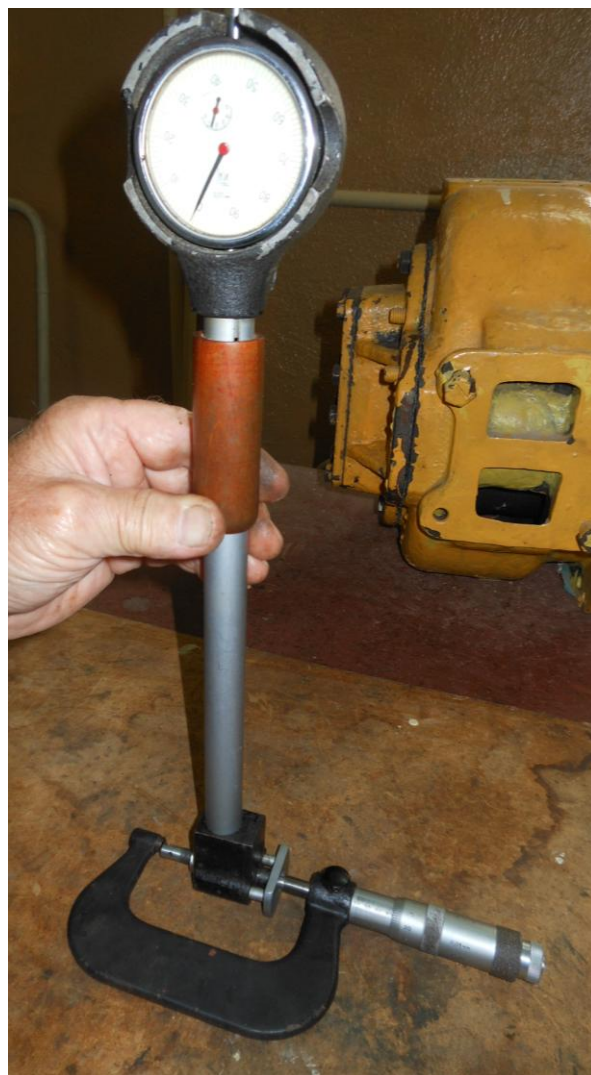
Рисунок Б.41 – Выставление установочного размера индикаторного нутромера
