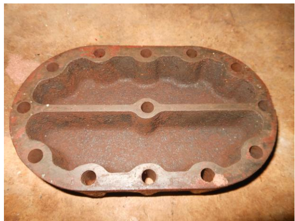
Рисунок Б.7 – Осмотр уплотнительной поверхности крышки цилиндров
