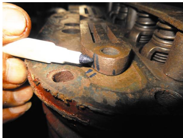
Рисунок Б.9 – Маркировка положения седел всасывающих клапанов относительно клапанной доски
