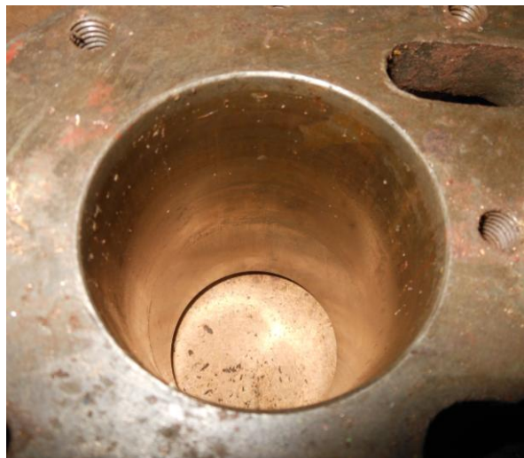
Рисунок Б.39 – Осмотр рабочей поверхности цилиндра
