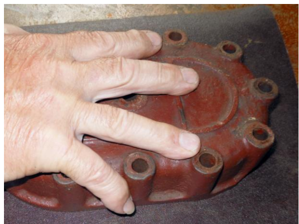
Рисунок Б.8 – Шлифовка уплотнительной поверхности крышки цилиндров
