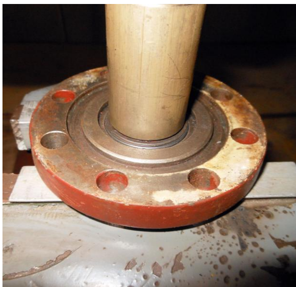
Рисунок Б.57 – Запрессовка неподвижного графитового кольца в крышку
