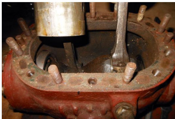
Рисунок Б.38 – Осмотр уплотнительной поверхности картера, сопрягаемой с блоком цилиндров
