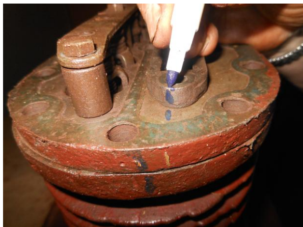
Рисунок Б.9 – Маркировка положения седел всасывающих клапанов относительно клапанной доски
