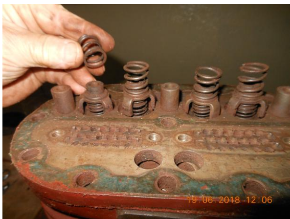
Рисунок Б.19 – Снятие буферной пружины нагнетательного клапана
