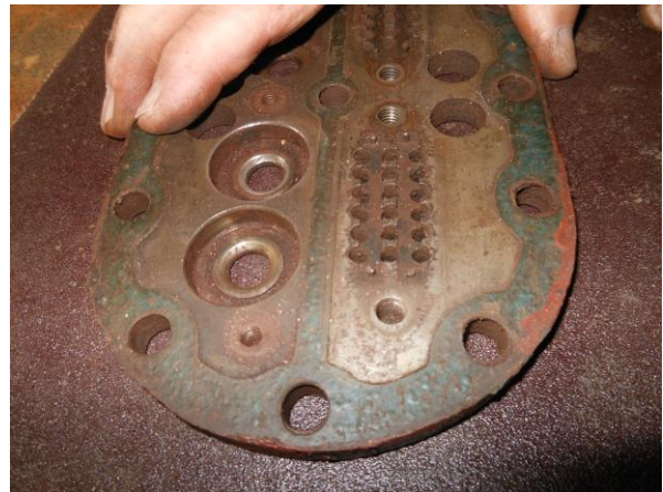
Рисунок Б.30 – Шлифовка уплотнительной поверхности клапанной доски со стороны блока цилиндров
