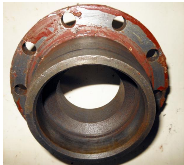
Рисунок Б.75 – Смазывание посадочных поверхностей корпуса шарикоподшипника
