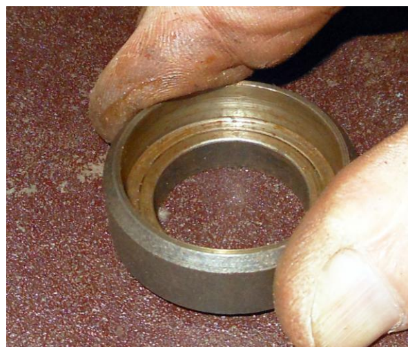
Рисунок Б.59 – Шлифовка торцовой рабочей поверхности обоймы
