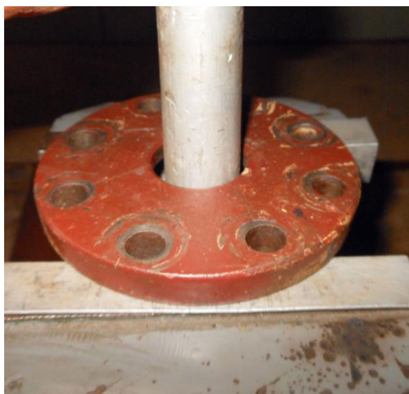
Рисунок Б.55 – Выпрессовка неподвижного графитового кольца из крышки
