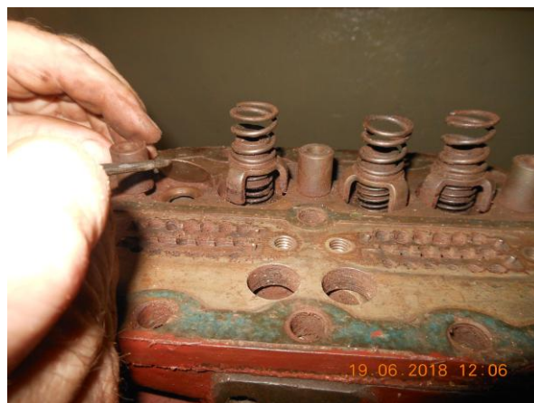
Рисунок Б.22 – Снятие пластины нагнетательного клапана
