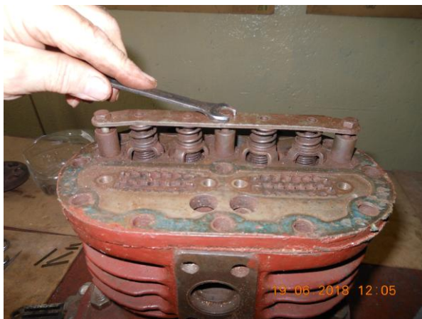
Рисунок Б.17 – Откручивание болтов крепления траверсы нагнетательных клапанов к клапанной доске
