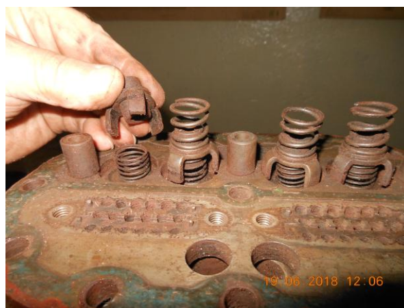
Рисунок Б.20 – Снятие буфера с розеткой нагнетательного клапана
