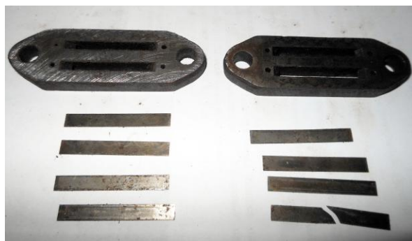
Рисунок Б.13 – Всасывающие клапаны в разобранном виде
