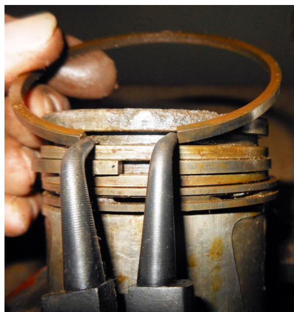
Рисунок Б.46 – Снятие верхнего поршневого кольца с помощью клещей
