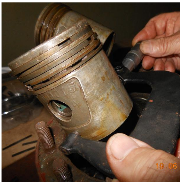
Рисунок Б.44 – Обмер тронка поршня
