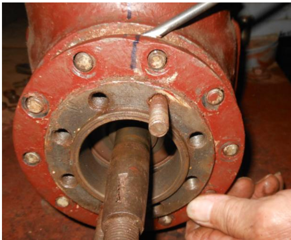
Рисунок Б.70 – Отжатие корпуса шарикоподшипника от картера
