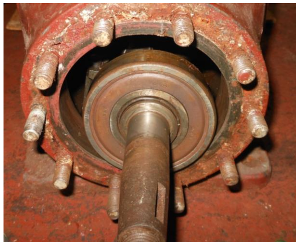
Рисунок Б.72 – Вид выхода коленчатого вала из картера без корпуса шарикоподшипника
