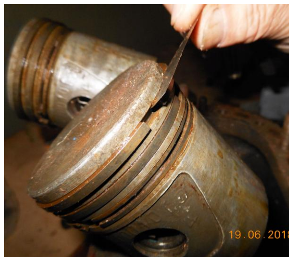
Рисунок Б.45 – Замер зазора "кольцо-канавка"
