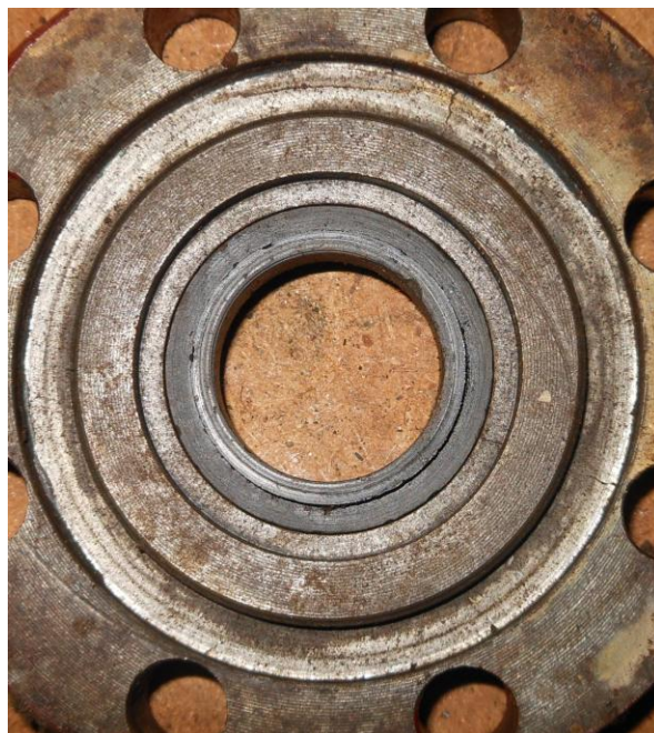
Рисунок Б.54 – Осмотр неподвижного графитового кольца в крышке
