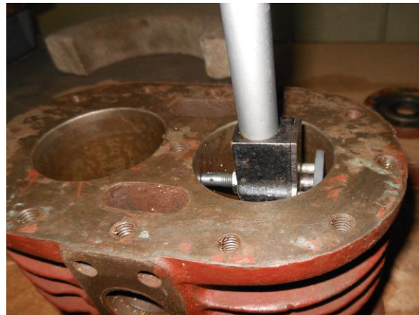
Рисунок Б.42 – Обмер цилиндра индикаторным нутромером
