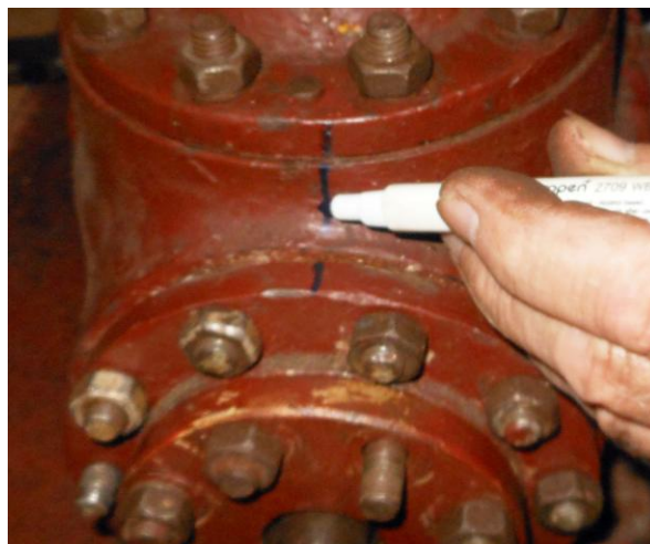
Рисунок Б.34 – Маркировка положения блока цилиндров относительно картера
