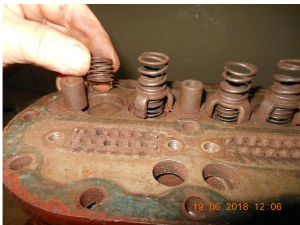
Рисунок Б.21 – Снятие пружины нагнетательного клапана
