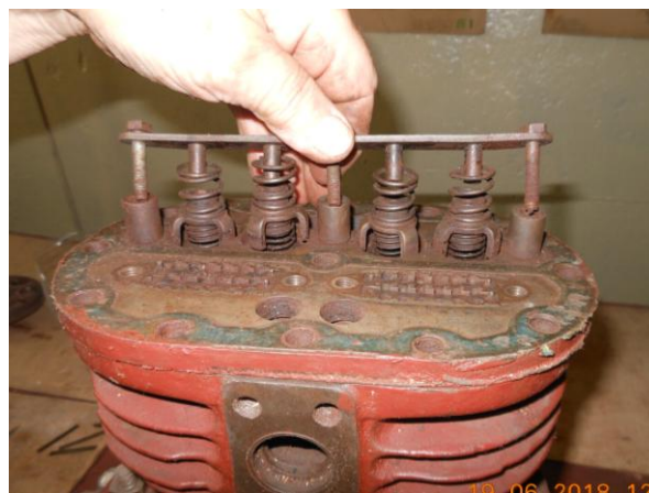
Рисунок Б.18 – Снятие траверсы крепления нагнетательных клапанов к клапанной доске
