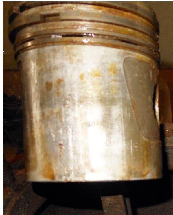
Рисунок Б.43 – Осмотр рабочей поверхности поршня
