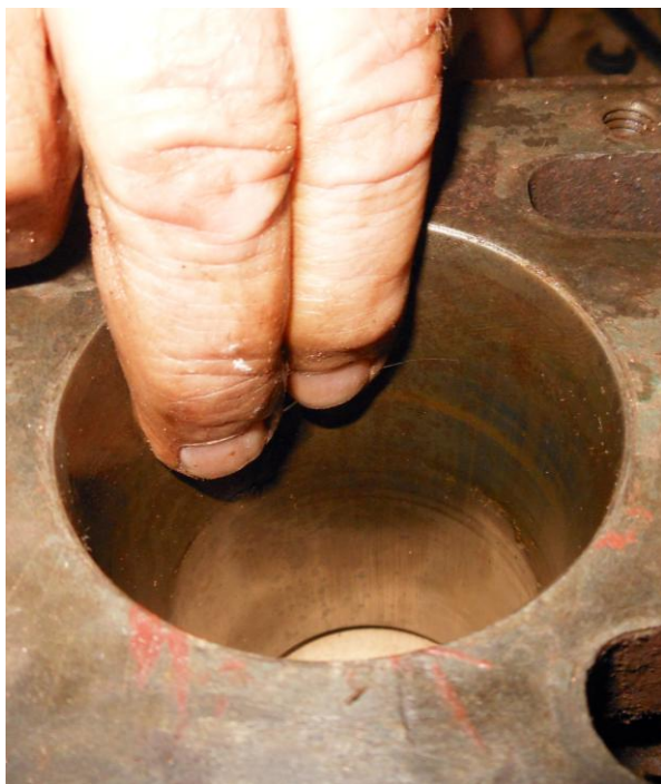
Рисунок Б.47 – Смазывание маслом рабочей поверхности втулки цилиндра и поршня
