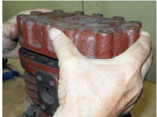
Рисунок Б.6 – Снятие крышки цилиндров с клапанной доски
