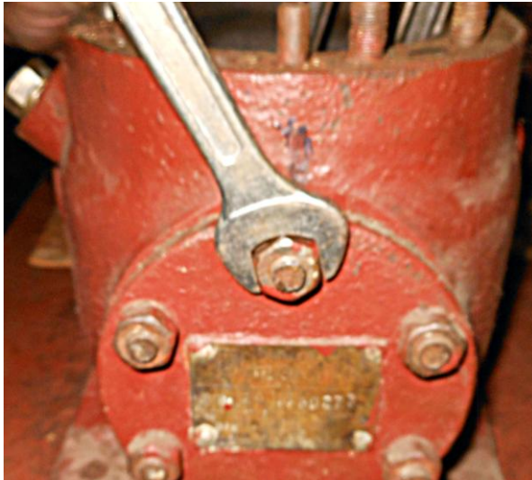
Рисунок Б.64 – Ослабление затяжки гаек крепления крышки роликоподшипника
