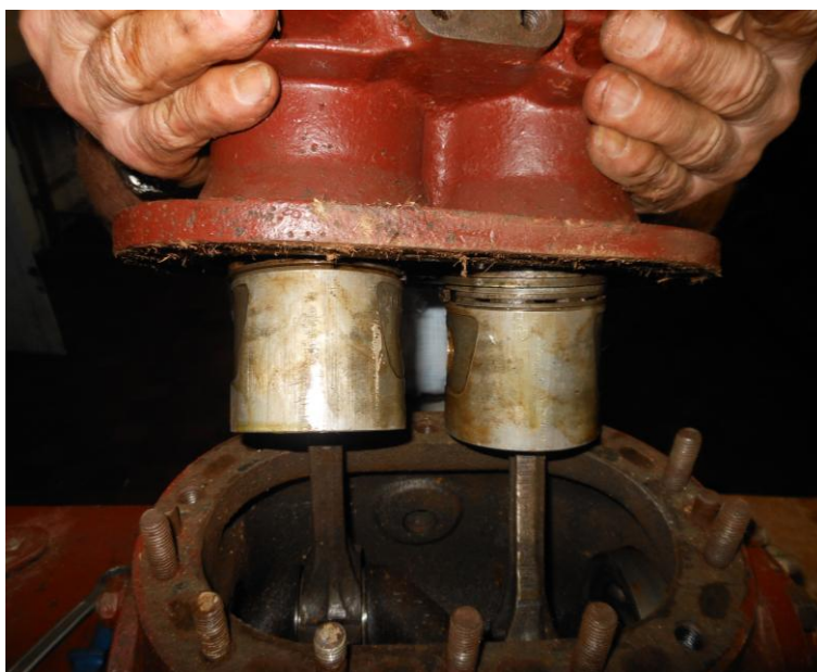
Рисунок Б.48 – Заведение блока цилиндров на поршни
