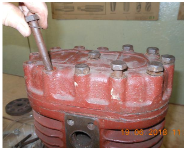
Рисунок Б.4 – Вынимание болтов крепления крышки цилиндров вместе с шайбами
