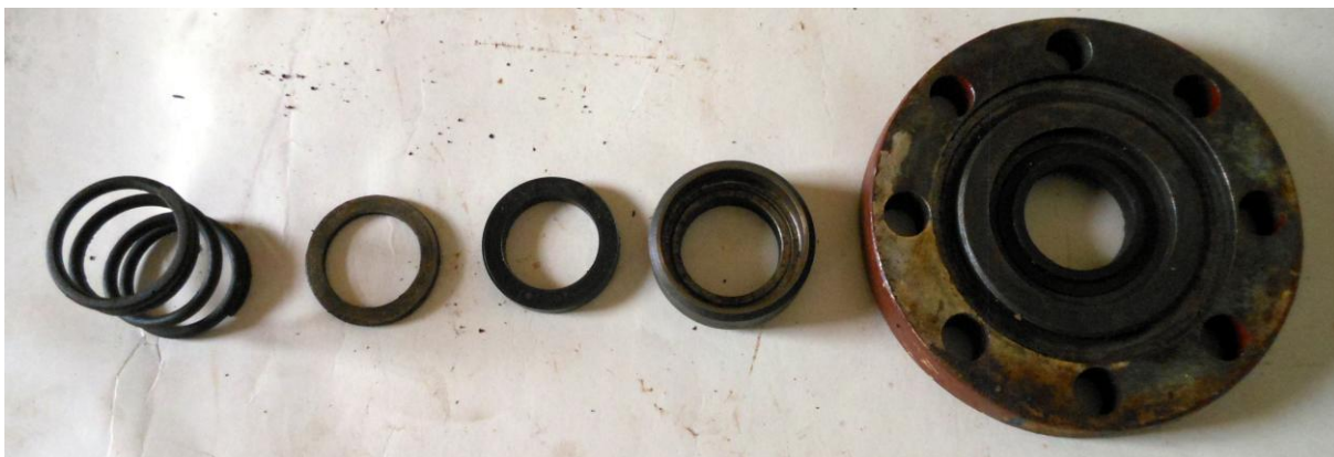
Рисунок Б.53 – Механическое торцовое уплотнение коленчатого вала в разобранном виде
