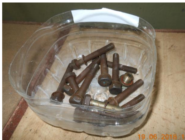
Рисунок Б.5 – Складывание крепежа при разборке компрессора
