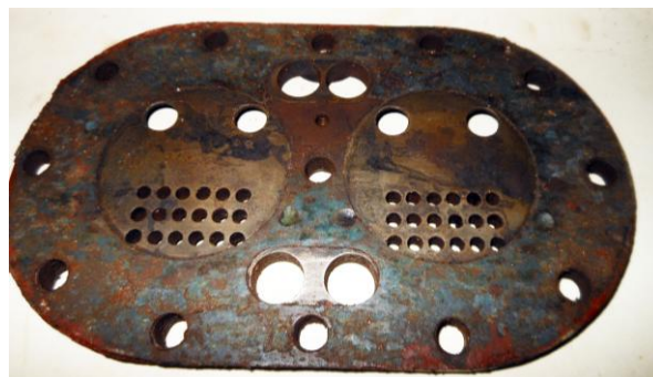
Рисунок Б.29 – Осмотр уплотнительной поверхности клапанной доски со стороны блока цилиндров
