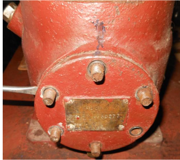
Рисунок Б.65 – Снятие крышки роликоподшипника
