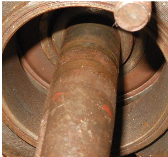
Рисунок Б.61 – Осмотр поверхности вала в районе установки уплотнительного вращающегося кольца
