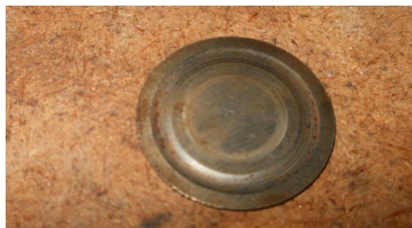
Рисунок Б.25 – Осмотр пластины нагнетательного клапана
