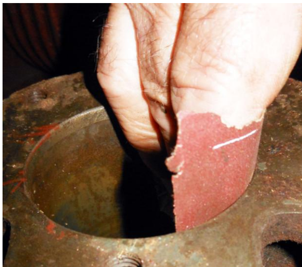
Рисунок Б.40 – Зачистка рабочей поверхности цилиндра наждачной бумагой
