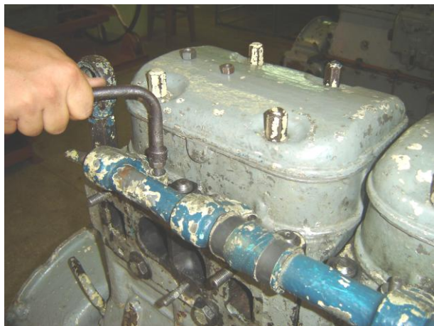
Рисунок Б.6 – Демонтаж трубопровода охлаждающей воды
