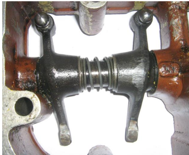
Рисунок Б.38 – Осмотр коромысел
