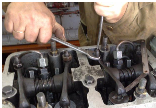
Стопорение регулировочного винта
