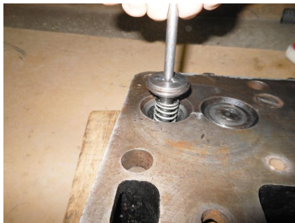
Рисунок Б.40 – Совместная притирка клапана и седла
