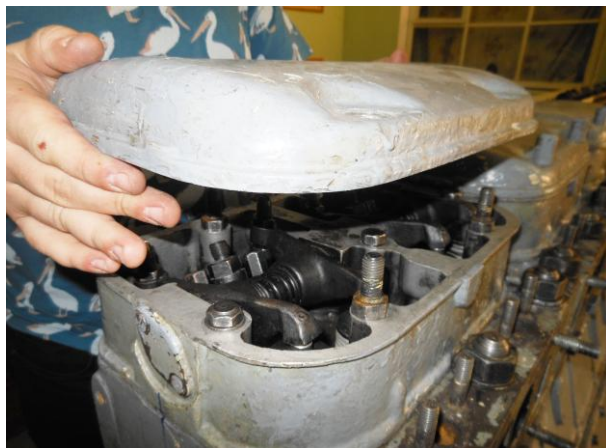
Рисунок Б.7 – Снятие колпака крышки клапанного механизма
