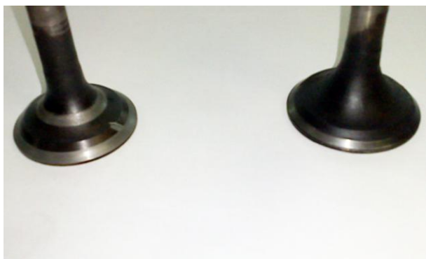
Рисунок Б.26 – Осмотр уплотнительной поверхности тарелок клапанов
