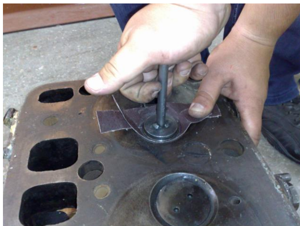
Шлифовка тарелки клапана
