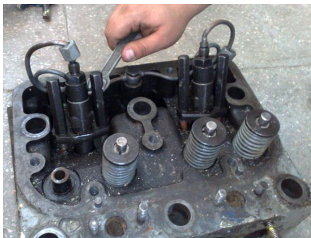
Рисунок Б.19 – Демонтаж форсунки
