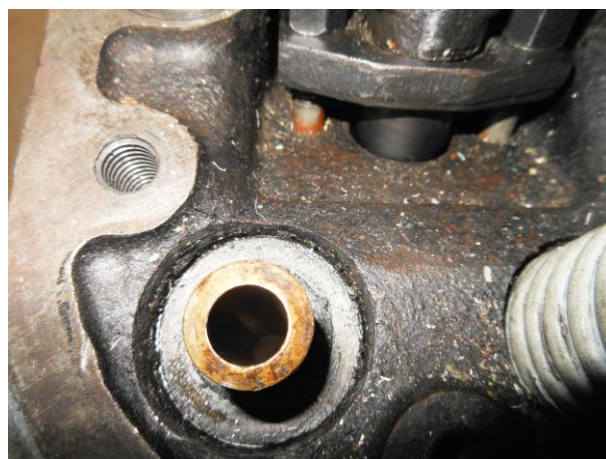
Рисунок Б.29 – Осмотр направляющей клапана
