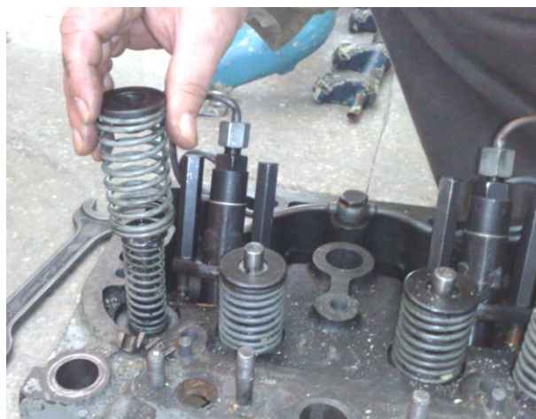
Рисунок Б.22 – Снятие пружин
