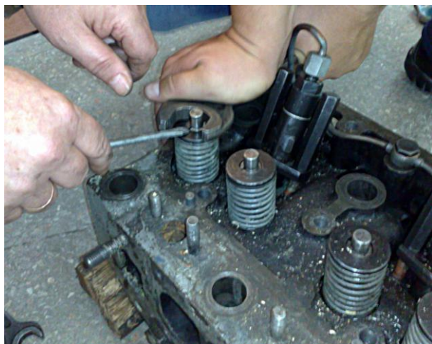
Рисунок Б.21 – Снятие зажимных конусов
