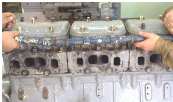
Рисунок Б.6 – Демонтаж трубопровода охлаждающей воды
