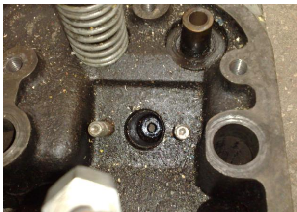
Рисунок Б.20 – Осмотр посадочного места под форсунку
