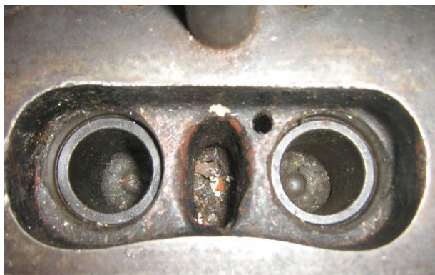
Рисунок Б.37 – Осмотр пят толкателей
