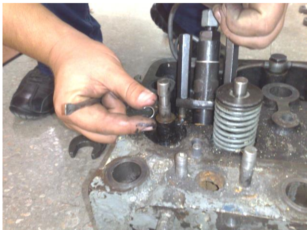
Рисунок Б.23 – Снятие стопорного кольца
