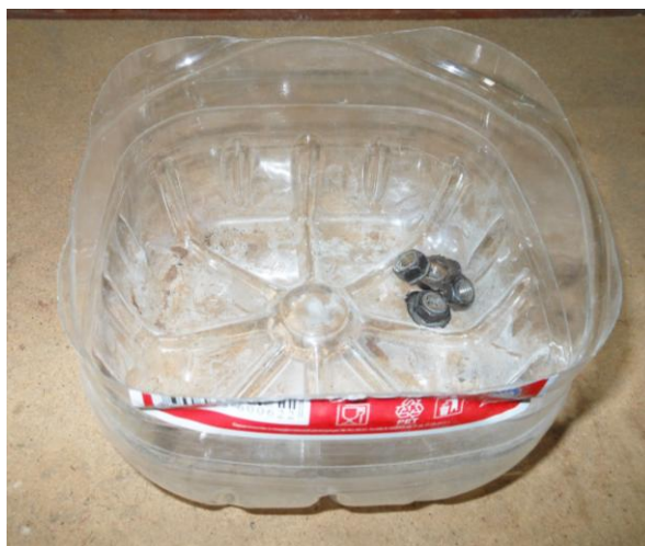
Рисунок Б.4 – Складывание крепежа при демонтаже крышки цилиндра
