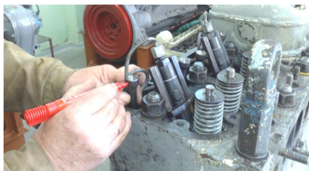
Рисунок Б.10 – Маркировка и демонтаж штанг толкателей клапанов
