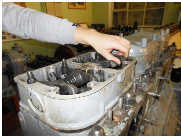
Рисунок Б.8 – Установка коленвала в положение закрытых впускных и выпускных клапанов
