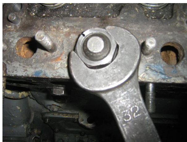
Рисунок Б.45 – Затяжка гаек крепления крышки цилиндра до отказа
