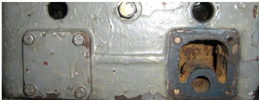
Рисунок Б.17 – Осмотр полостей охлаждения крышки цилиндров
