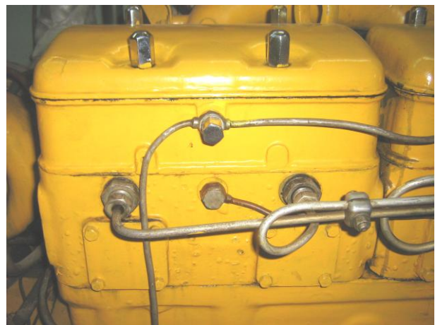
Рисунок Б.2 – Отсоединение топливных и масляных трубок
