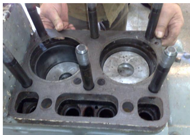
Рисунок Б.13 – Снятие прокладки с блока цилиндров
