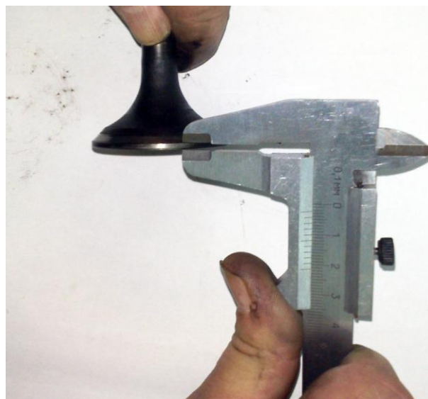
Рисунок Б.31 – Замер высоты тарелки клапана
