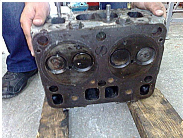
Рисунок Б.12 – Установка крышки цилиндров на деревянные брусья
