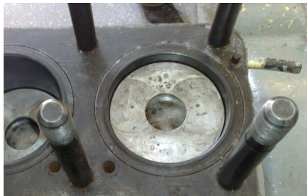
Рисунок Б.14 – Осмотр шпилек крепления крышки цилиндров
