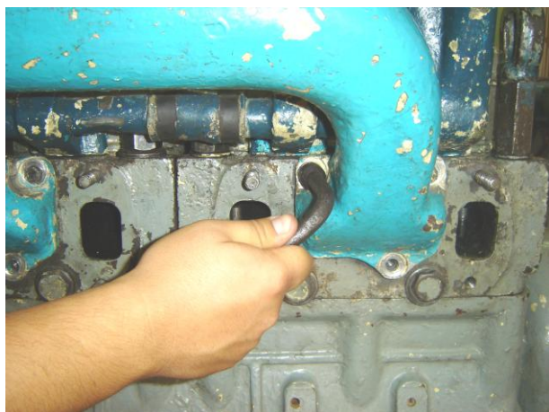
Рисунок Б.5 – Демонтаж нагнетательного коллектора
