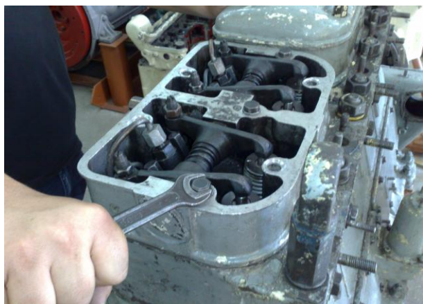
Рисунок Б.9 – Демонтаж крышки клапанного механизма
