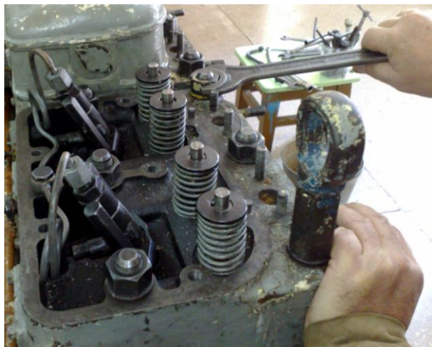
Рисунок Б.11 – Демонтаж крышки цилиндров
