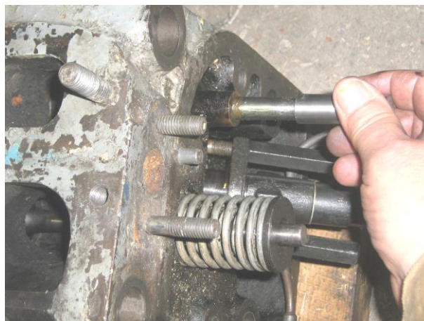
Рисунок Б.34 – Обмер направляющей ступенчатым калибром
