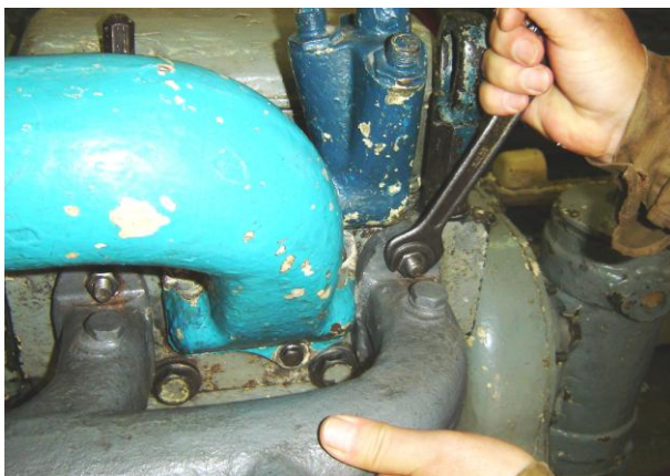
Рисунок Б.3 – Демонтаж коллектора выпускных газов
