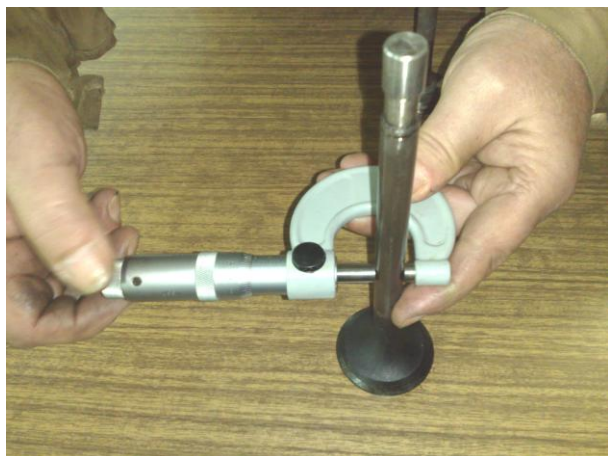
Рисунок Б.33 – Обмер штока клапана микрометрической скобой
