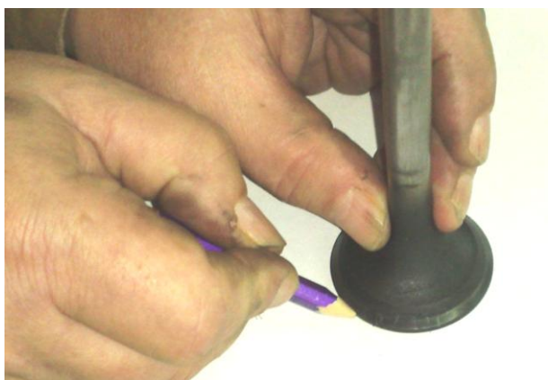
Рисунок Б.41 – Проверка качества притирки "на карандаш"
