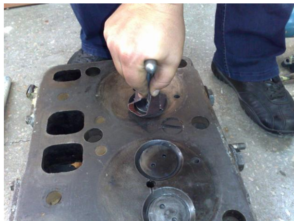
Шлифовка седла клапана
