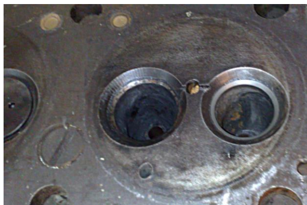
Рисунок Б.16 – Осмотр днища крышки цилиндров
