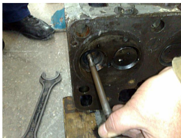
Рисунок Б.24 – Вынимание штока клапана из направляющей
