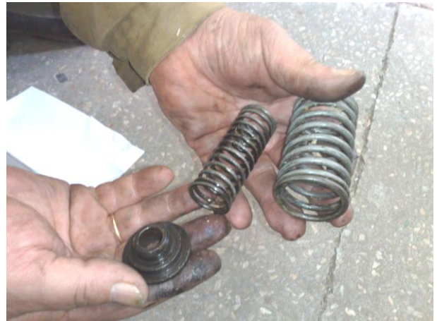
Рисунок Б.35 – Осмотр пружин клапанов
