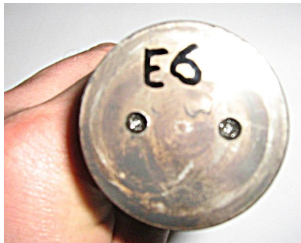
Рисунок Б.25 – Маркировка клапана
