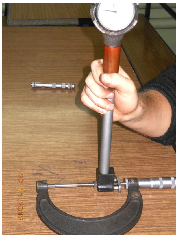
Рисунок Б.20 – Выставление установочного размера индикаторного нутромера
