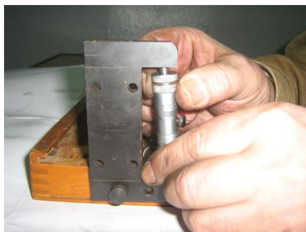
Рисунок Б.18 – Проверка нулевого положения микрометрического нутромера
