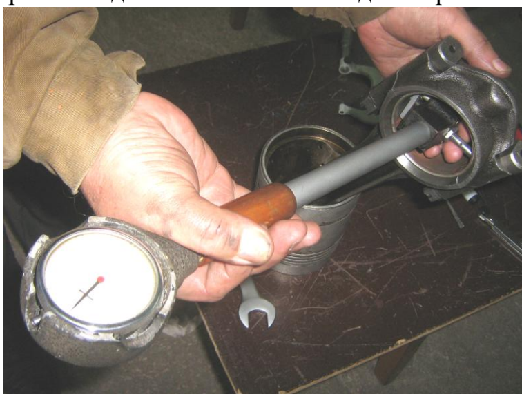
Рисунок Б.52 – Обмер нижней головки шатуна в сборе с вкладышами индикаторным нутромером
