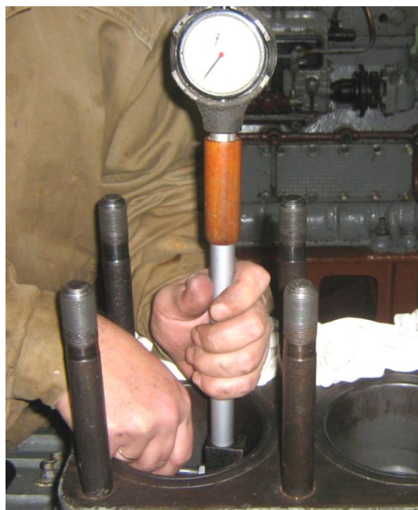
Рисунок Б.21 – Обмер втулки цилиндра индикаторным нутромером
