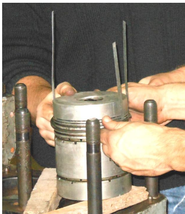
Рисунок Б.28 – Надевание колец на поршень с помощью пластин
