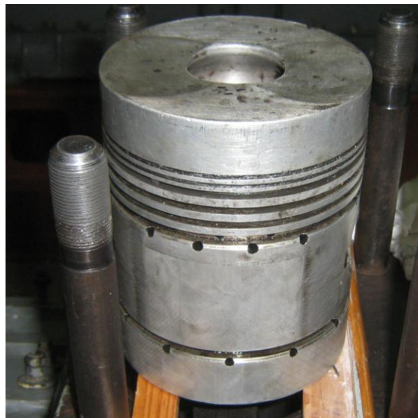
Рисунок Б.23 – Осмотр поверхностей поршня
