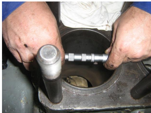
Рисунок Б.19 – Обмер втулки цилиндра микрометрическим нутромером
