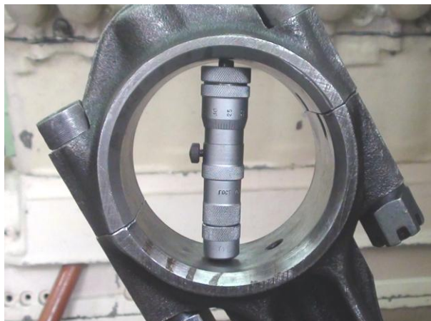
Рисунок Б.49 – Обмер постели нижней головки шатуна микрометрическим нутромером
