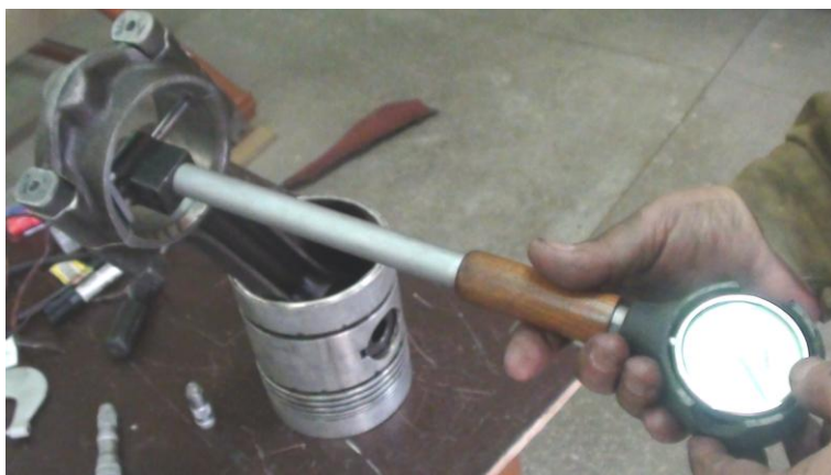
Рисунок Б.50 – Обмер постели нижней головки шатуна индикаторным нутромером
