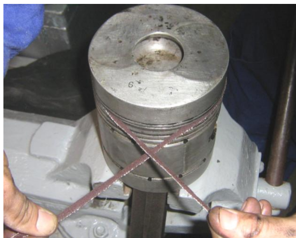
Рисунок Б.22 – Очистка поршневых канавок
