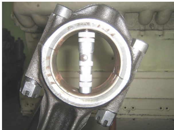
Рисунок Б.51 – Обмер нижней головки шатуна в сборе с вкладышами микрометрическим нутромером
