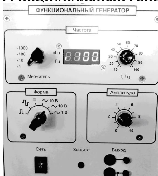
Рис. 15. Вид модуля ФУНКЦИОНАЛЬНЫЙ ГЕНЕРАТОР
