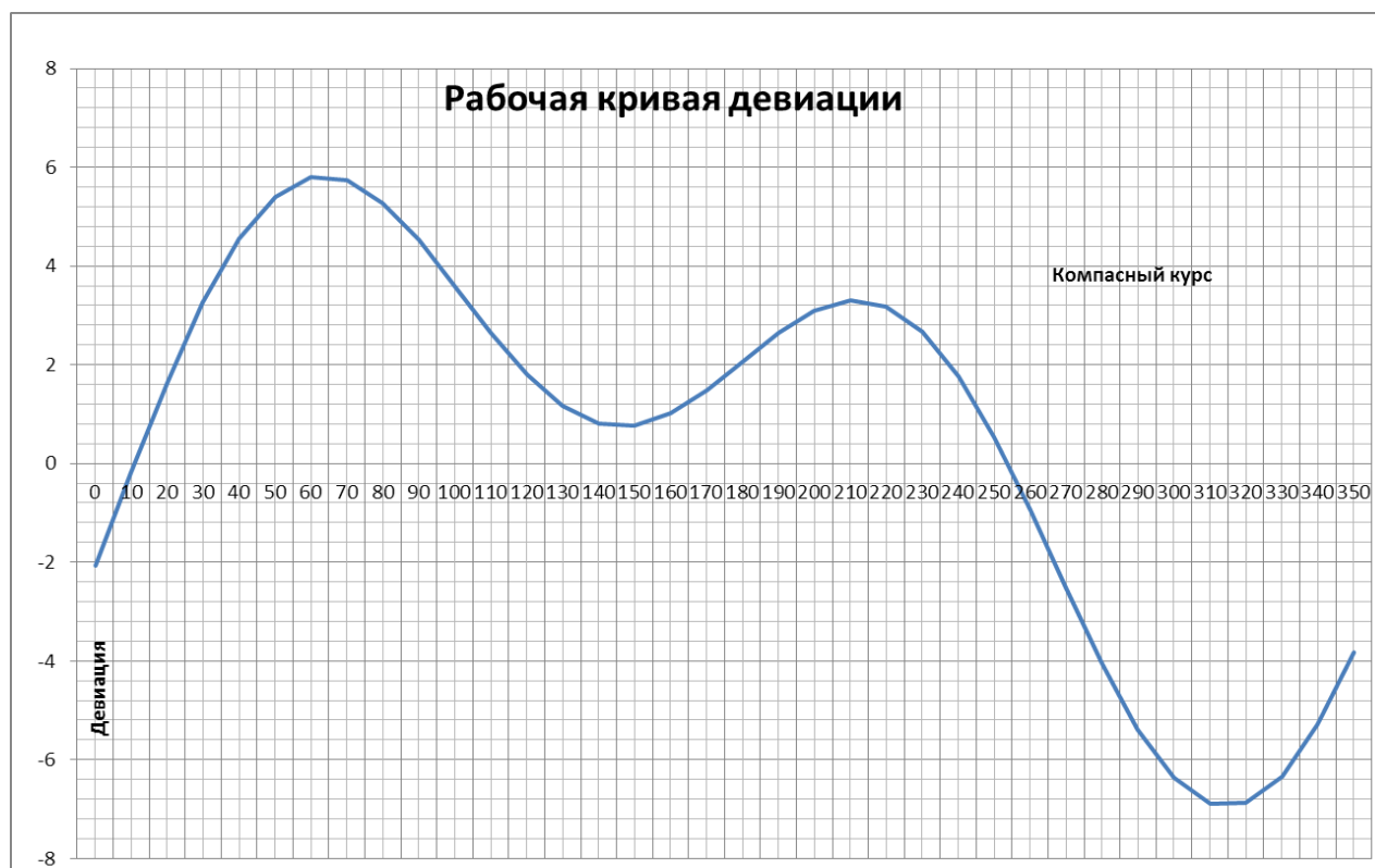
Рис. 3.5 – Результат построения рабочей кривой девиации магнитного компаса
