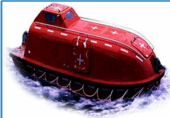
Частично закрытая и полностью закрытая спасательная шлюпка
