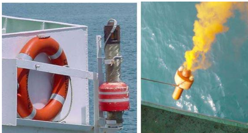
Круг с самозажигающимися огнем и дымовой шашкой
