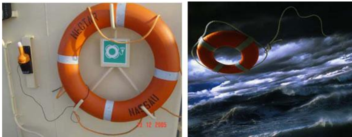
Спасательный круг с самозажигающимся огнем
