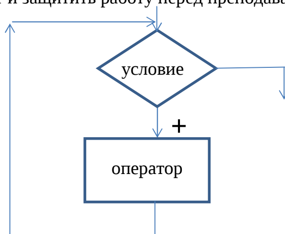
Рисунок 2.15 — Структурная схема цикла «while do»
