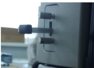
Рис. 2.5. Ручка управления айрисом и регулировки его размера
