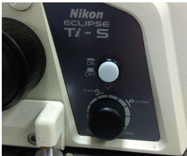
Рис. 2.3. Кнопка включения освещения и ручка регулировки мощности лампы осветителя
