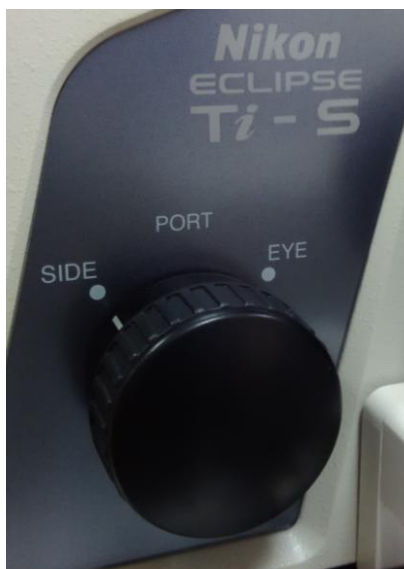
Рис. 2.4. Ручка выбора режима наблюдения образца
