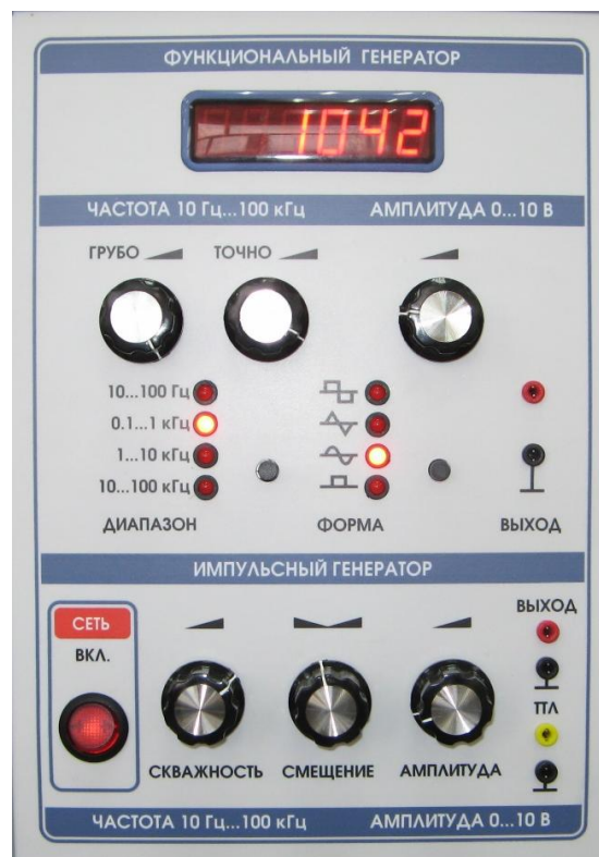
Рис. 6 — Внешний вид модуля «Функциональный генератор»
