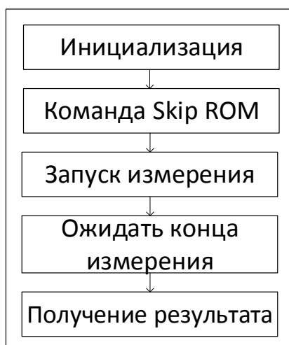
Рис.7.5 — Алгоритм взаимодействия с датчиком для считывания температуры
