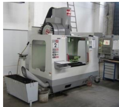
Рис. 1. Вертикально-фрезерный обрабатывающий центр HAAS модели VF-2S
