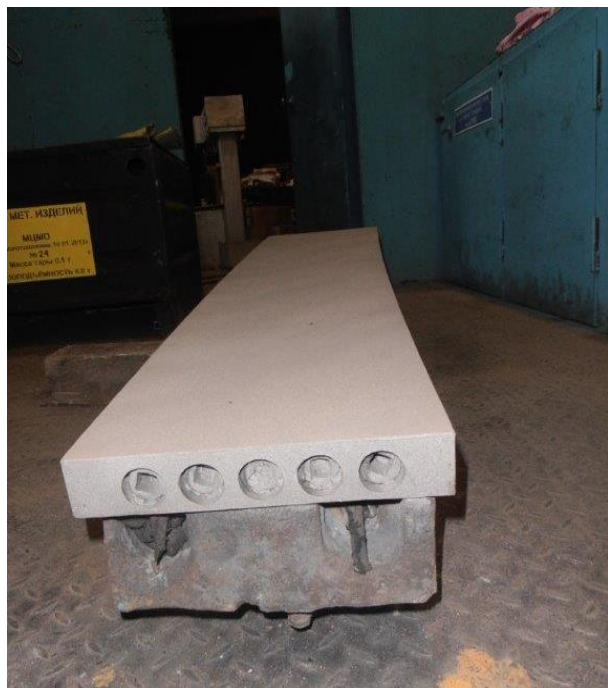
Рис.3. Стенка кристаллизатора после напыления хромоникелевого покрытия
