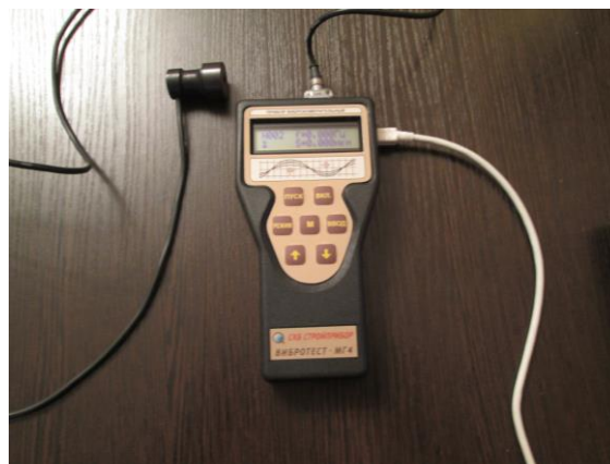
Рис. 3. Виброметр «Вибротест-МГ4.01» для определения параметров вибраций
