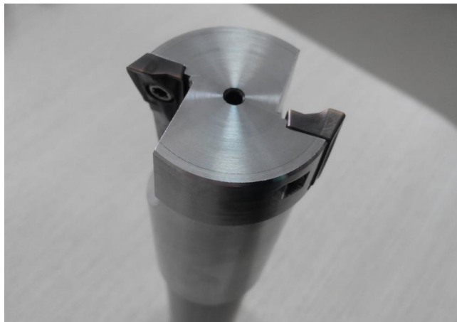
Рис.1. Корпусная двухперая фреза производства ГК "НПК ХАЛТЕК" с карманами под пластину AXMT 170508 PEER-E ACP300 компании SUMITOMO
