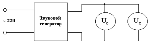
Рис. 3. Схема поверки вольтметра на высоких частотах
