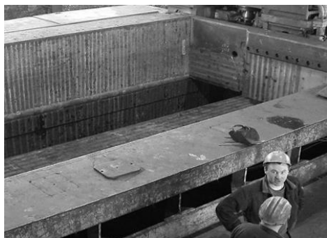
Рис. 5. Бункер, футерованный листами с плазменной закалкой
