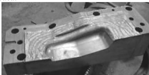
Рис. 6. Фрагмент разрезного штампа после плазменной закалки
