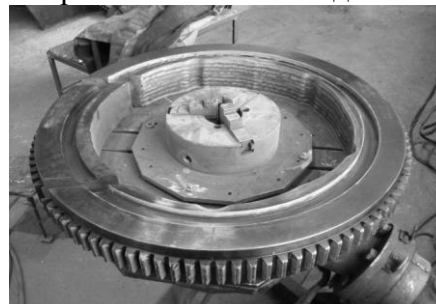
Рис. 2. Разрезная зубчатая муфта с плазменной закалкой
