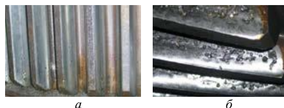
Рис. 6. Превышение предела выносливости материала приводит к износу рабочей поверхности: а – начальная стадия; б – предельное состояние
