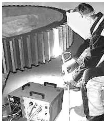
Рис. 1. Закалка установкой УДГЗ-200
