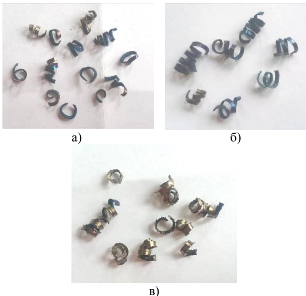
Рис. 1. Результаты влияния переднего угла резца на вид стружки: а) 1 группа ( +5^\circ ); б) 2 группа ( 0^\circ ); г) 3 группа ( -5^\circ )
