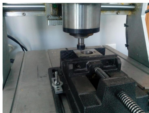
Рис.6. Гравирование в масляной пленке
