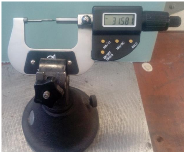
Рис. 3. Измерение длины гравера на микрометре
