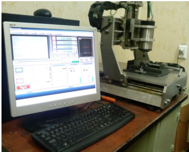
Рис. 2. Фрезерно-гравировальный станок Lynx 3D-020
