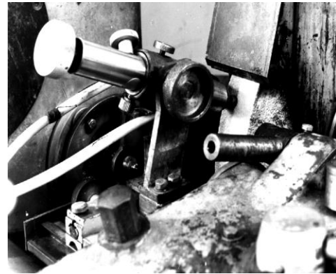
Рис. 2. Устройство для профилографирования инструмента
