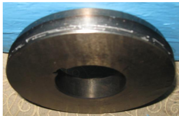
Рис. 1. Резьбовые ролики с выраженными повреждениями и следами износа на рабочей поверхности
