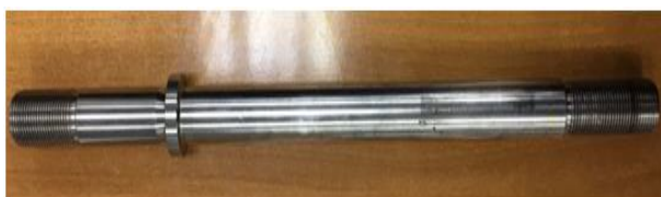
Рис. 1. Внешний вид штока компрессора
