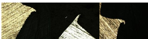
Рис.2. Типичные формы заусенцев, образующихся у деталей приборов РЭА
