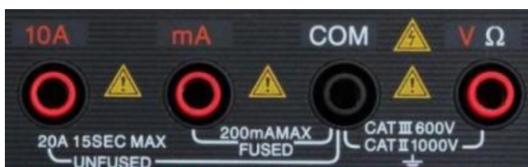
Рис. 7 — Измерительные входы мультиметра
