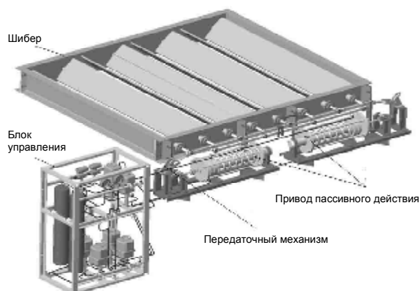
Рис. 4. Регулирующее устройство СПОТ ПГ с воздушным ТК [3]
