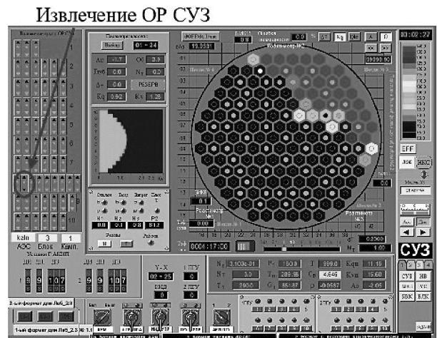
Рис. 3. Неконтролируемое извлечение наиболее ценного ОР СУЗ из активной зоны
