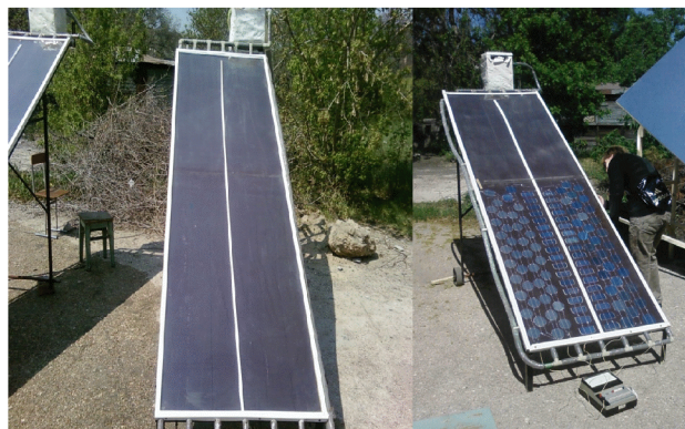
Рис. 2. Тепловая (слева) и теплофотоэлектрическая (справа) солнечные установки
