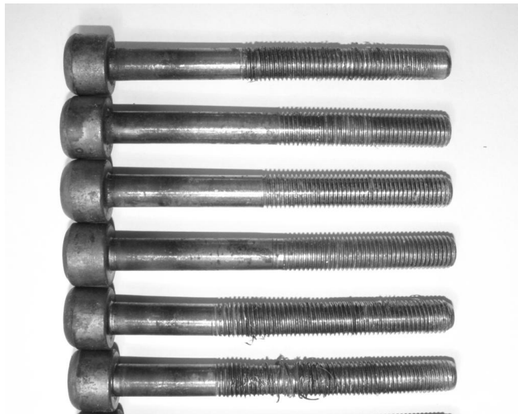
Рис. 2 – Примеры видов брака наружной резьбы, вызванных различными отказами в ходе резьбонакатывания
