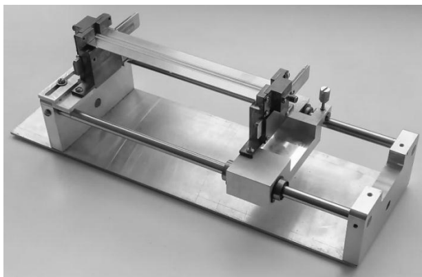
Рис. 4. Контактное устройство с полосковой линией длиной 120мм.
