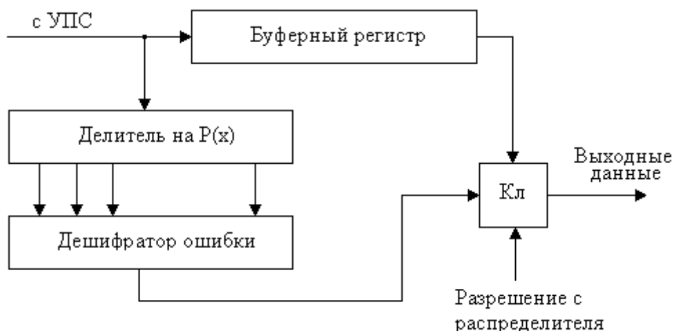
Рисунок 2.2 – Структурная схема декодера циклического кода
