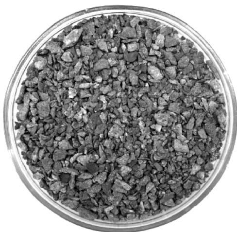
Рис. 1. Гранулы дробленой урансодержащей руды до микробиологического выщелачивания.
