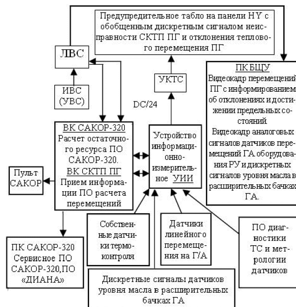
Рис. 2. Принципиальная схема функциональной структуры САКОР-320.
