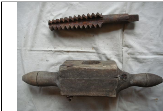
Рис. 1.9. Древние метчики и плашки для нарезания резьб
