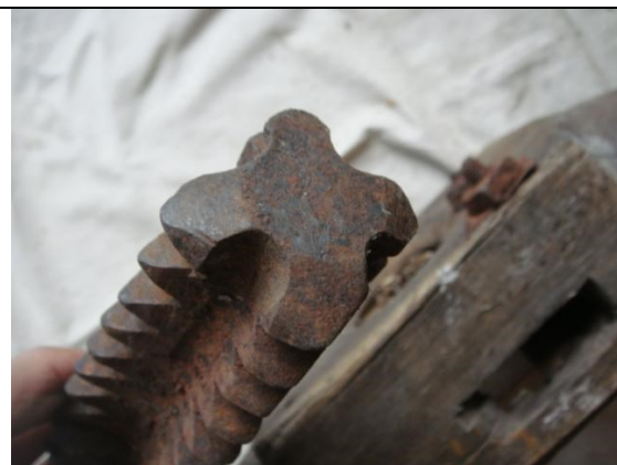
Рис. 1.9. Древние метчики и плашки для нарезания резьб
