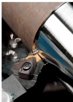
Рис. 2.5. Обработка заготовки: проходным резцом (а); расточным резцом (б)
