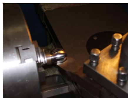
Рис. 2.7. Обработка заготовки: подрезным резцом (а); фасонным резцом (б)
