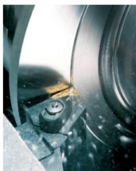
Рис. 2.7. Обработка заготовки: подрезным резцом (а); фасонным резцом (б)
