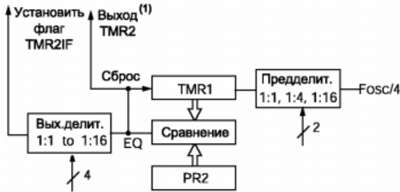
Рис. 5.6 — Структурная схема модуля TMR2
