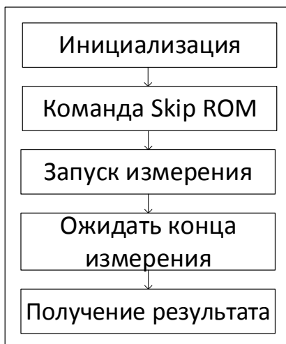
Рис.7.5 — Алгоритм взаимодействия с датчиком для считывания температуры
