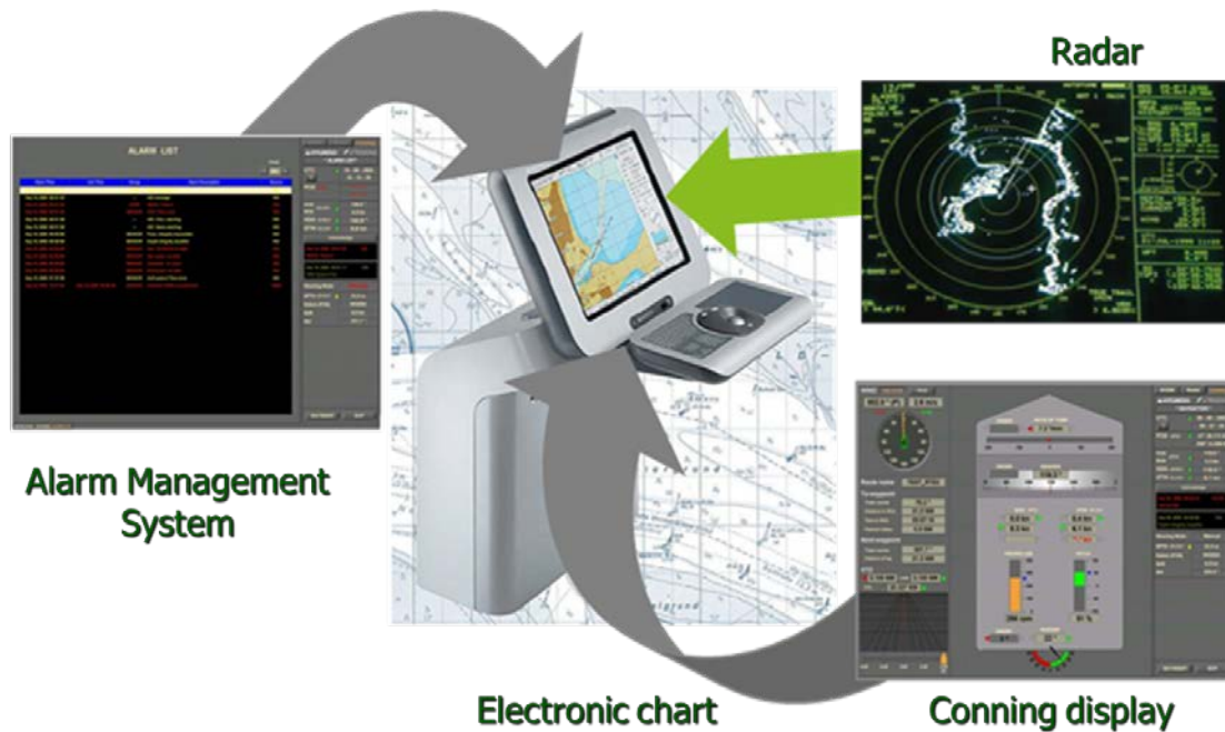
Рисунок 1.4 – Представление информации на мостике с помощью multifunctional workstations
