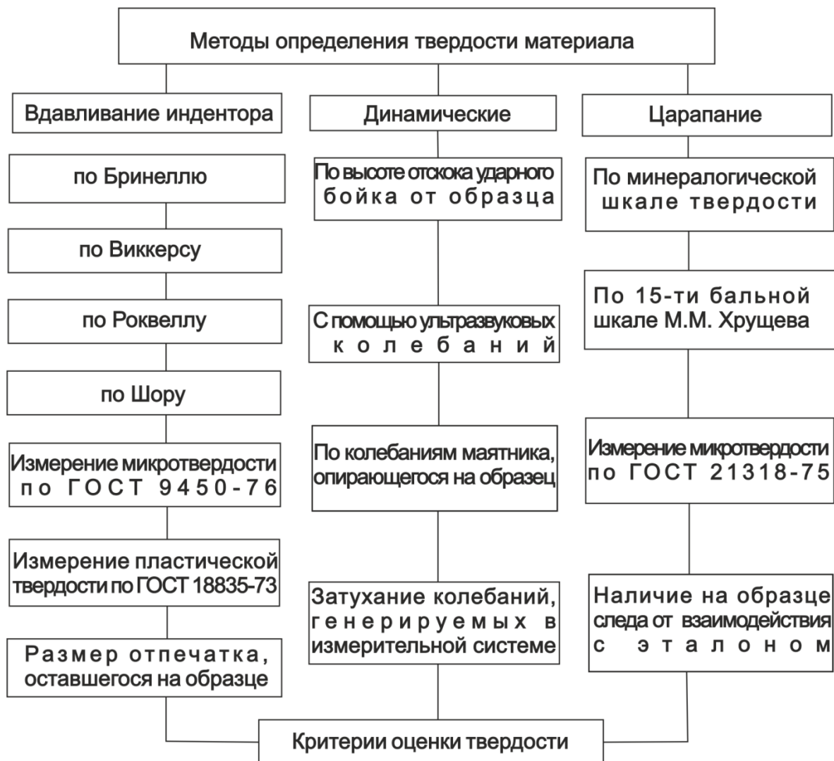
Рис. 1 – Классификация основных методов определения твердости
