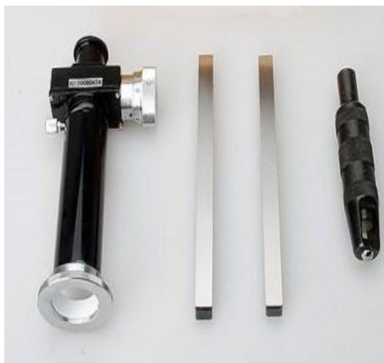
а) Рис. 5 – Схема испытания твердости по методу Поляди: а) общий твердомера; б) схема испытания
