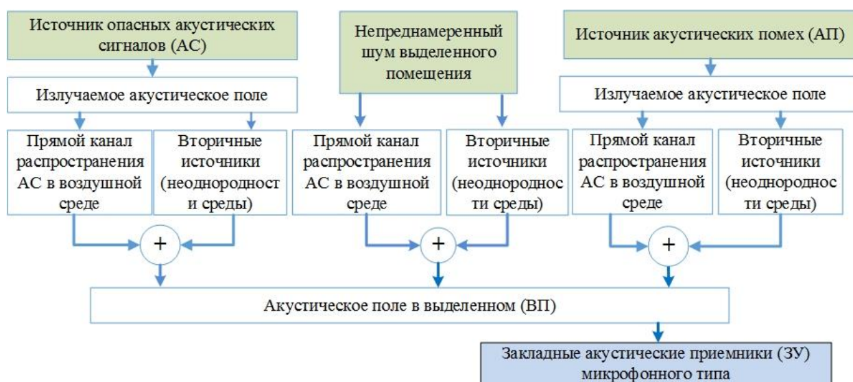
Рис. П.6 — Реальная модель АКУРИ 1 с применением активных помех для лаборатории I-B-410
