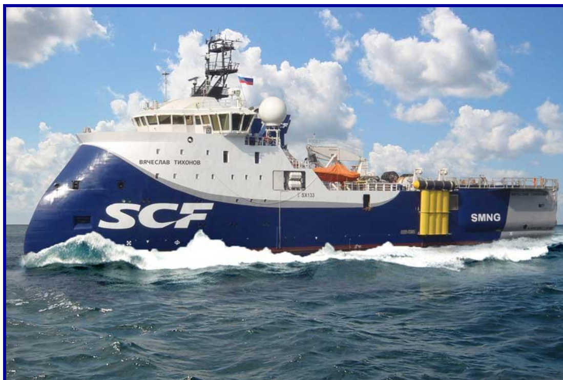
Рис. 168. 2011 г. Вячеслав Тихонов (Vyacheslav Tikhonov). Тип: судно геофизической разведки. Ледовый класс: ICE – 1А. Дедвейт: 2 053 т. Высокотехнологичное X-bow 3D научно-исследовательское судно морской геофизической разведки, предназначенное для бесперебойной работы в условиях низких температур арктических морей
