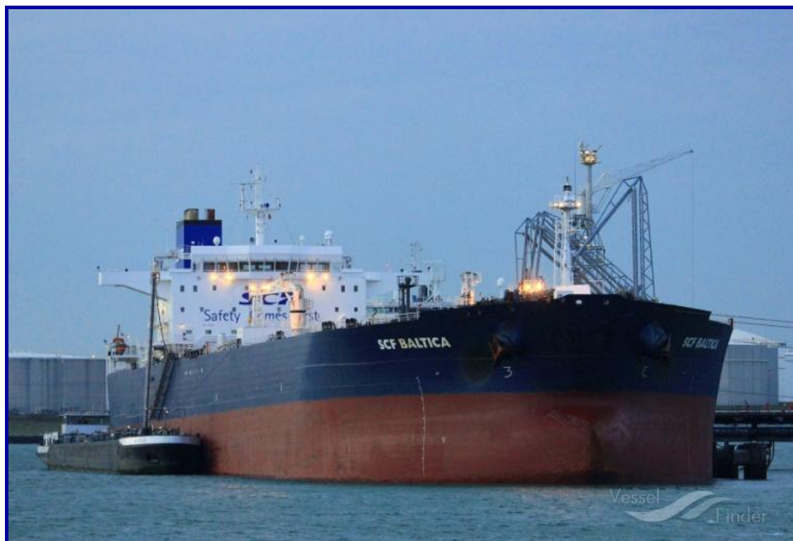
Рис. 161. 2005 г. СКФ Балтика (SCF Baltica). Тип: нефтеналивной танкер «Афрамекс». Ледовый класс: ICE – 1А. Super Дедвейт: 114 546 т. Танкер «СКФ Балтика» стал первым в истории мирового судоходства крупнотоннажным судном, совершившим переход по трассам Северного морского пути от мыса Желания (о. Новая Земля) до мыса Дежнева. Преодолев около 2 500 морских миль, танкер прошел по традиционным маршрутам СМП
