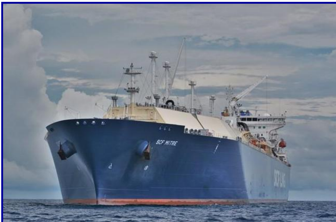
Рис. 172. 2015 г. СКФ Митре (SCF Mitre). Тип: танкер-газовоз «Атлантимакс». Усиленный ледовый класс: ICE-2. Грузовместимость: 170 200 м 3 . В 2015 году завершилось строительство газозовозов "СКФ Мелампус" и "СКФ Митре", заказанных для работы по долгосрочному контракту с Royal Dutch Shell. Ультрасовременные газозовозы типоразмера Atlanticmax (грузовместимость 170 200 куб. м) обладают комплексом для работы в сложных климатических условиях. Суда способны осуществлять перевозку газа с большинства существующих отгрузочных терминалов
