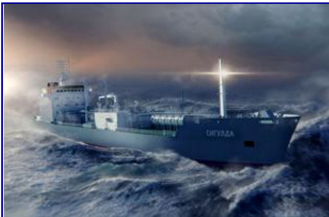
Рис. 157. 1989 г. Сигулда (Sigulda). Тип: танкер-газовоз СНГ. Ледовый класс: L3. Грузовместимость: 15 096 м 3 . Первый газовоз, построенный по заказу СКФ, для перевозки сжиженного нефтяного газа
