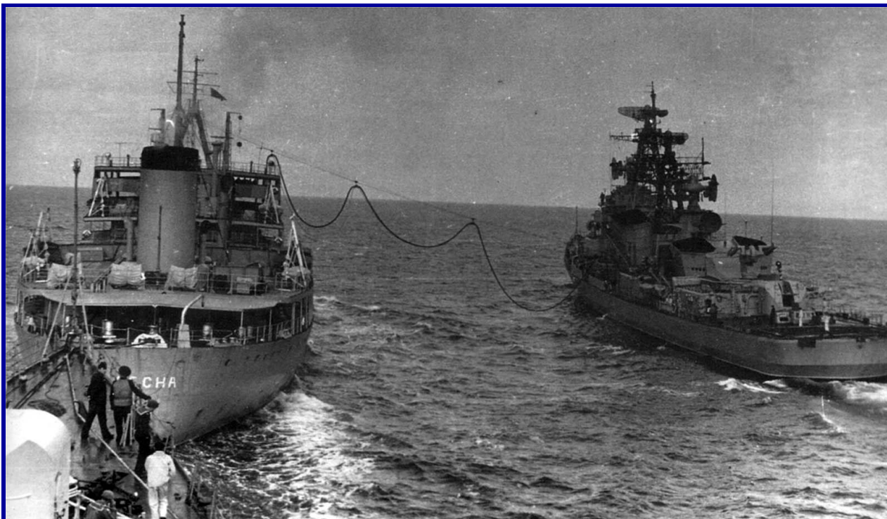
Рис. 151в. Большой противолодочный корабль «Сообразительный» Черноморского флота принимает топливо с танкера «Десна» (тип «Казбек»)
