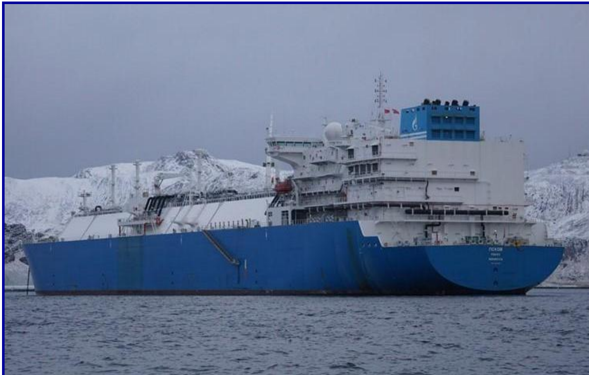
Рис. 171. 2014 г. Псков (Pskov). Тип: танкер-газовоз «Атлантимакс». Ледовый класс: ICE-2. Грузовместимость: 170 200 м 3 . Ультрасовременный газовоз СПГ мембранного типа, заказанный в интересах ОАО «Газпром». Газовоз способен осуществлять транспортировку сжиженного природного газа со всех существующих в мире терминалов СПГ в режиме круглогодичной навигации. В 2014 году в состав флота также вошел еще один газовоз серии - «Великий Новгород»
