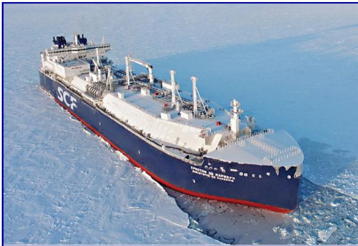
Рис. 176. Движение танкера-газовоза «Кристоф де Маржери» во льдах – кормой вперёд
