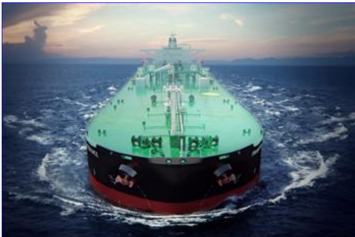
Рис. 158. 1991 г. Тромсо Конфиденс (Tromso Confidence) Тип: нефтеналивной танкер «Суэцмакс». Дедвейт: 154 970 т. Один из первых в составе отечественного флота танкеров типа «Суэцмакс» с двойным корпусом из высокопрочной стали, предназначенный для транспортировки сырой нефти
