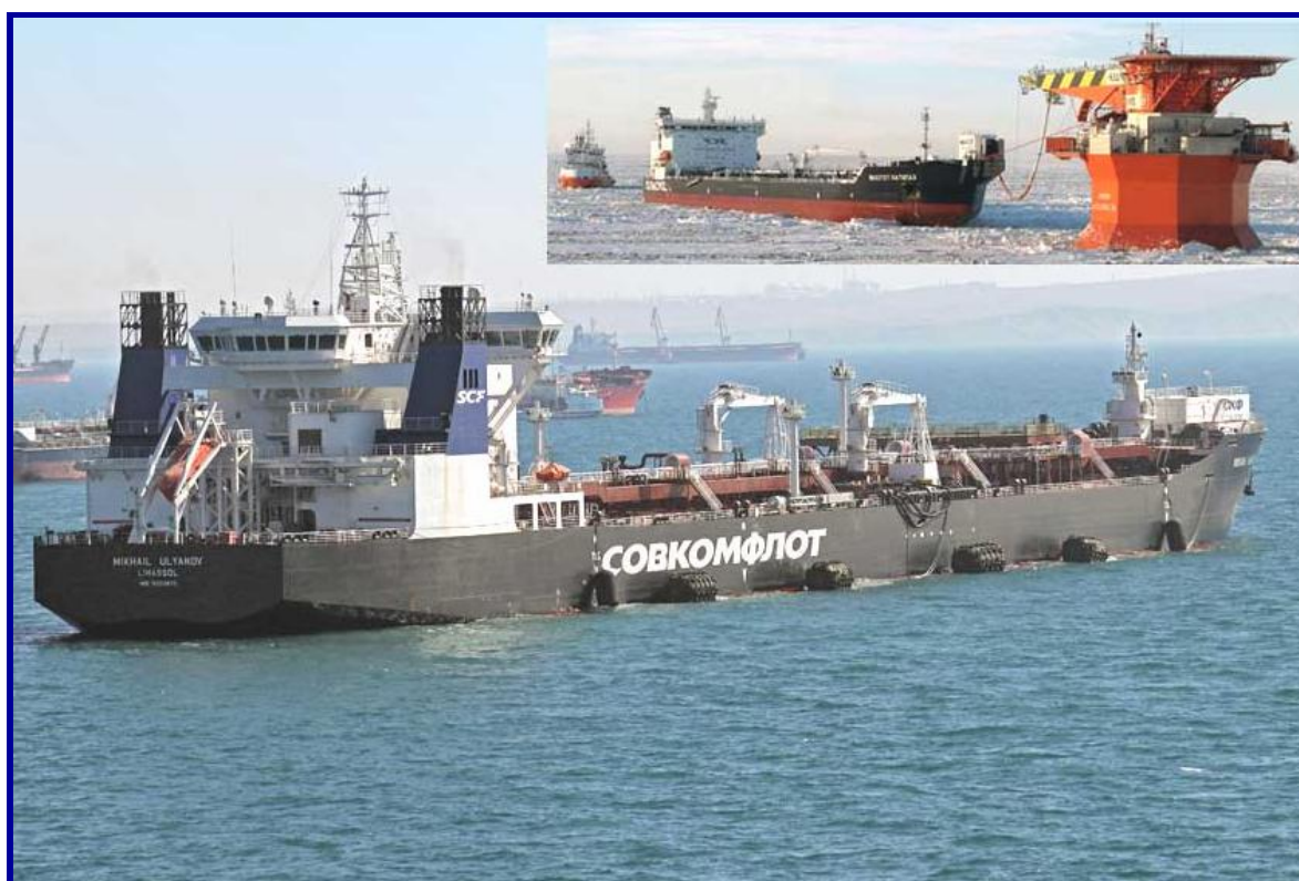
Рис. 167. 2010 г. Кирилл Лавров (Kirill Lavrov) Тип: челночный танкер «Панамакс». Ледовый класс: ARC6. Дедвейт: 70 053 т. Арктический челночный танкер усиленного ледового класса, предназначенный для перевозки нефти с морской ледостойкой платформы «Приразломная» (вверху снимка). Крупнейшее судно, созданное российскими корабелями на «Адмиралтейских верфях» в Санкт-Петербурге. Один из крупнейших в мире танкеров, построенных на наклонном стапеле (спусковая масса корпуса судна – около 25 тысяч тонн). В эту серию судов также входит танкер «Михаил Ульянов»
