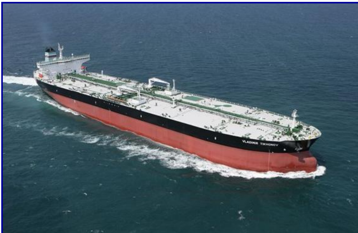
Рис. 163. 2006 г. Владимир Тихонов (Vladimir Tikhonov). Тип: нефтеналивной танкер «Суцэмакс». Ледовый класс: ICE – 1А. Дедвейт: 162 362 т. Танкер типа «Суцэмакс» с высоким ледовым классом, предназначенный для транспортировки сырой нефти из портов Северной Балтики в условиях круглогодичной навигации. В августе 2011 года танкер доставил партию газового конденсата из Мурманска в Маптапхут (Таиланд), освоив новый глубоководный маршрут Севморпути севернее архипелага Новосибирских островов, и стал самым большим танкером, когда – либо проходившим по трассам СМП
