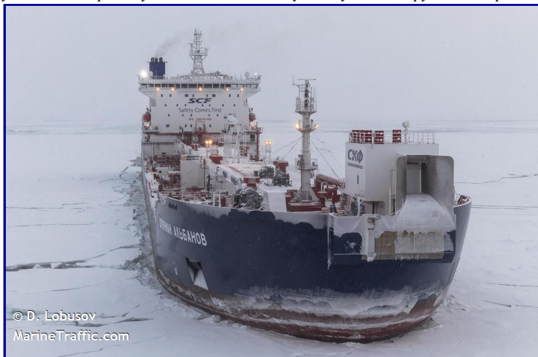
Рис. 173. 2016 г. Штурман Альбанов (Shturman Albanov). Тип: челночный танкер MR. Ледовый класс: ARC7. Дедвейт: 41 454,5 т. «Штурман Альбанов» – головное судно серии арктических челночных танкеров, заказанных группой компаний «Совкомфлот» в рамках долгосрочного контракта с компанией «Газпром нефть» и предназначенных для доставки сырой нефти с полуострова Ямал (ЯНАО) в порт Мурманск в условиях круглогодичной навигации
