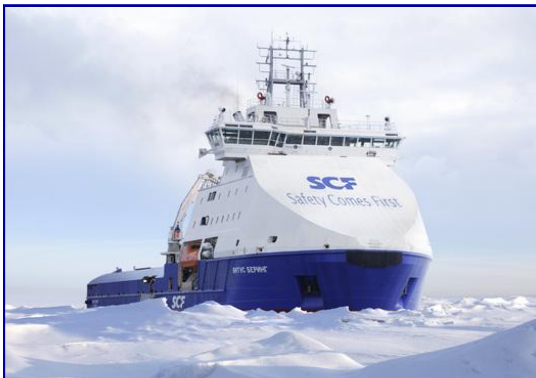
Рис. 169. 2012 г. Витус Беринг (Vitus Bering). Тип: многофункциональное ледокольное судно снабжения. Ледовый класс: ICE – 10. Дедвейт: 3 950 т. Головное судно серии многофункциональных ледокольных судов снабжения, предназначенных для круглогодичного обслуживания нефтедобывающей платформы «Беркут» на шельфе острова Сахалин (проект «Сахалин – 1»). В серию также входит судно «Алексей Чириков». Построен в сотрудничестве с верфью Artech (предприятие ОАО «ОСК») и Выборгским судостроительным заводом
