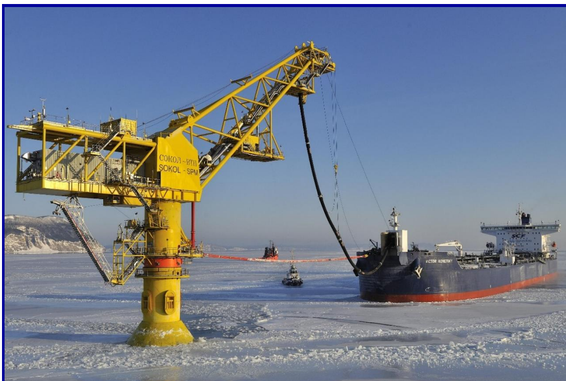
Рис. 162. 2005 г. Виктор Конецкий (Victor Konetsky). Тип: челночный танкер «Афрамекс». Ледовый класс: ICE – 1С. Дедвейт: 101 018 т. Челночный танкер типа «Афрамекс», спроектированный и построенный специально для транспортировки нефти в рамках проекта «Сахалин – 1» в условиях круглогодичной навигации
