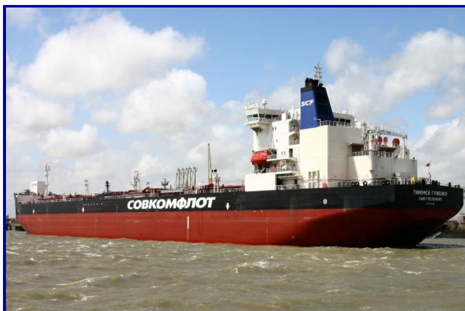
Рис. 165. 2009 г. Тимофей Гуженко (Timofey Guzhenko). Тип: челночный танкер «Панамакс». Ледовый класс: ARC6. Дедвейт: 71 294 т Арктический челночный танкер усиленного ледового класса, предназначенный для круглогодичной транспортировки нефти со стационарного морского ледостойкого отгрузочного причала (СМОЛП) «Варандей» (Баренцево море). Участие Совкомфлота в проекте «Варандей» отмечено премией правительства РФ в области науки и техники 2011 года. Танкер назван в честь выдающегося государственного деятеля Тимофея Борисовича Гуженко (15.02.1918 – 10.08.2008) – 5-го министра морского флота СССР, ставшего одним из основателей компании «Совкомфлот». В эту серию судов также входят танкеры «Василий Динков» и «Капитан Готский»
