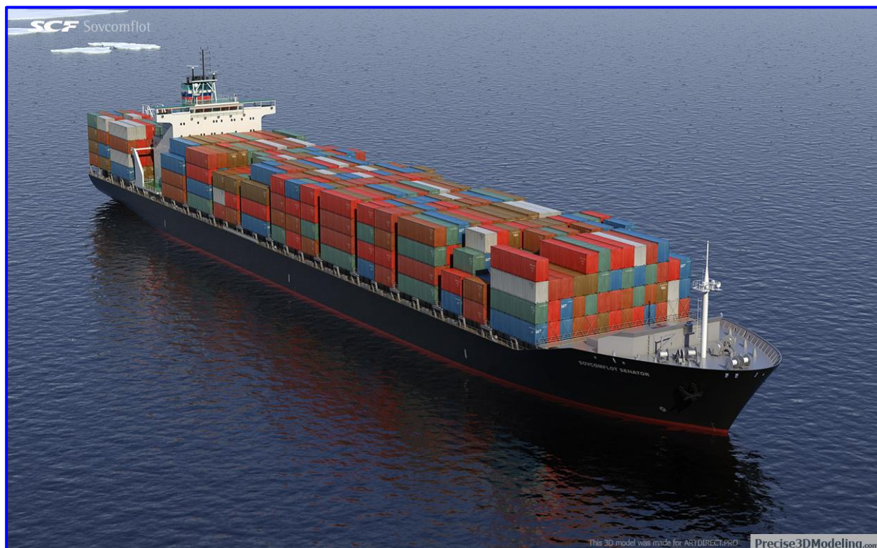
Рис. 159. 1993 г. Совкомфлот Сенатор (Sovkomflot Senator). Тип: контейнеровоз «Панамакс». Ледовый класс: ICE – 1С. Грузовместимость: 3,005 TEU. Контейнеровоз типа «Мегаслот» грузовместимостью 3005 ДФЭ – первое судно такого размера в составе отечественного флота
