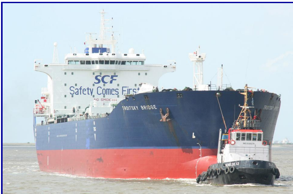
Рис. 160. 2003 г. Троицкий Бридж (Troitsky Bridge). Тип: нефтепродуктовый танкер MR. Ледовый класс: ICE – 1А Дедвейт: 47 199 т. Первый танкер продуктового типа MR, построенный на отечественных верфях («Адмиралтейские верфи», Санкт-Петербург). В период с 2001 по 2008 год на верфи были также построены суда серии – «Тучков Бридж», «Тауэр Бридж», «Торговый Бридж», «Тверской Бридж», «Театральный Бридж», «Таврический Бридж», «Транссиб Бридж»
