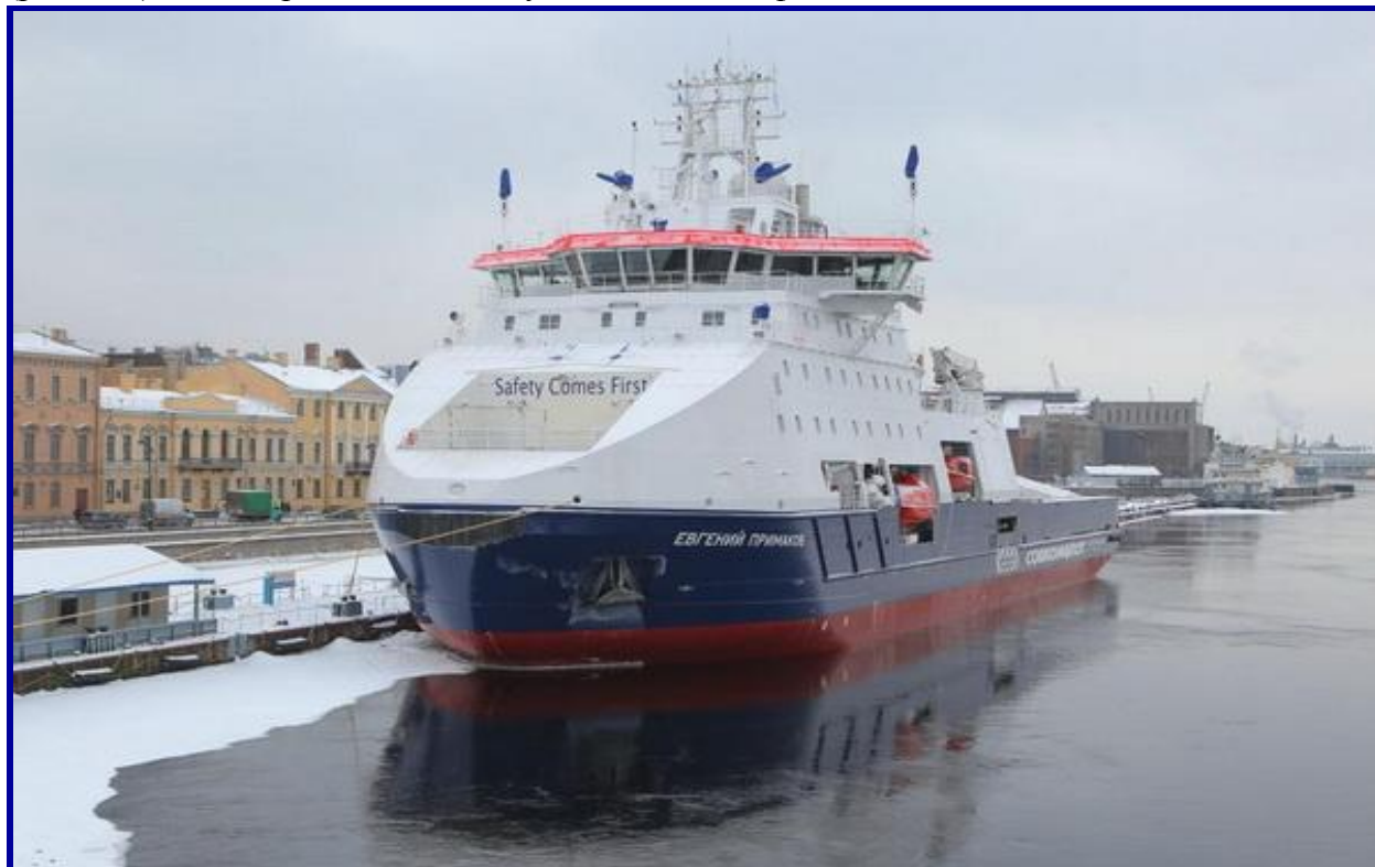
Рис. 185. Многофункциональное судно ледового класса «Евгений Примаков». Судно предназначено для обслуживания буровых платформ в рамках проекта «Сахалин-2»
