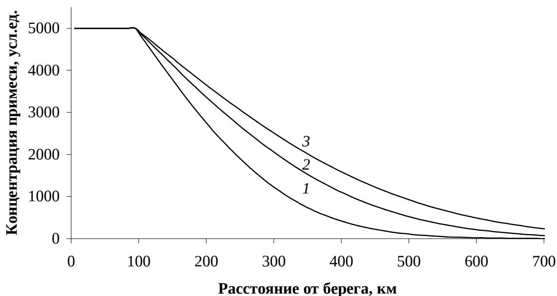
Рис. 6.8. Изменение распределения примеси со временем при фиксированной ее концентрации в струе течения: 1 – 0,5 года, 2 – 1 год, 3 – 1,5 года
