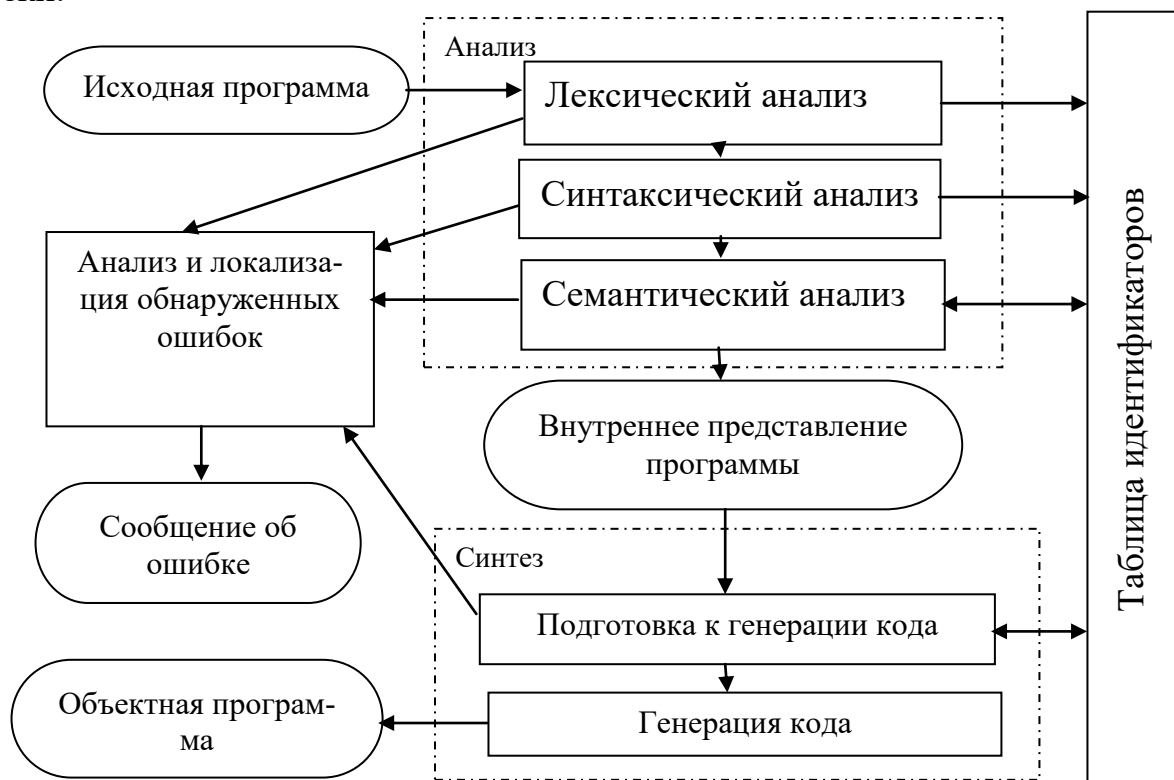
Рисунок 3.1 – Общая схема работы компилятора
