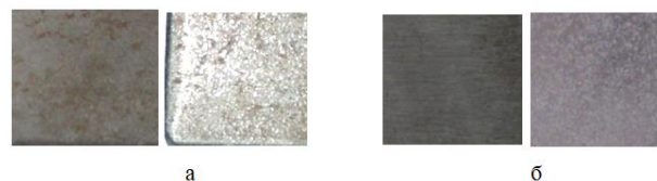
Рис. 1. Образцы для экспериментов: а – сталь 20, покрытая слоем ржавчины до обработки (слева) и после цинкования в условиях вибрационной обработки (справа); б – сталь 3 без ржавчины до обработки (слева) и после цинкования в условиях вибрационной обработки (справа)
