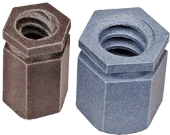
Рис. 1. Внутренние резьбы полученные при формировании деталей аддитивными технологиями
