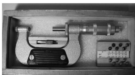
Рис. 6. Резьбовой микрометр тип МВМ50
