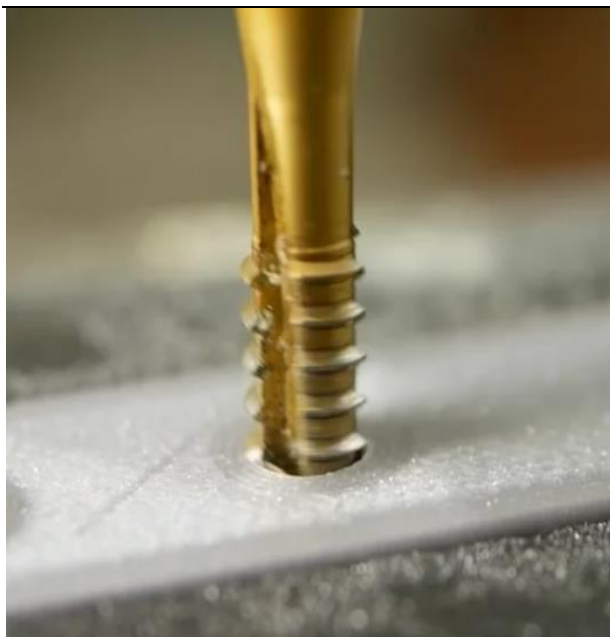
Рис. 2. Нарезание резьбы метчиком в пластмассовой детали, изготовленной аддитивными технологиями
