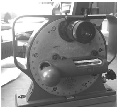
Рис. 8. Квадрант оптический тип КО-10
