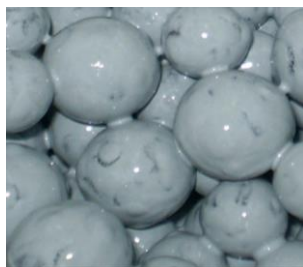
Рис. 4. Стеклянные шары диаметром 5 и 10 мм с поверхностной пленкой рабочего раствора и зернами цинка в местах контакта между собой
