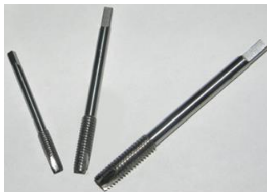
Рис. 2. Конструкции режуще-деформирующих метчиков (РДМ)
