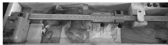
Рис. 4. Общий вид штангенрейсмаса ШР
