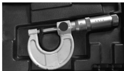
Рис. 5. Общий вид гладкого микрометра МК-25
