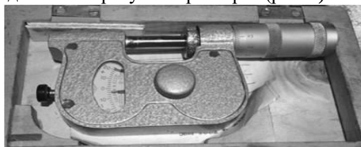
Рис. 7. Рычажный микрометр МР 25
