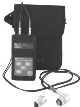
Рис. 11. Толщиномер ультразвуковой тип ТЭМП-УТ1
