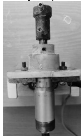
Рис. 2. Приспособление для закрепления заготовки (вид сверху)
