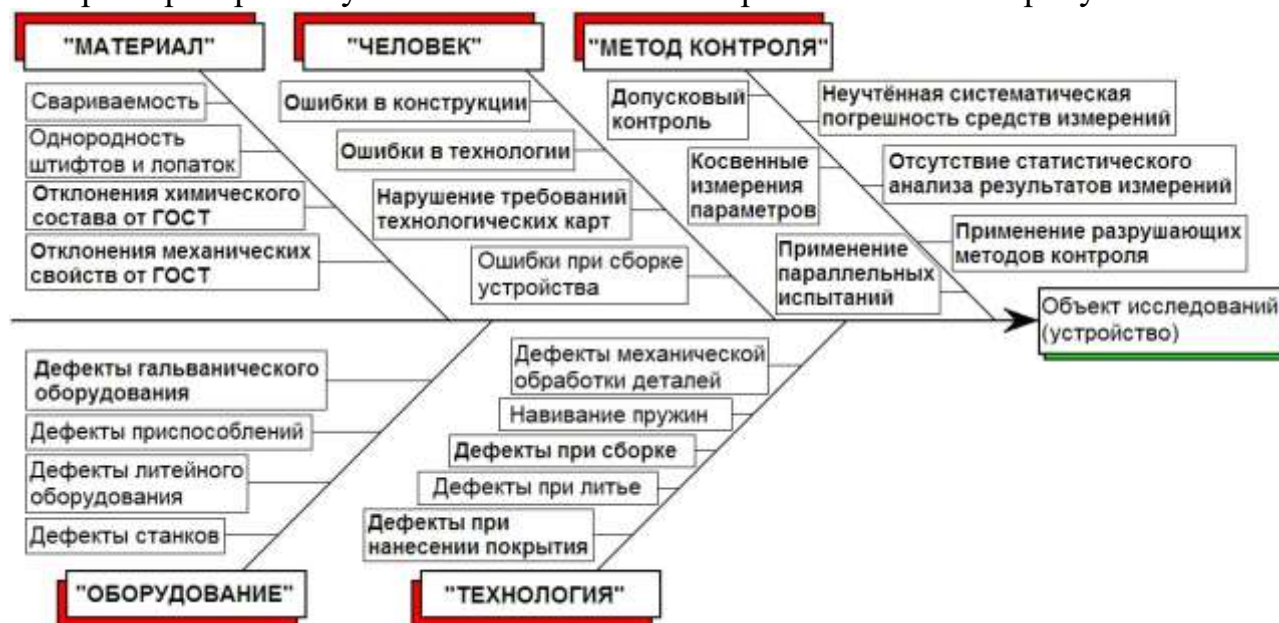
Рис.4. Диаграмма Исикавы для причин отказов устройства
