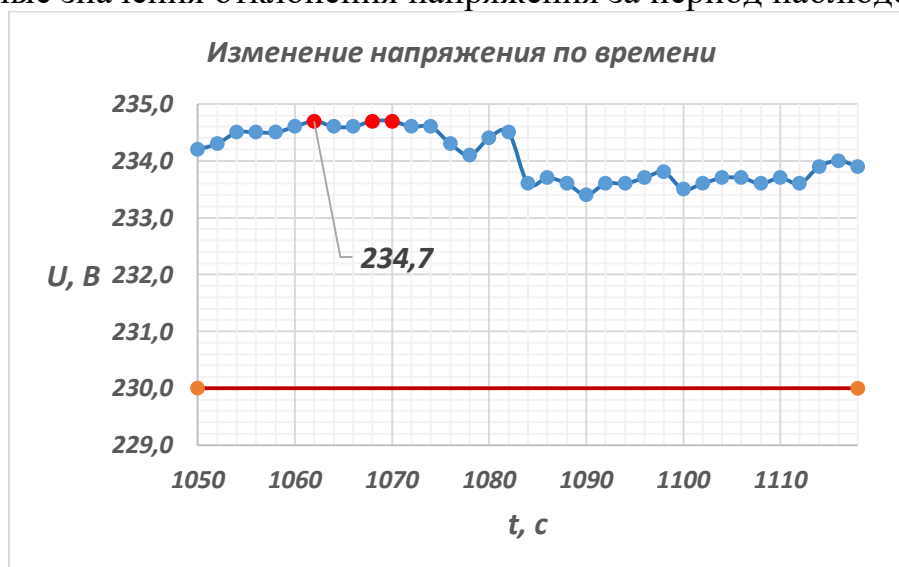
Рис. 1. Изменение напряжения по времени в условиях учебного помещения
