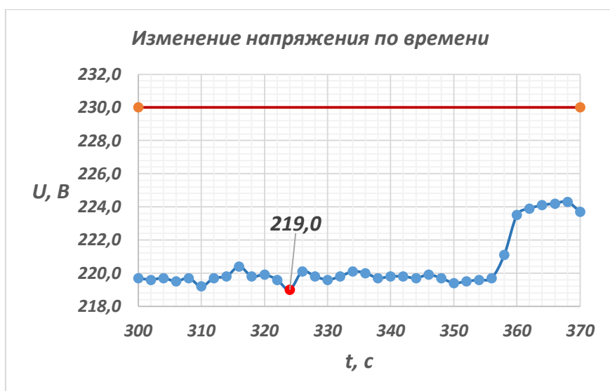
Рис. 2. Изменение напряжения по времени в условиях жилого дома
