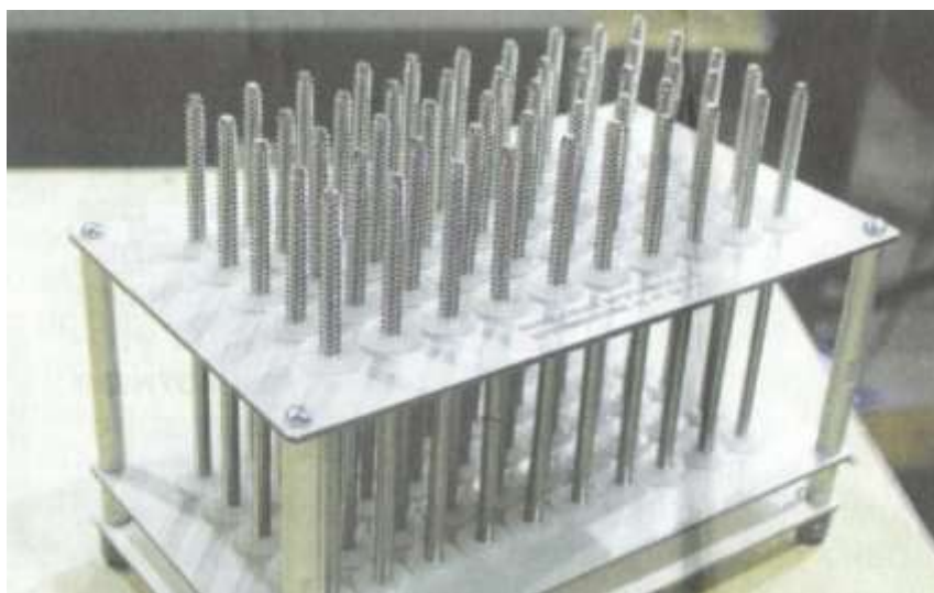
Рис. 6. Модернизированная тара для транспортирования изделий «стержень для остеосинтеза»
