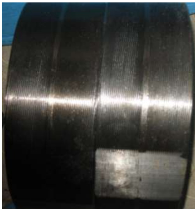
Рис. 1. Комплект РР со следами повреждения рабочей поверхности (на ролике справа)
