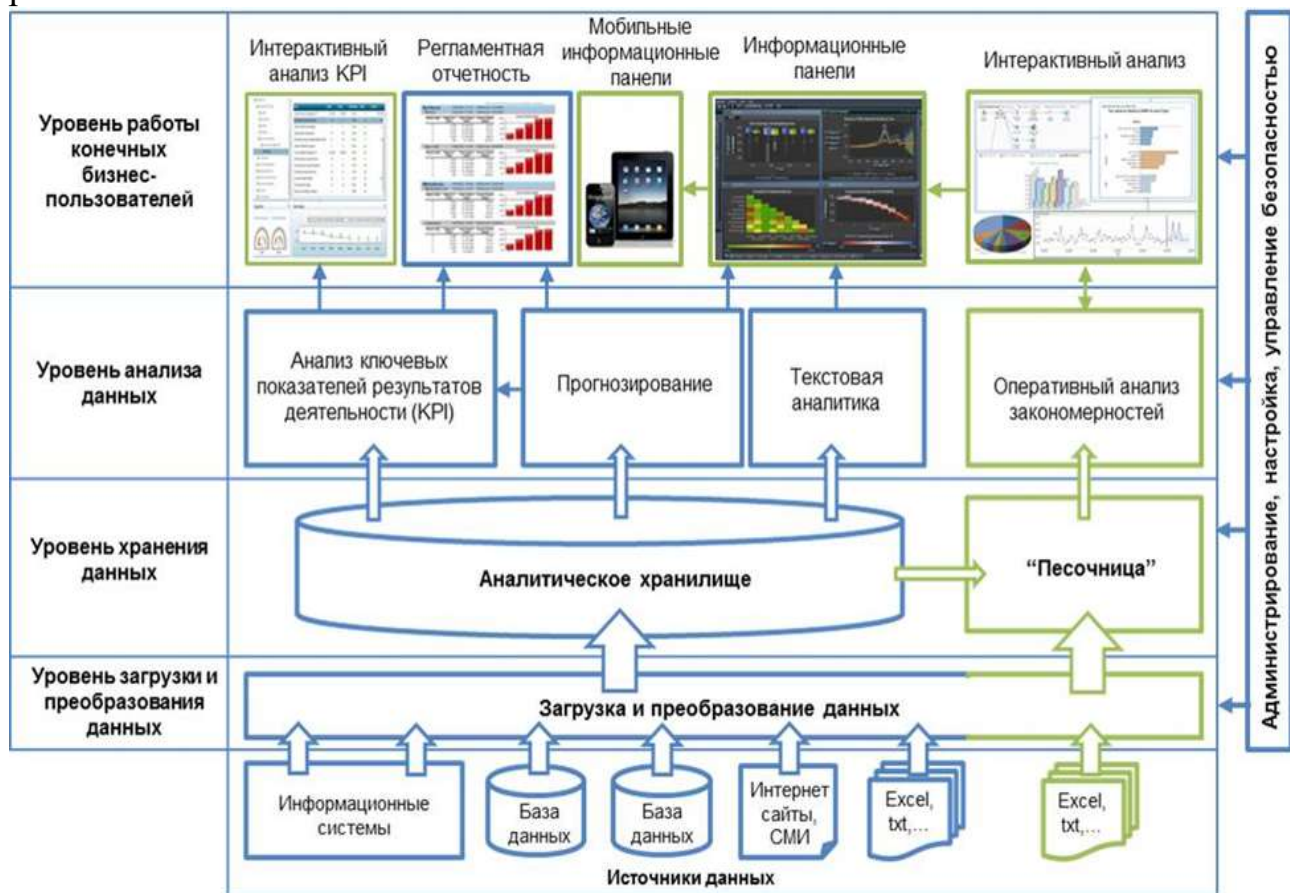
Рис.6. Архитектура аппаратно-программного комплекса ЦКПР
