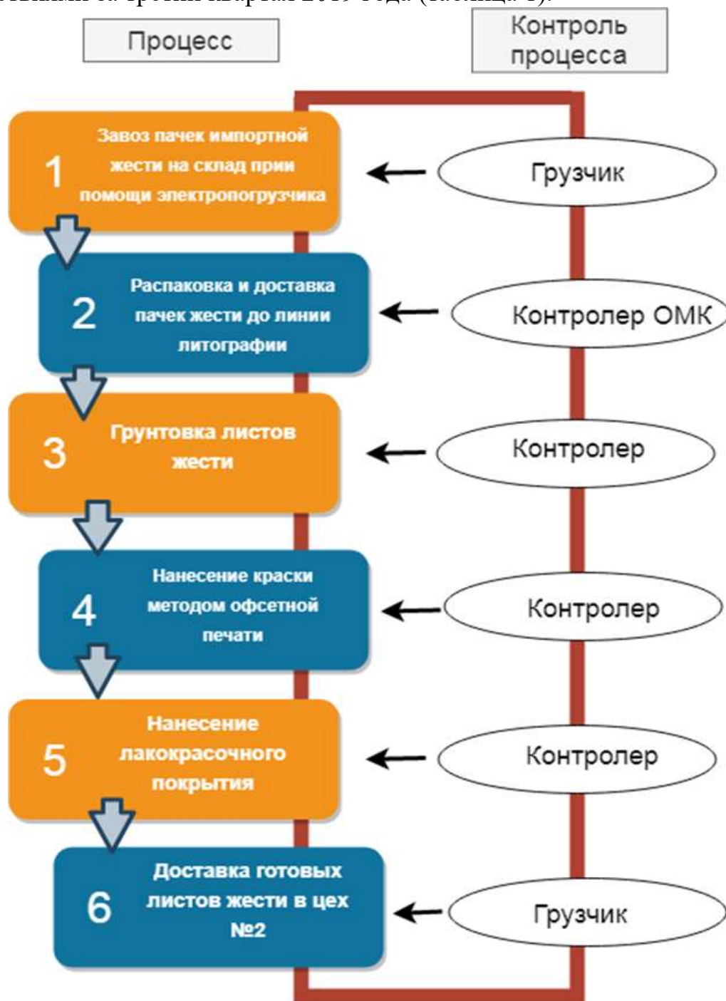
Рис. 1. Процесс литографирования жести
