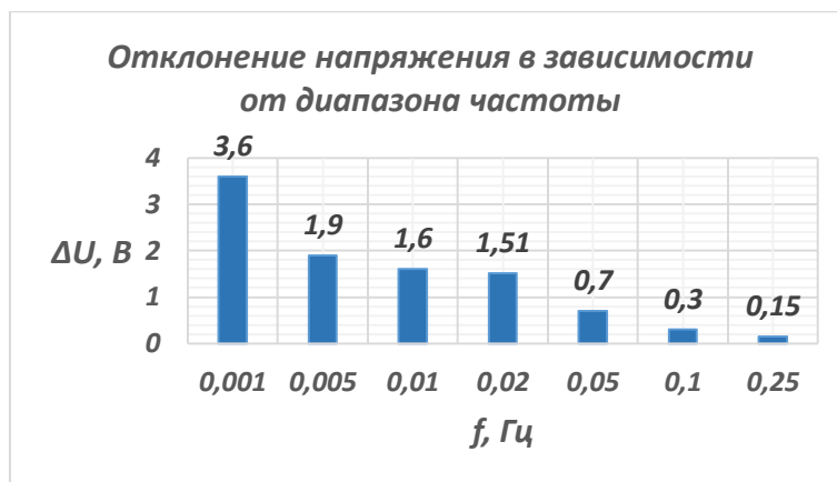
Рис. 4. Отклонение U в зависимости от диапазона f в учебном помещении
