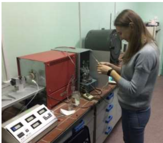
Рис.1 Общий вид установки для определения содержания хлора в целлюлозе
