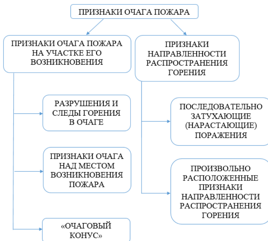
Рис. 3. Признаки очага пожара, подлежащих определению при осмотре визуализированного места происшествия, связанного с пожаром
