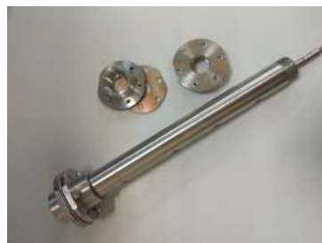
Рис. 2. Вариант исполнения отрезка измерительного зонда в виде коаксиальной линии передачи: а) условное изображение; б) фотография.
