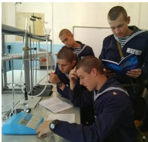
Рисунок 2 – Определение удельной электропроводности коррозионной среды
