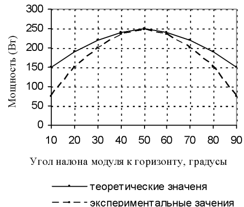
Рис. 12. Зависимость изменения выходной мощности фотоэлектрического модуля PS 250 при изменении угла наклона модуля к горизонту.
