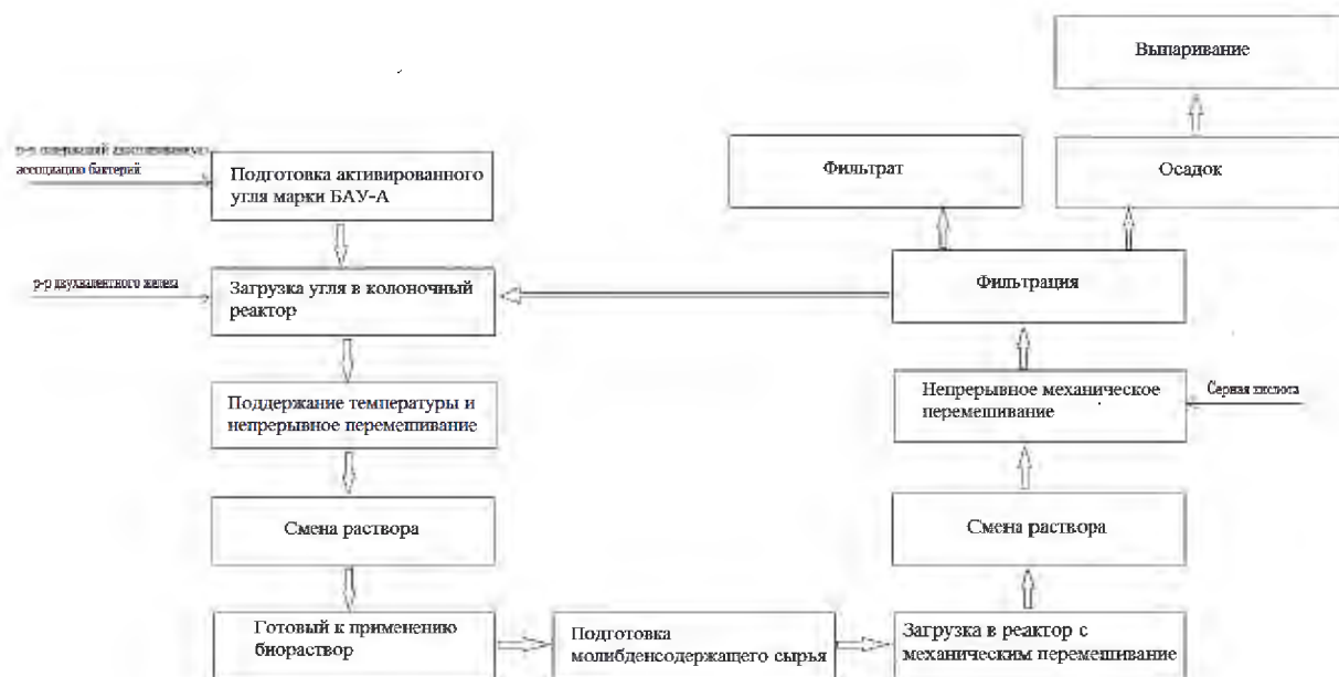
Рис. 1. Операционная схема переработки молибденсодержащих отходов микробиологическим выщелачиванием.
